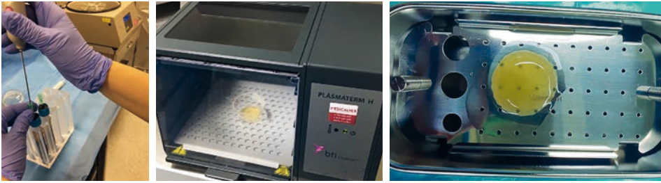
Figura 17. A: Pipeteado, B: Incubación en el Plasmatherm a 37 °C y C: m-PRGF.
