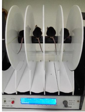
Figura 13. Instrument rotarod utilitzat per a l'avaluació de la coordinació i aprenentatge motor dels ratolins.
