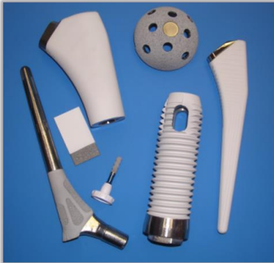
Figura 1.4. Ejemplos de distintas prótesis e implantes metálicos recubiertos con hidroxiapatita [13]
