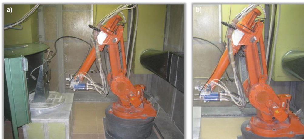
Figura 3.13. a) Interior de la cabina de proyección, b) Antorcha de plasma F4–MB acoplada al robot IRB 1400
