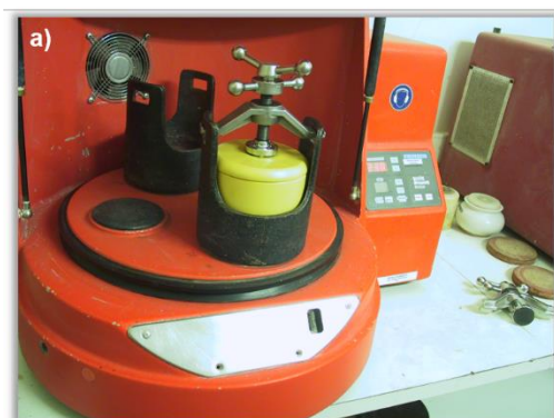
Figura 3.9. a) Molino planetario Pulversitte 5, b) Molino de atrición Dispermat SL. Fuente: Fondo documental de AICE
