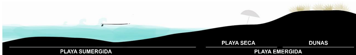
Figura 2.25: Esquema de una playa. Modificado de Sagristà et al. (2017).
