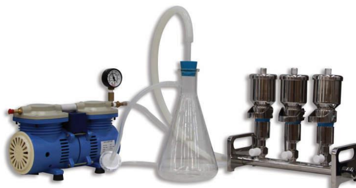
Figura 4.7: Equipo de filtrado de muestras por bomba de vacío. Las muestras se colocan en los cilindros de la derecha de la imagen previa instalación de un papel de filtro. Cuando se activa la bomba se inicia la succión de agua la cual se deposita limpia de sedimento en el envase de la parte central de la imagen, quedando en el filtro el sedimento disuelto que ésta llevaba.
