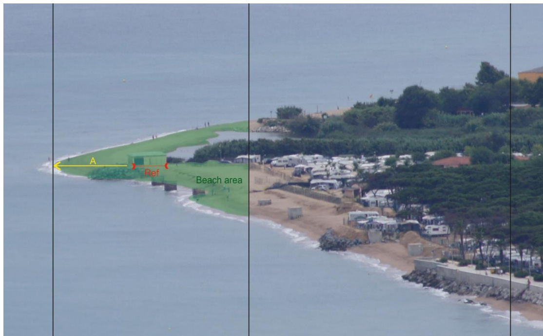
Figura 3.11: Ejemplo de fotografía utilizada para la nueva metodología de seguimiento de la zona sur de s'Abanell. El área verde corresponde a la medida de superficie relativa de arena que es la variable usada
