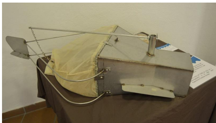
Figura 4.8: Muestreador tipo Helley-Smith usado para el muestreo de la carga de fondo.
