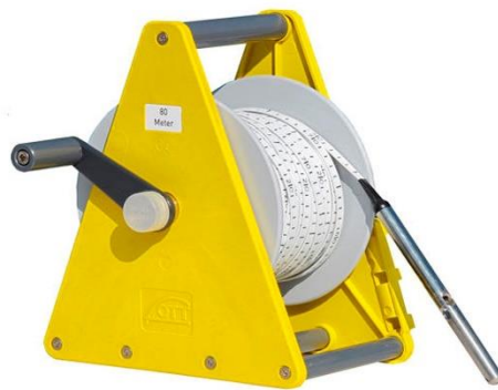
Figura 4.24: Sonda de nivel acústica utilizada para el monitoreo del nivel de agua subterránea de la Baja Tordera.
