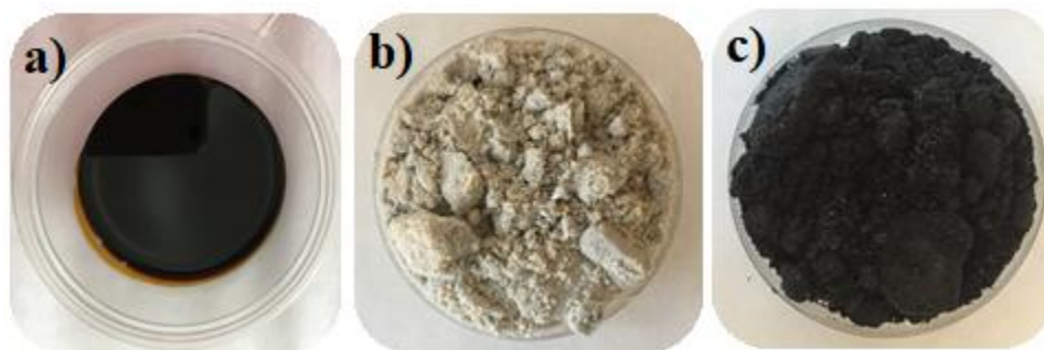
Figura 3.3. a) Melaza de remolacha azucarera. b) Residuo de winterización del aceite. c) Tierras de decoloración
