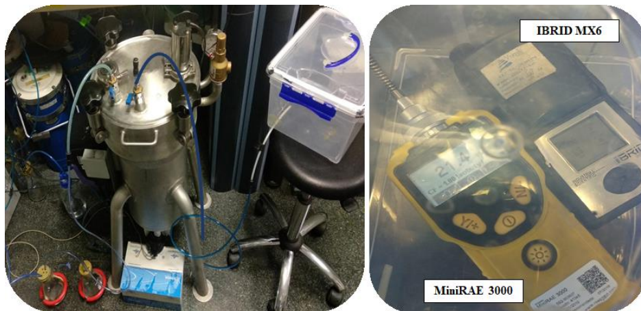
Figura 3.16. Izquierda: Reactor de 22 L acoplado al sistema para medición de emisiones.
