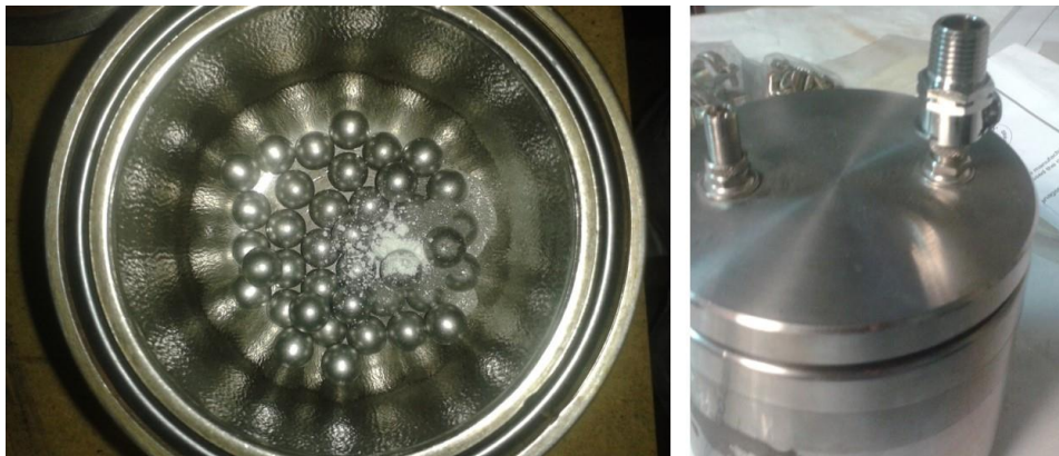
Figura 2.5. Recipientes de molienda, a la izquierda se muestra su interior conteniendo las bolas de molienda, el polvo y la cera EBS (polvo blanco) antes de moler, a la derecha se muestra el exterior del recipiente y el sistema de válvulas en su tapa.
