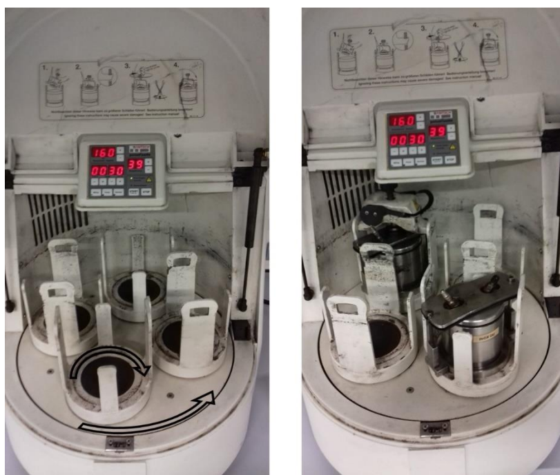
Figura 2.4. Molino planetario de bolas British Pulverisette 5 , a la izquierda se muestra vacío indicando el sentido giratorio de los porta-recipientes y la base del molino, a la derecha se muestra cargado con los recipientes de molienda y su sistema de cierre.
