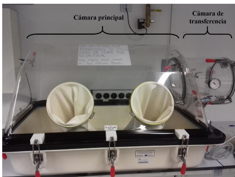
Figura 2.8. Glove box Plast-Labs 818-GB empleada en el proceso de molienda mecánica.
