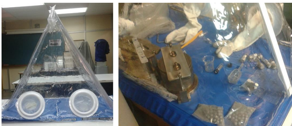
Figura 2.6. Glove box piramidal portátil, a la izquierda vacía, y a la derecha se muestra con los recipientes de molienda y el material para la extracción de polvo molido.
