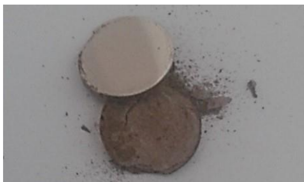
Figura 5.10. Compacto de polvo inicial roto durante el apriete de mordazas del microdurómetro.
