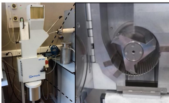
Figura 2.14. Molino Restch, se muestra un inserto con acercamiento de las cuchillas y tamiz.
