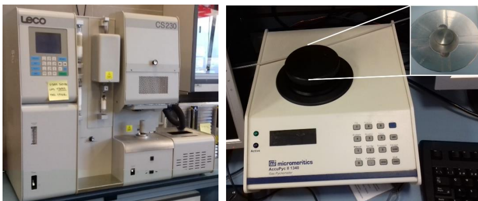
Figura 2.2. Analizador Leco CS230 (izquierda) y picnómetro de helio Micromeritics AccuPyc 1330 (derecha) con un inserto que muestra el recipiente que contiene el polvo.
