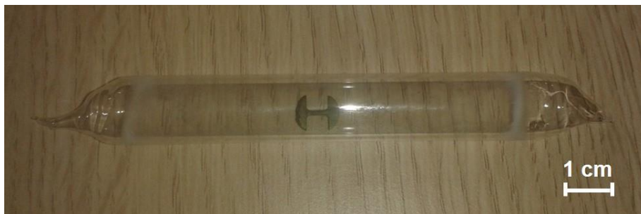
Figura 2.11. Probeta de microtracción encapsulada en tubo de cuarzo con atmósfera de argón para su tratamiento térmico.
