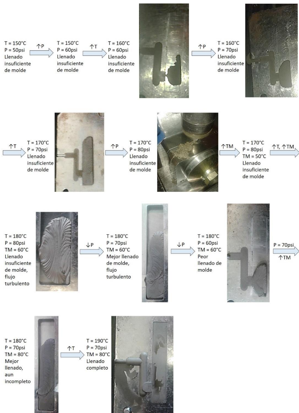
Figura 6.9. Secuencia seguida durante el proceso de inyección de la mezcla fina con 64% de carga metálica para encontrar los parámetros de inyección óptimos. Donde T, P y TM denotan temperatura y presión de inyección y temperatura del molde, respectivamente.
