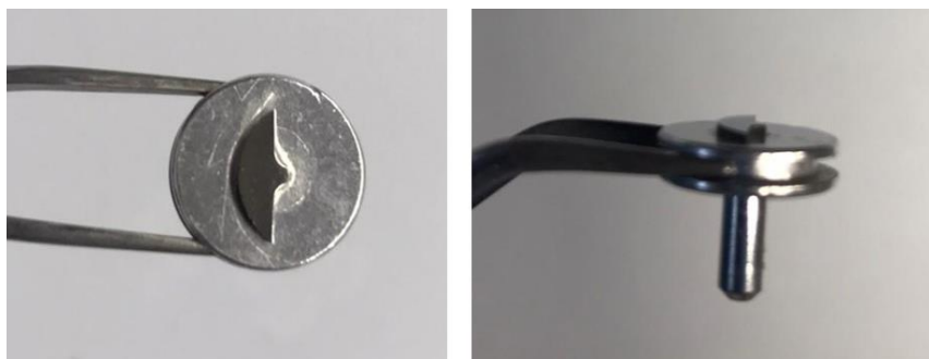
Figura 2.26. Muestra preparada para EBSD, con recubrimiento de plata.
