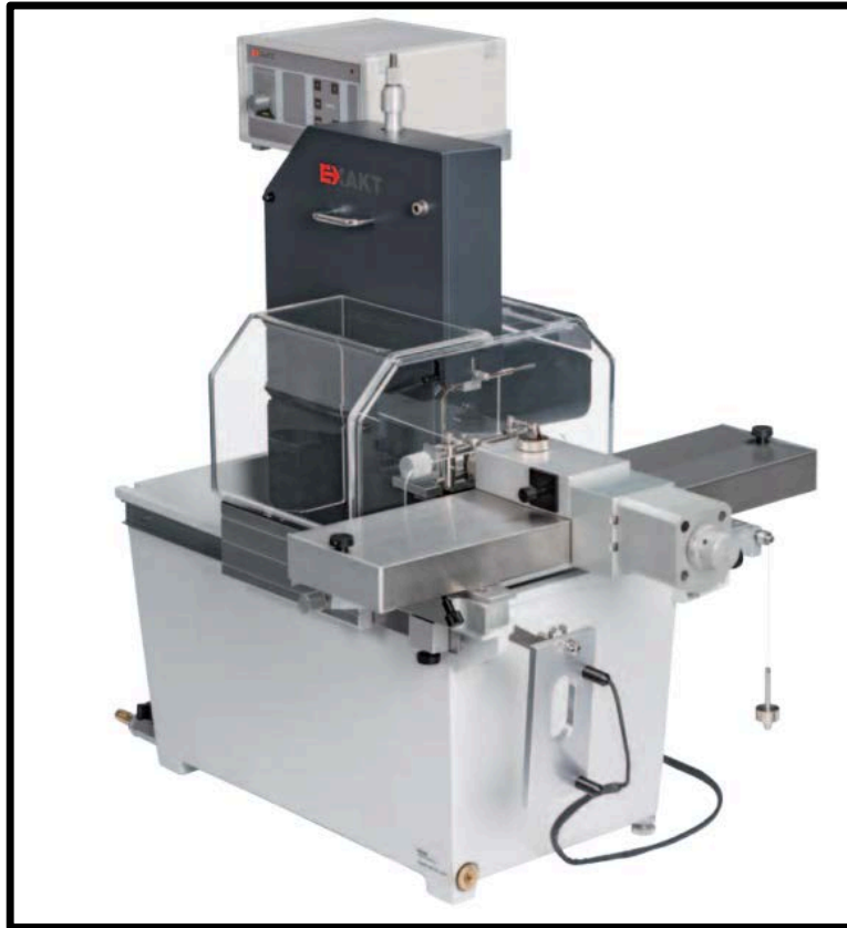
Figura 39. Sierra de diamante de alta precisión Exakt 300® (EXAKT Vertriebs, Alemania).
