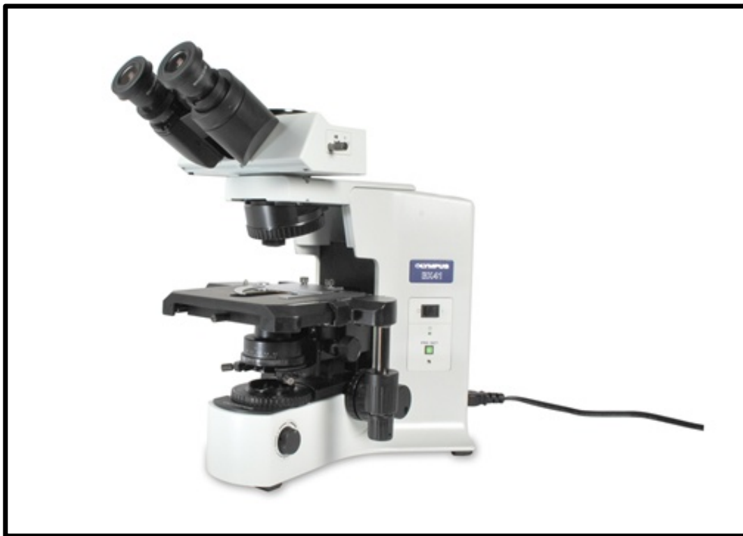
Figura 43. Microscopio óptico Olympus® BX41 usado para observar las muestras histológicas de los fémures de rata.
