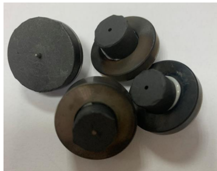
Figura 4.3.35. Ensayo TiIN3.2: muestras con el sombrero de grafito enganchado al vidrio debido a un exceso de peso.
