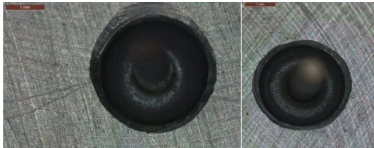
Figura 4.3.19. Imágenes de microscopio óptico del ensayo Al2828.8, donde la imagen izquierda corresponde a la parte superior de la muestra, mientras que la imagen derecha a la parte inferior, después de realizar el sellado.
