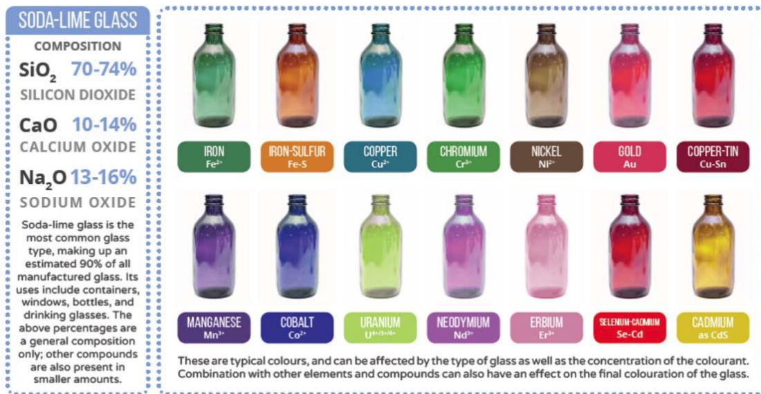
Figura 1.3.5. Color del vidrio en función del óxido metálico. [COM15]
