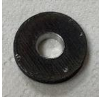
Figura 4.4.10. Muestra de acero inoxidable 316 fabricada por MEAM y con el diámetro interior pulido.
