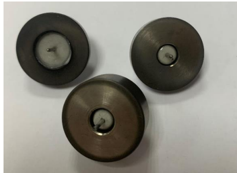
Figura 4.3.34. Ensayo TiIN3.2: muestras selladas de titanio y vidrio IN3 con menisco negativo en la unión.
