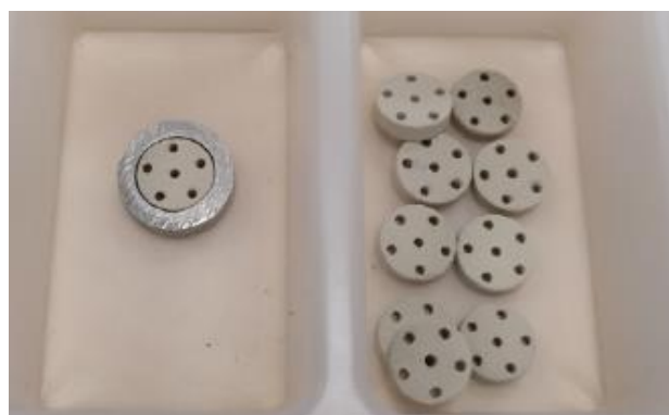
Figura 4.3.3. Preformas de vidrio MLT16 antes de realizar el sellado
