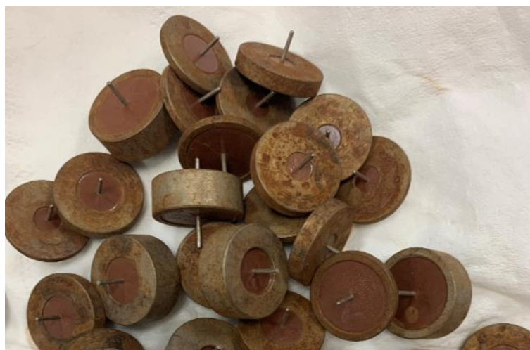
Figura 4.2.37. Muestras de FBK (acero de bajo carbono-BO2-Kovar®) después de realizar el ensayo de ciclo de temperatura
