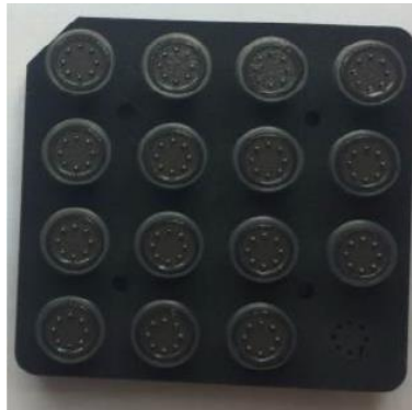
Figura 4.3.23. Muestras de vidrio MLT20 con titanio selladas en horno continuo a 800°C y atmósfera de N 2 / H 2 .
