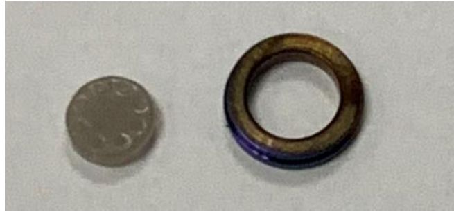
Figura 4.3.27. Resultado del ensayo Ti19.1 realizado a 700°C en atmósfera de argón 5.0.
