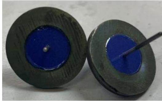
Figura 4.4.16. Muestras selladas con bases de acero inoxidable 316 fabricado mediante tecnología MEAM, vidrio SO5 y pasador de Alloy52
