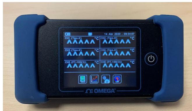
Figura 4.2.35. Equipo de registro de Temperatura
