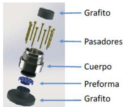
Figura 1.2.4. Esquema de montaje de las piezas
