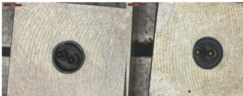
Figura 4.3.13. Muestra del ensayo Al2758.10 con unión hermética después de realizar el sellado, pero menisco negativo entre vidrio y base.
