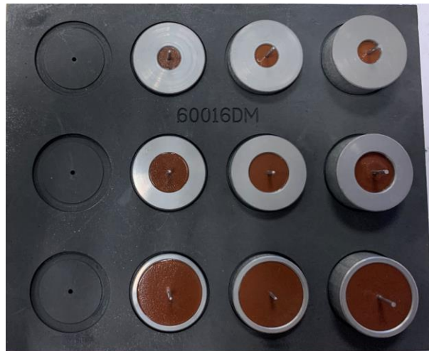
Figura 4.2.24. Muestras resultantes del sellado GTMS de la combinación KBK (Kovar®-BO2-Kovar®)
