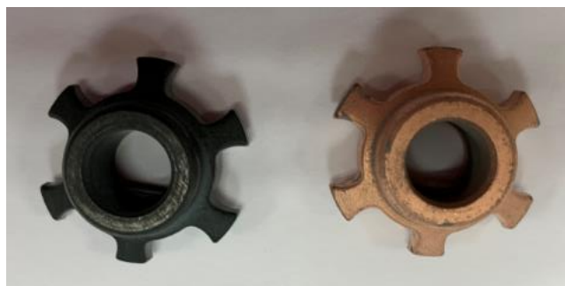
Figura 3.6.1. Piezas fabricadas mediante pulvimetalurgia en la empresa AMES S.A. Izq) Acero bajo en carbono. Dcha) Acero de bajo carbono aleado con cobre
