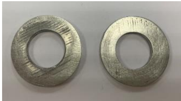
Figura 4.4.15. Piezas de acero inoxidable 316 fabricadas mediante MEAM, con un posterior pulido para eliminar la máxima rugosidad posible en la base metálica y facilitar el sellado con el vidrio
