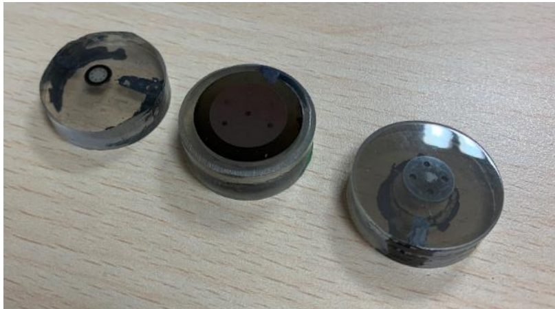
Figura 3.3.2. Muestras embutidas y pulidas
