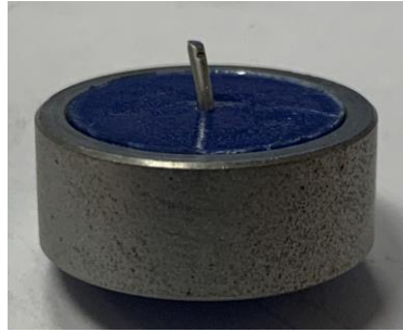
Figura 4.2.47. Muestra FSA09 (acero de bajo carbono-SO5-Alloy 52, 16 mm de diámetro de vidrio y 6,60 mm de altura) después del ensayo de fuerza con vidrio desplazado respecto la base metálica.
