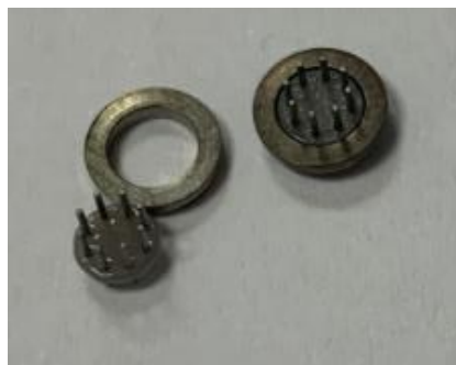
Figura 4.3.31. Muestras del sellado de titanio con el vidrio Elan91 a 780 °C, donde no se genera la unión entre ambos.
