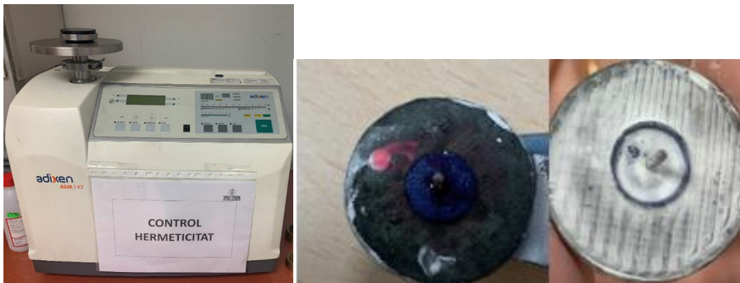
Figura 3.4.2. Izq.) Equipo detector de fugas; Dcha.) Líquidos penetrantes
