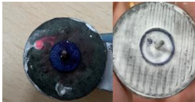
Figura 4.4.12. Estudio de hermeticidad mediante líquidos penetrantes de la unión generada en el diámetro de la base pulida con el vidrio SO5.0
