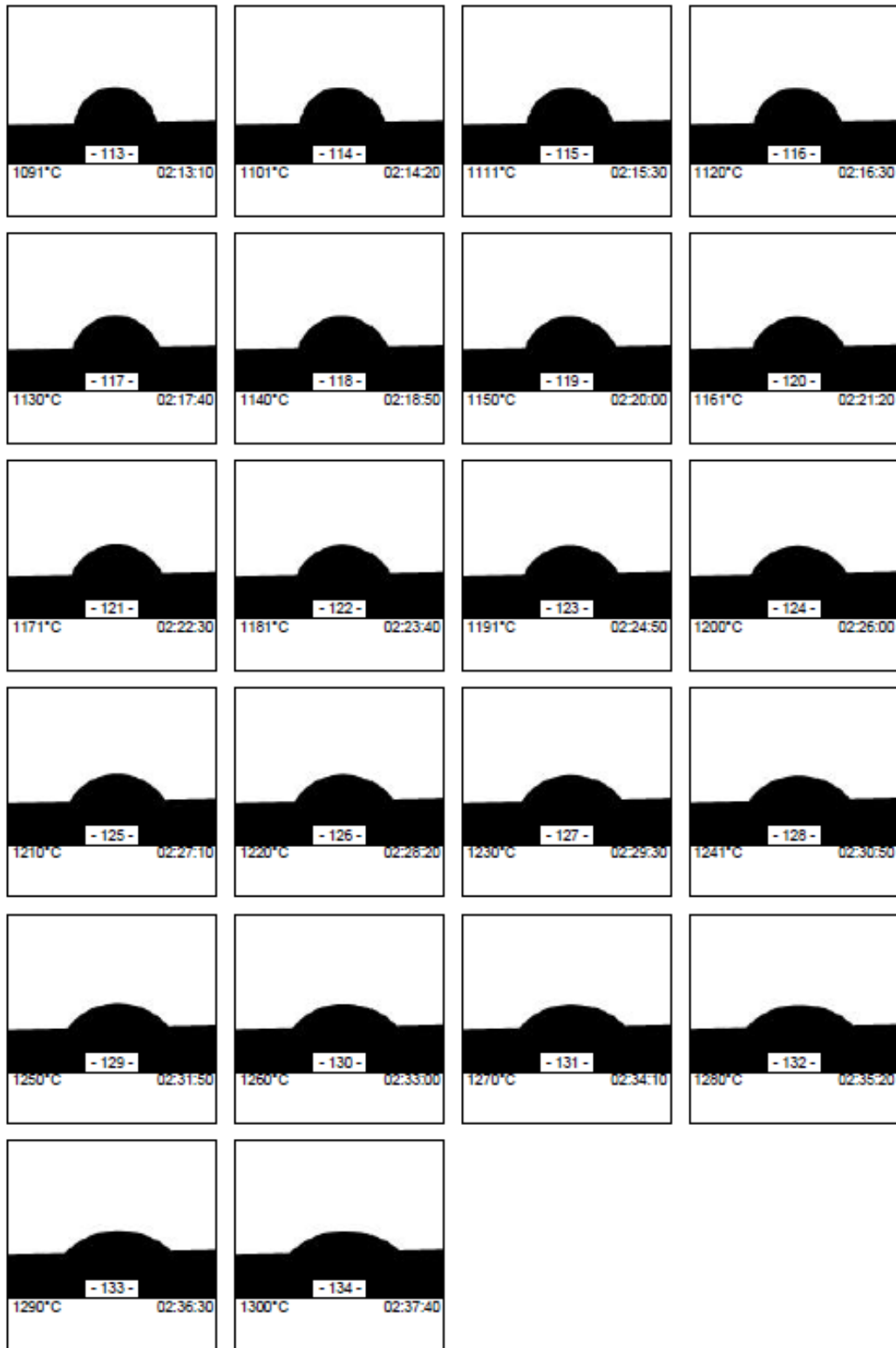
Figura 7.1.6. Informe resultante de la Microscopía de Calefacción sobre un vidrio BO2 marrón pág. 6/6
