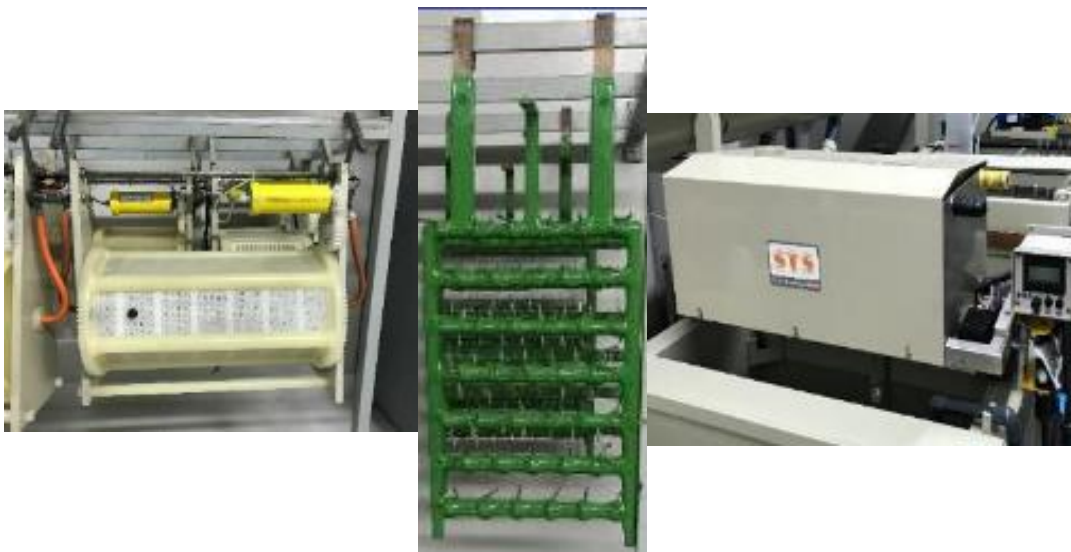
Figura 1.4.2. Métodos de recubrimiento galvanotécnicos metálicos utilizados: bombo, bastidor y vibrador, respectivamente de izquierda a derecha
