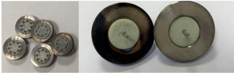
Figura 4.3.25. Piezas fabricadas mediante atmósferas de argón de distinta pureza.
