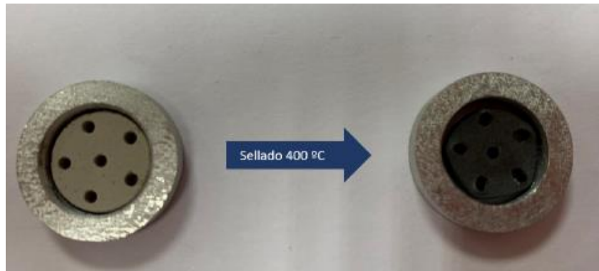
Figura 4.3.4. Resultado del proceso de sellado del vidrio MLT16 con base de aluminio.
