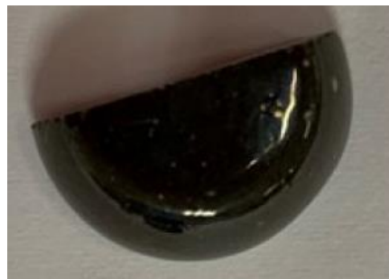
Figura 4.3.5. Aspecto del vidrio MLT16 después de aumentar la temperatura hasta 450 °C.
