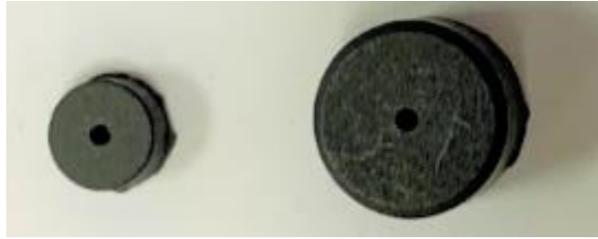
Figura 4.2.21. Sombreros pequeños utilizados en el sellado GTMS para diámetros de 6 mm y 10 mm
