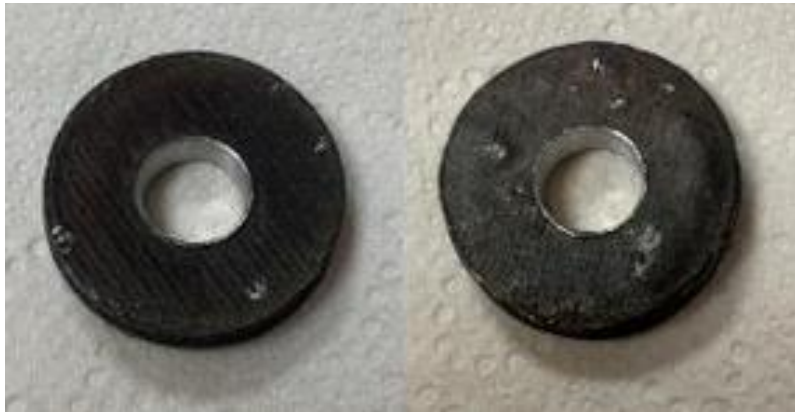
Figura 3.6.9. Muestras sinterizadas con un pulido en el diámetro interior
