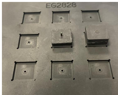
Figura 4.3.17. Montaje de los componentes de aluminio, vidrio EG2828 y pasadores de Kovar® y Alloy 52, junto con los sombreros de grafito.
