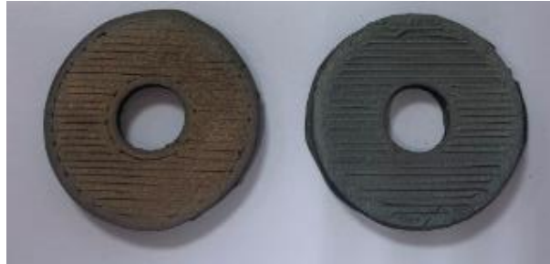
Figura 4.4.14. Piezas de acero inoxidable 316 fabricadas mediante impresión 3D para realizar el sellado vidrio-metal
