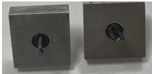
Figura 4.3.9. Imágenes de la unión generada entre el aluminio y el vidrio EG4000 en el ensayo AI4000.9.
