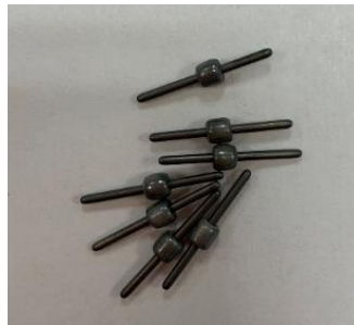
Figura 4.3.16. Vidrio EG2828 después de alcanzar la temperatura de sellado, presentando un cambio de color de amarillo (según la imagen derecha de la figura 4.3.6) a gris.
