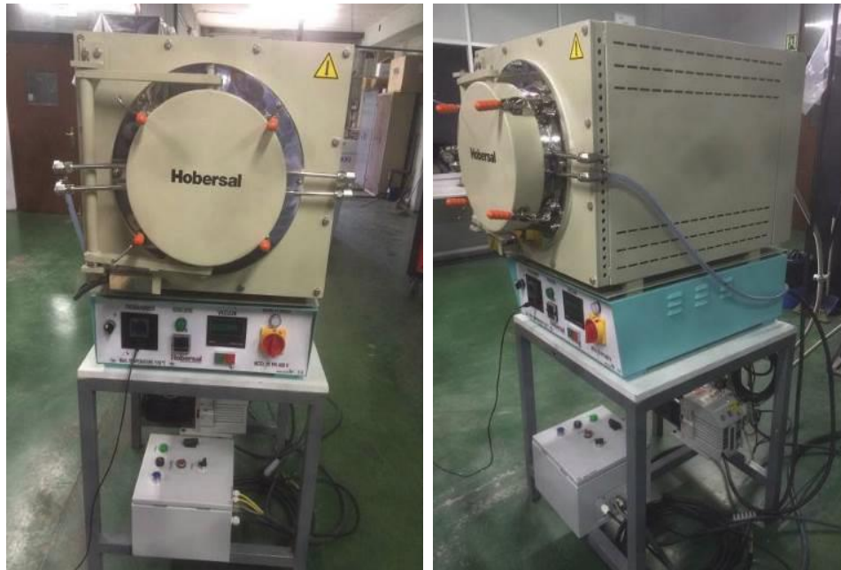
Figura 3.2.1. Horno discontinuo HOBERSAL disponible en VAC-TRON S.A.
