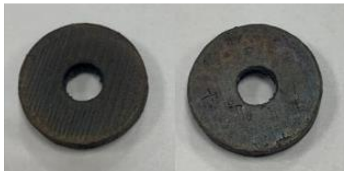
Figura 4.4.9. Muestras de acero inoxidable 316 fabricadas por MEAM.
