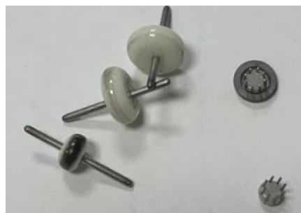
Figura 4.3.33. Muestras del ensayo TiIN3.1, donde las muestras no presentan sellado vidrio – base debido a la falta de peso.
