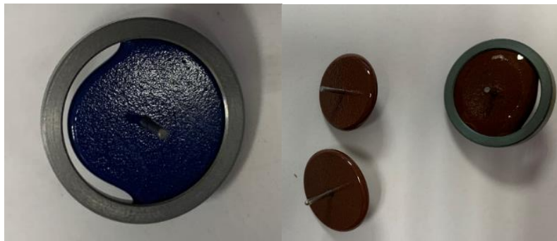
Figura 4.2.23. Muestras IBM07, IBM08 y ISA07 no factibles (AISI 316-BO2-Molibdeno y AISI 316-SO5-Alloy 52)
