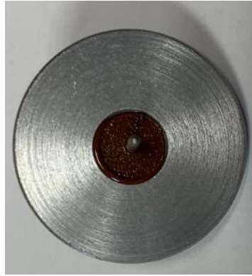
Figura 4.2.18. Muestras del sellado de acero de bajo carbono – vidrio BO2 – pasador de Kovar® (FBK) con exceso de vidrio y vidrio desbordado al sellar
