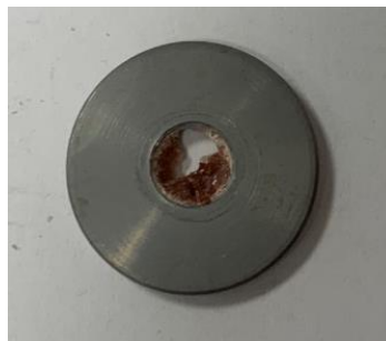
Figura 4.2.46. Figura 4.2.42. Muestra FBK01 (acero de bajo carbono-BO2-Kovar®, 6 mm de diámetro de vidrio y 1,65 mm de altura) después de realizar en el ensayo de presión. Se observa el vidrio roto.
