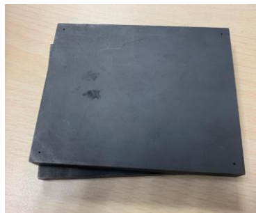
Figura 4.3.26. Caja de grafito situada encima de las piezas para absorber las ppm de oxígeno que permanezcan en el horno durante el sellado.
