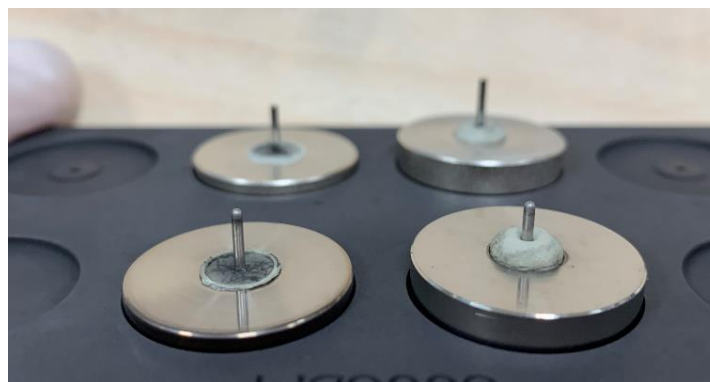
Figura 4.3.28. Vidrio MLT19 desbordado en muestras de poca altura (1,65 mm) y expandido en muestras con mayor altura de vidrio (3,30 mm).
