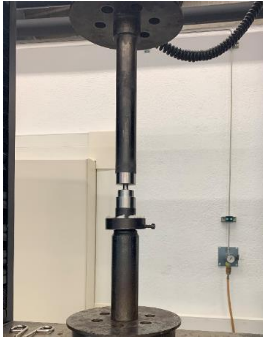
Figura 3.4.7. Imagen del equipo con los útiles para el ensayo de presión
