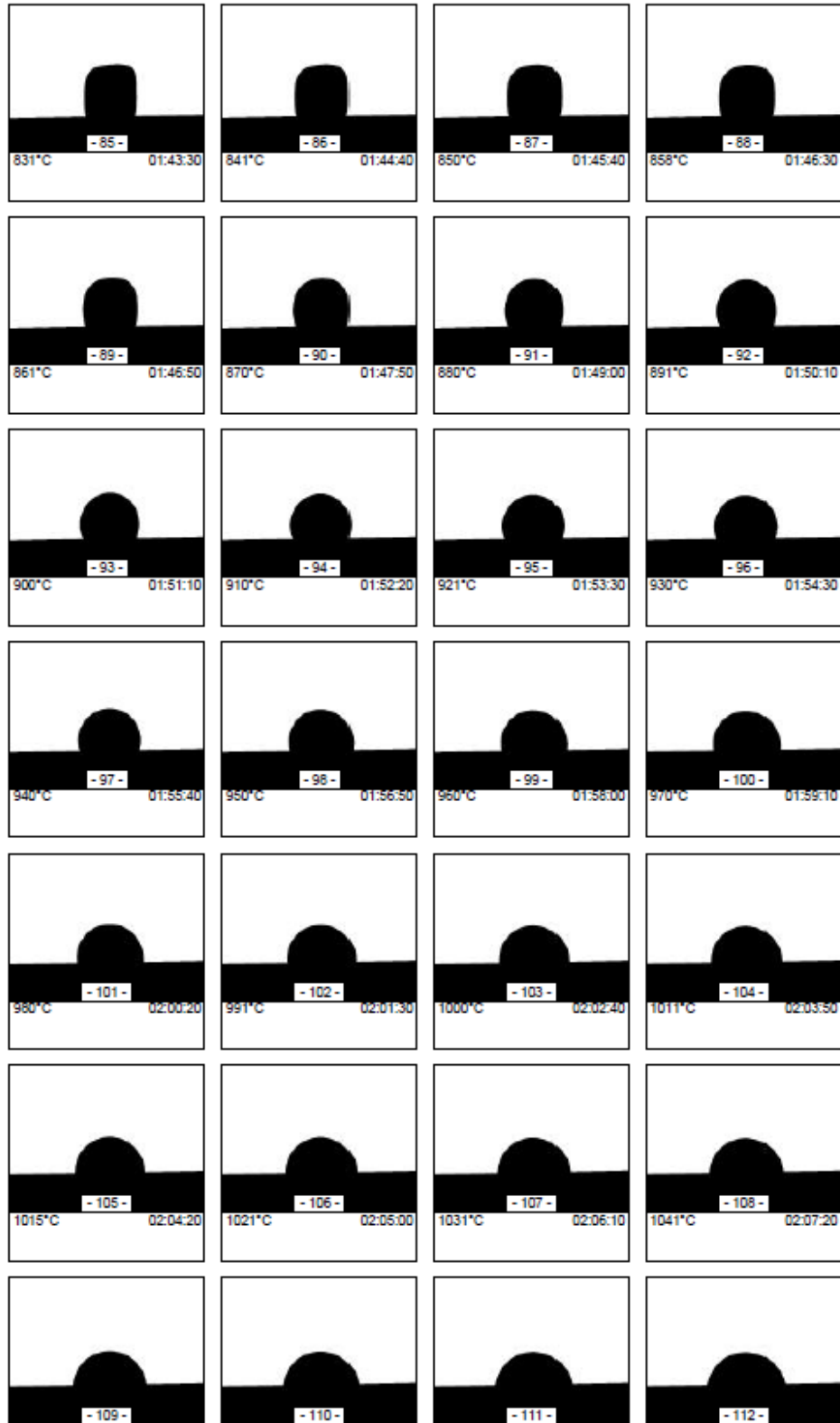
Figura 7.1.5. Informe resultante de la Microscopía de Calefacción sobre un vidrio BO2 marrón pag. 5/6
