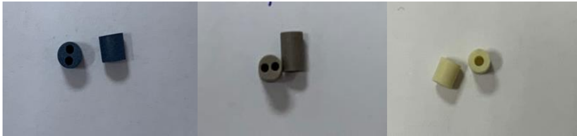
Figura 4.3.6. Preformas de vidrio EG4000, EG2758 y EG2828, respectivamente de izquierda a derecha, antes de realizar el sellado GTMS.
