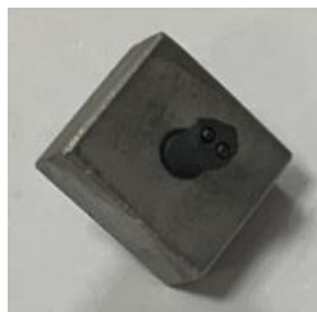
Figura 4.3.14. Muestra correspondiente al ensayo Al2758.5 con el sombrero de grafito enganchado al vidrio.
