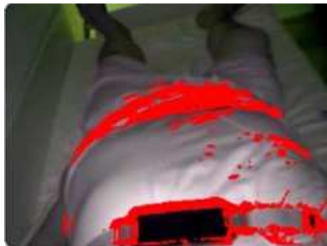
Figura 7. Captura d'un fotograma analitzat per SW. Els punts vermells indiquen on els algorismes del sistema han detectat moviment. A més densitat de punts vermells, major nombre de píxels on s'ha detectat moviment i per tant moviment més intens. Si hi ha poc moviment la densitat de píxels vermells serà menor.
