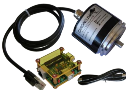
Ilustración 3. Encoder rotacional (Chronojump) que se sitúa en el eje de la polea cónica.
