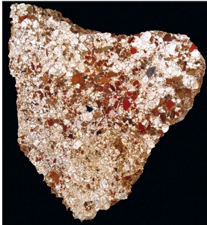
Fig. 134: Fotografía de un fragmento de pavimento en opus signinum procedente, según sus investigadores, del primer piso de la muralla del tipo M.2 de la zona del istmo en Cartagena (Ramallo Asensio y Martín Camino, 2015).
