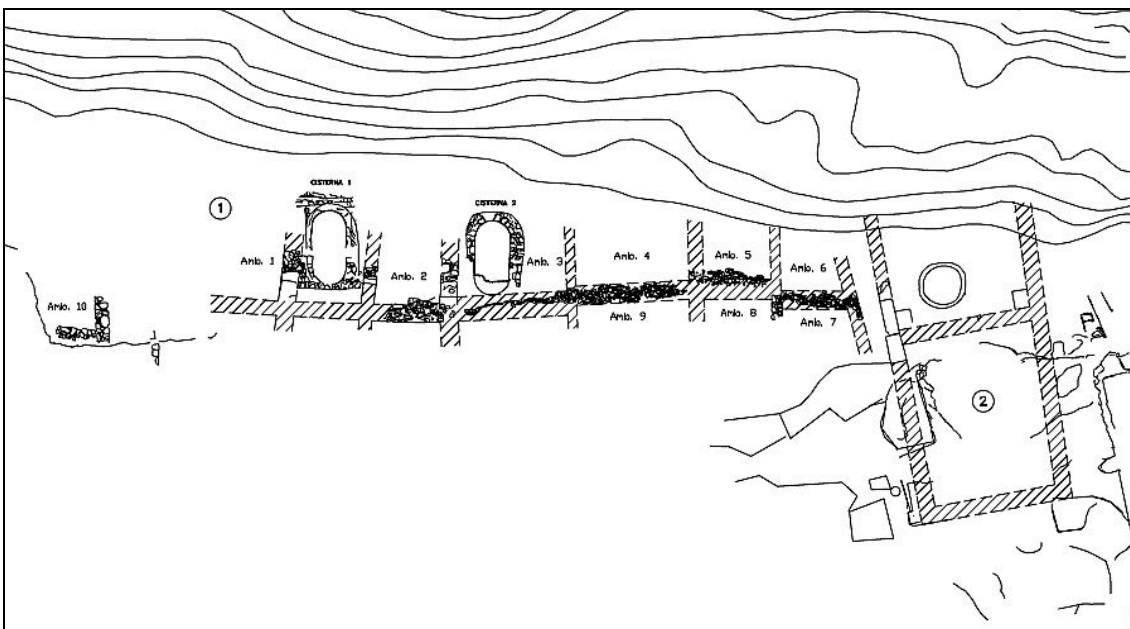
Fig. 201: Planimetría de la muralla de compartimentos dobles documentada en el Cerro del Molinete que corresponde a la fase I de las defensas de Cartagena. Los compartimentos se articulan a partir de un muro de aterrazamiento que sirve para salvar el desnivel existente entre ambos grupos de compartimentos (Noguera Celdrán, Madrid Balanza y Velasco Estrada, 2011-2012).
