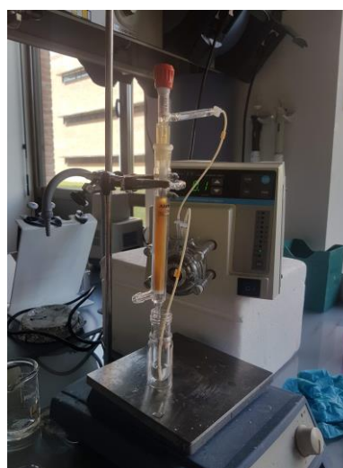
Figura 6.3. Reactor de lecho fijo: (A) Esquema del reactor y (B) foto del reactor con derivado co-inmovilizado. El caudal se estableció en 1,3 \text{ mL min}^{-1} ya que es el caudal mínimo que permite la bomba.
