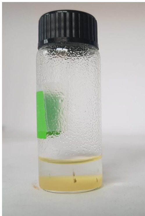
Figura 3.3. Reactor en “batch” compuesto por un vial de 30 mL.
