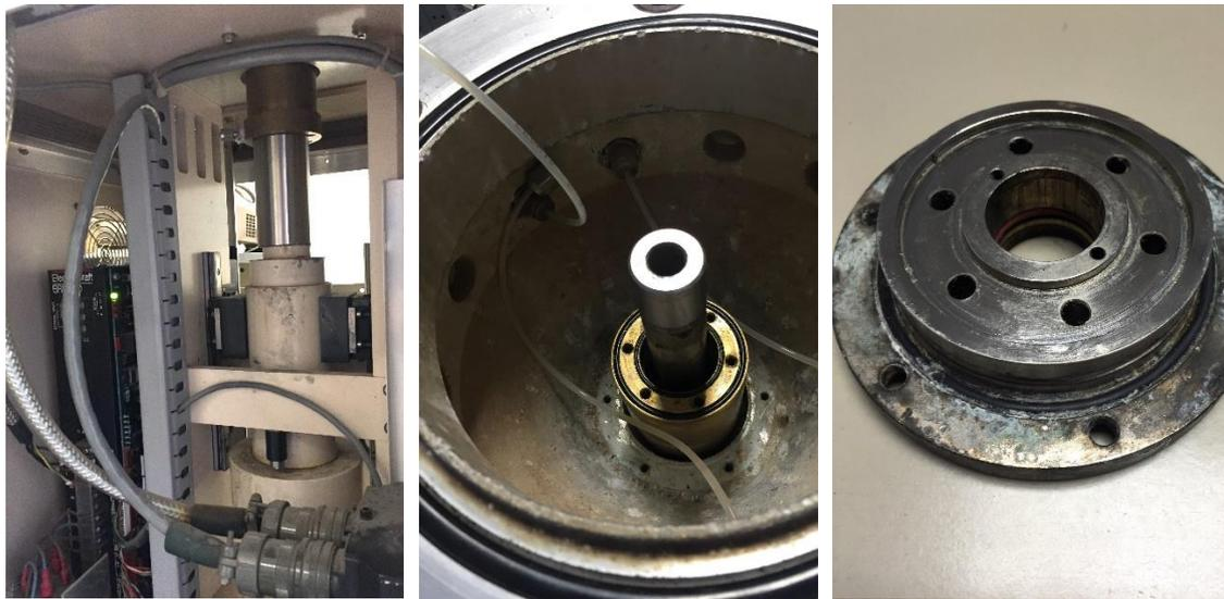
Figura 3.34: Reparación del pistón del triaxial y cambio de tóricas.
