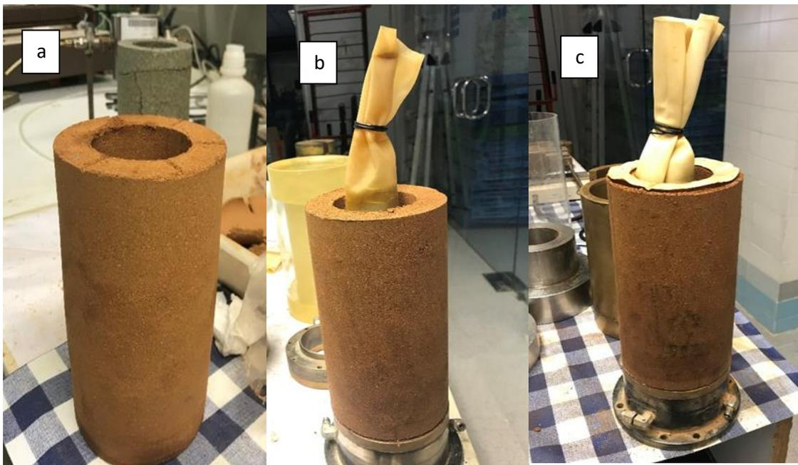
Figura 6.1: Muestras compactadas de la mezcla 70/30 con diferentes humedades: a)  $w=4\%$ ; b)  $w=6\%$ ; c)  $w=8\%$
