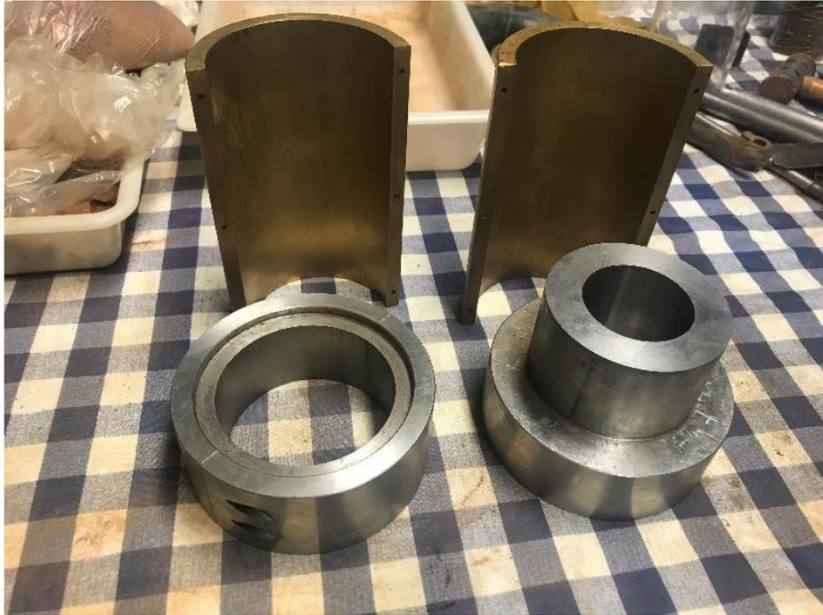
Figura 3.57: Piezas del molde externo de compactación del cilindro hueco
