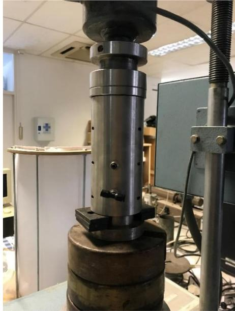
Figura 3.36: Compactación estática para ensayos triaxiales
