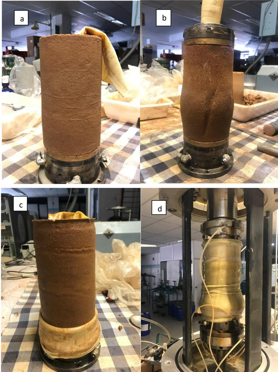
Figura 7.2: Muestras después de los ensayos de colapso: a)  $b=0.5$  y  $q=10\text{kPa}$ ;
