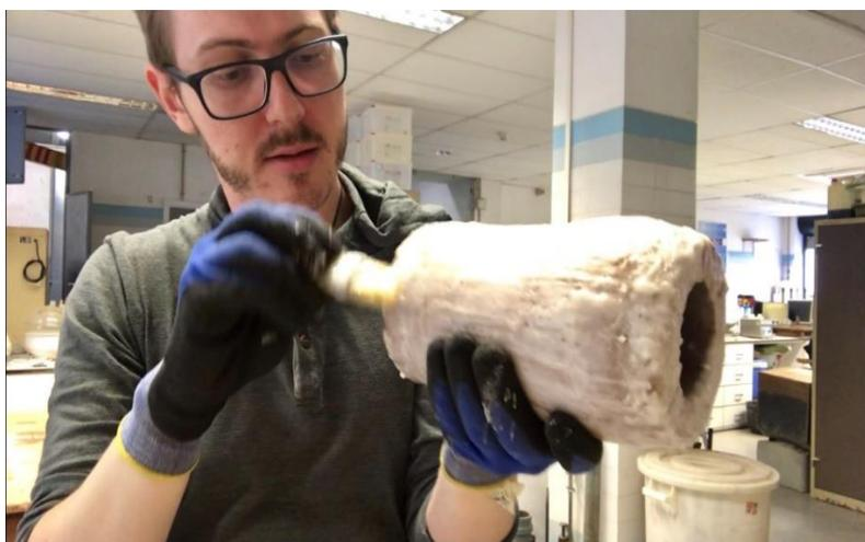
Figura3.65: Aplicación de parafina en la muestra después del ensayo.
