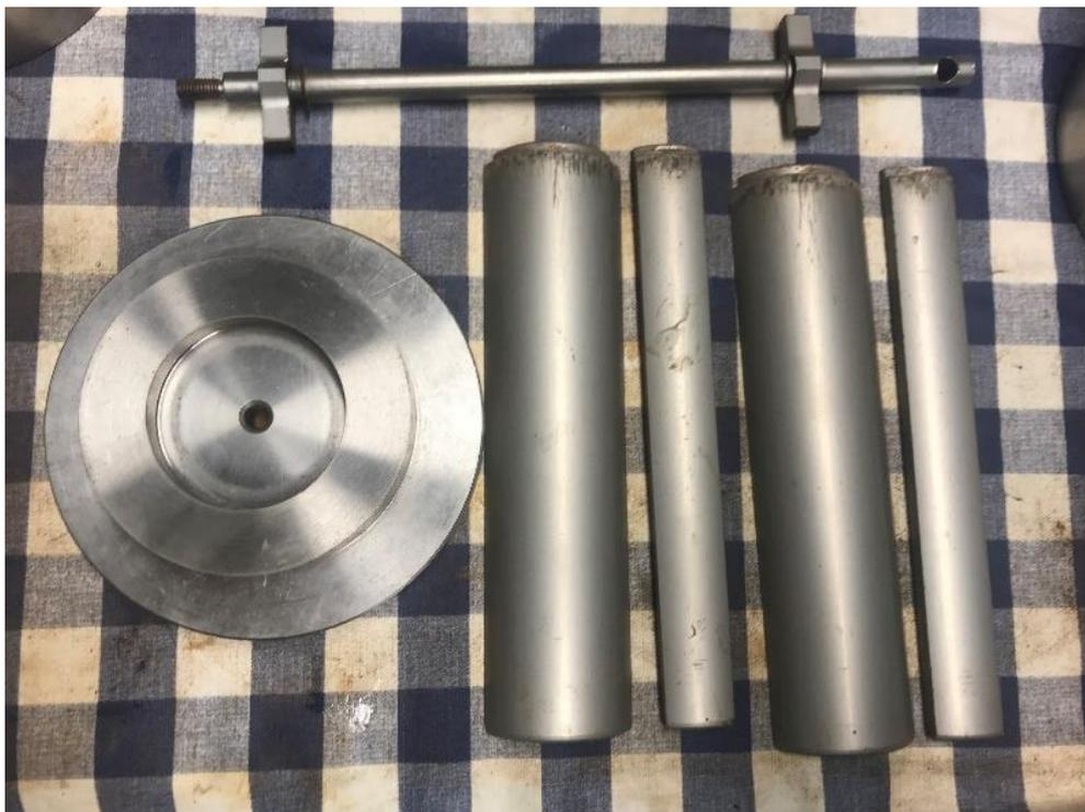
Figura 3.58: Piezas del molde interno de compactación del cilindro hueco
