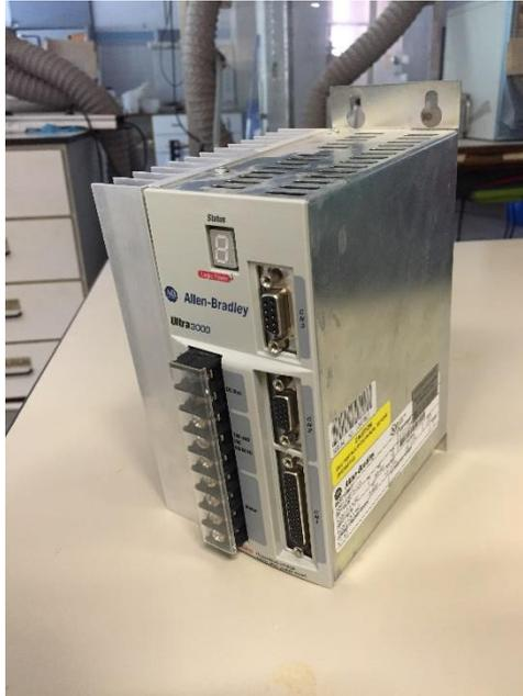
Figura 3.50: Controlador de los motores paso a paso de los actuadores del cilindro hueco
