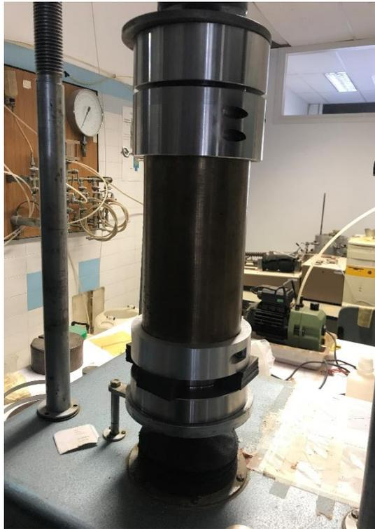
Figura 3.54: Compactación estática de las muestras de cilindro hueco.
