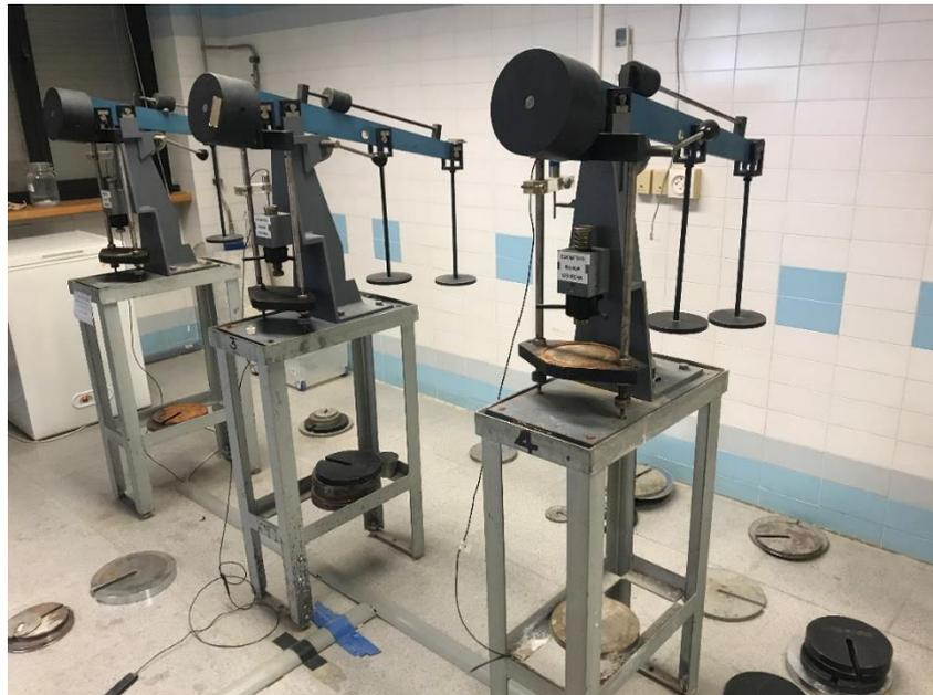
Figura 3.22: Edómetros de tipo Bishop del laboratorio de geotecnia de la Universitat Politècnica de Catalunya (UPC)
