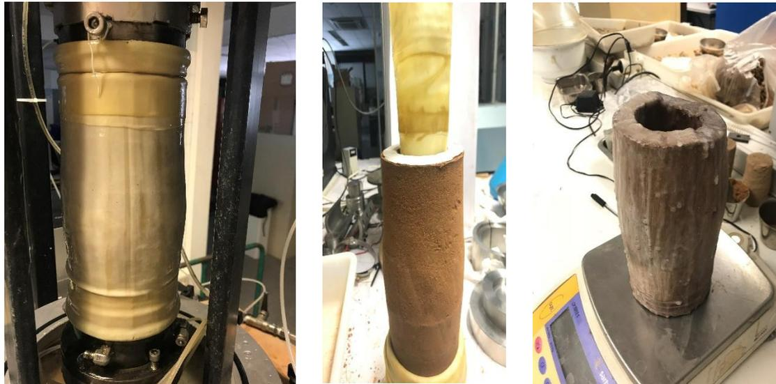
Figura 3.66: Ejemplo del desmontaje de la muestra al finalizar ensayo en la condición no saturada.
