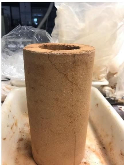
Figura 6.18: Muestra después del ensayo de corte convencional con la tensión principal inclinada  $20^\circ$ ,  $b$  igual a 0 y  $w=6\%$   $\Delta q/\Delta p=3$
