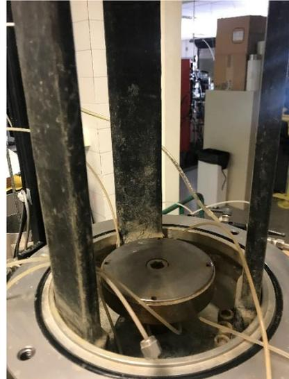
Figura 3.44: (A) pedestal superior y célula de carga; (B) pedestal inferior y pistón de desplazamiento vertical y rotacional.
