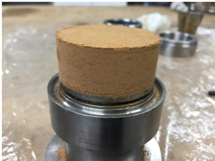
Figura 3.21: Muestra compactada para utilizar en edómetro.
