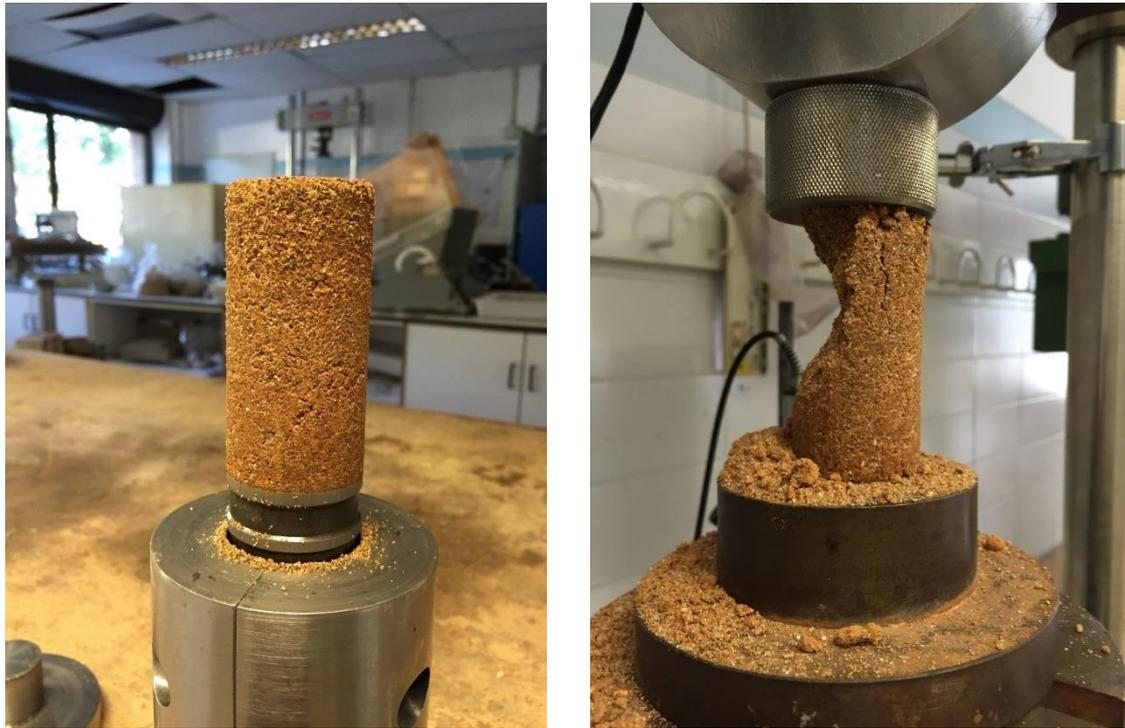
Figura 3.9: Mezcla 50% de arcilla y 50% de arena (50/50).
