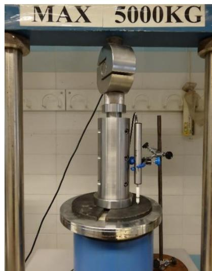
Figura 3.8: Compactación estática para las muestras ensayadas a compresión simple
