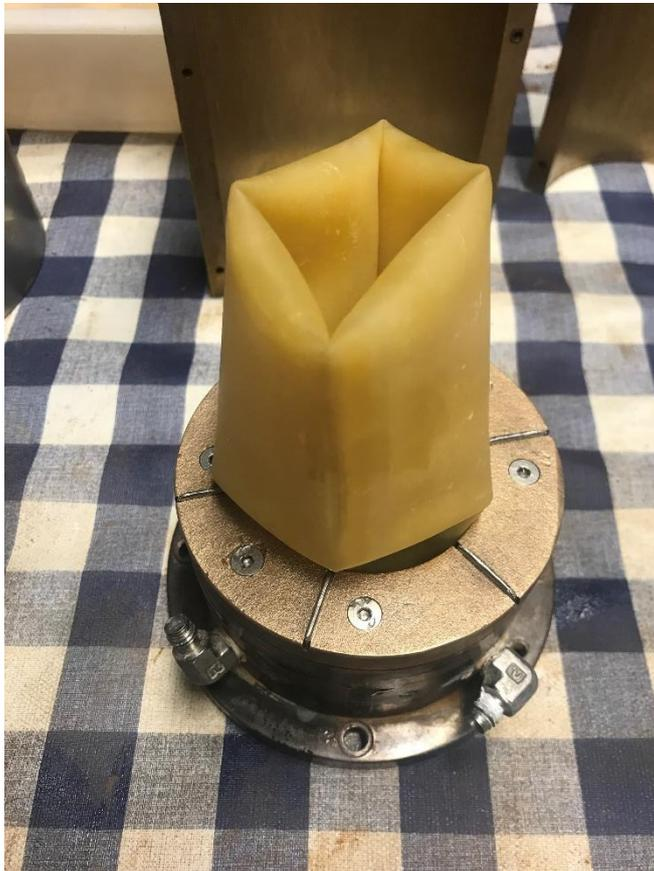
Figura 3.56: Membrana interna fijada en la base del cilindro hueco
