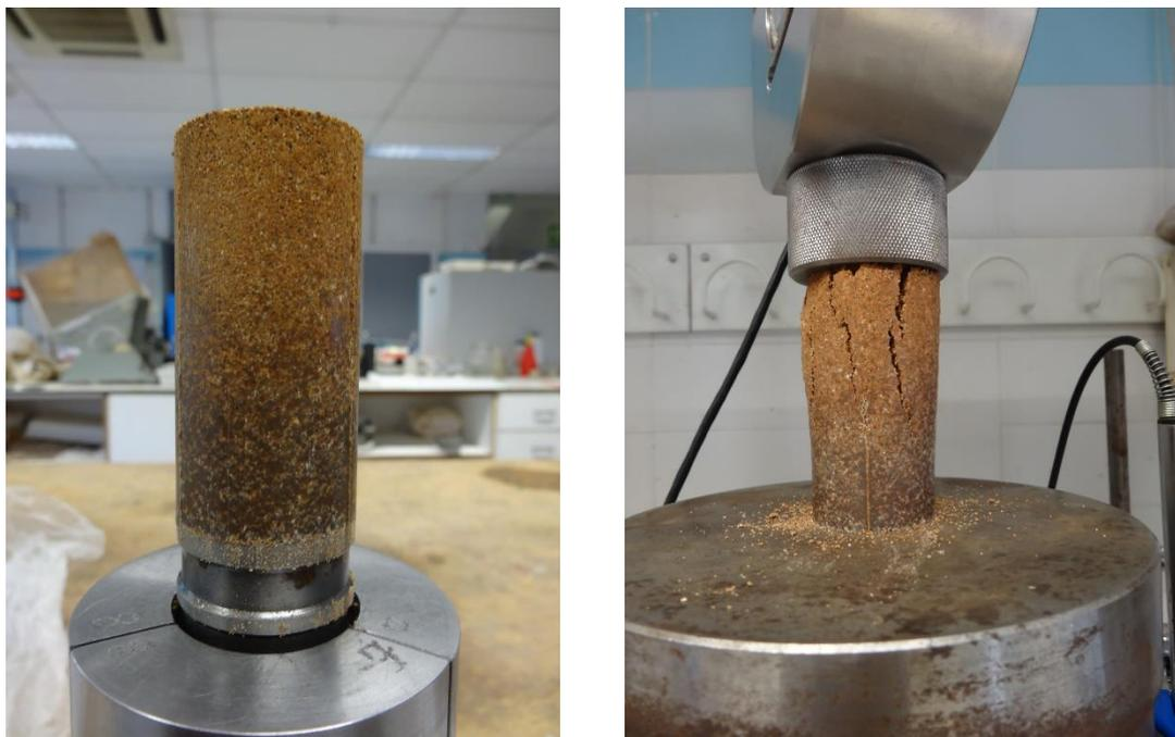
Figura 3.11: Mezcla 70% de arcilla y 30% de arena (70/30).
