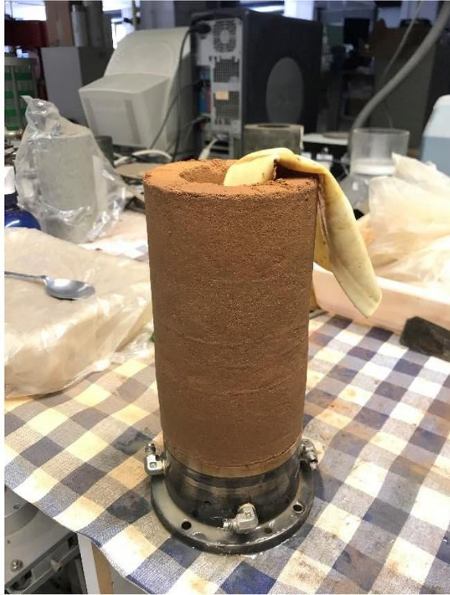
Figura 3.67: Muestra tras un ensayo de colapso en el cilindro hueco.
