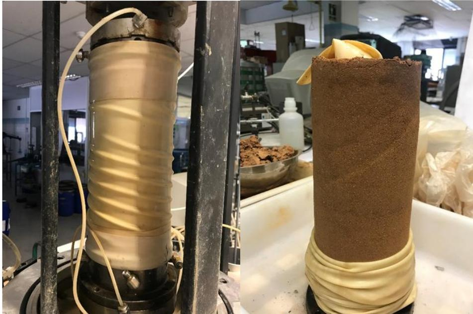
Figura 5.3: Ejemplo de muestra tras el ensayo de carga cíclica a pequeñas deformaciones (M-I)
