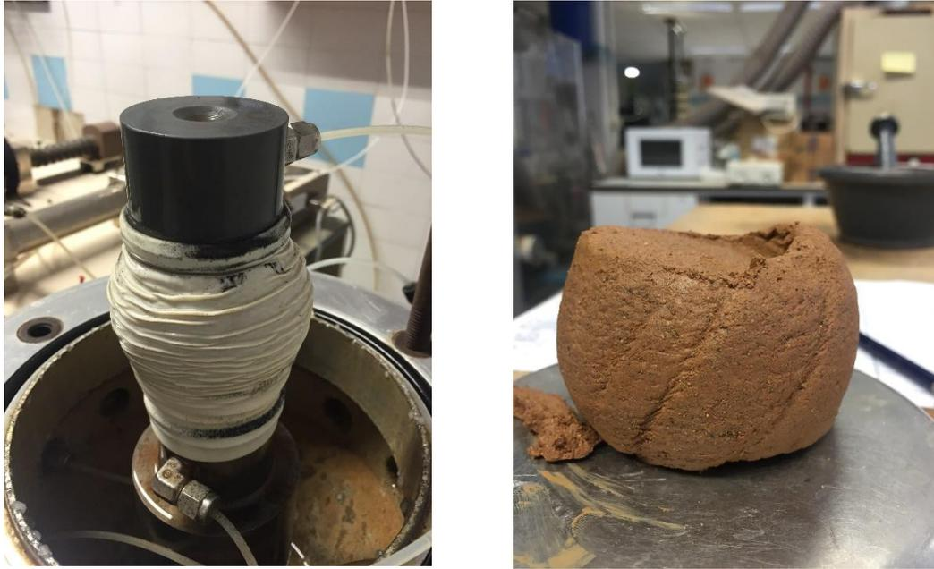
Figura 3.42: Rotura por exceso de deformaciones.
