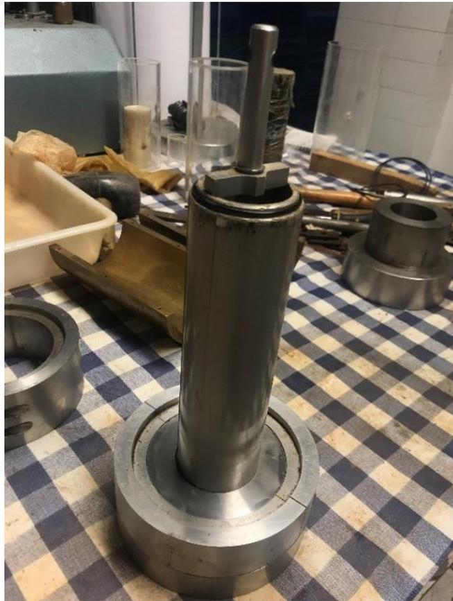
Figura 3.59: Molde interno de compactación del cilindro hueco montado
