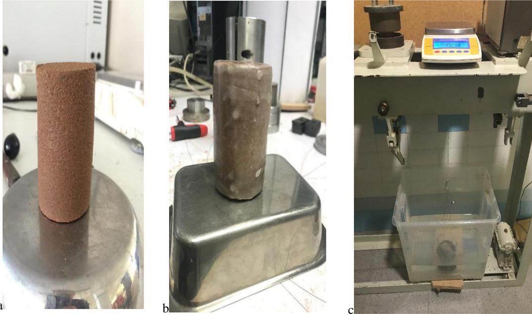
Figura 3.43: (a) muestra después del ensayo; (b) muestra con parafina; (c) peso sumergido.
