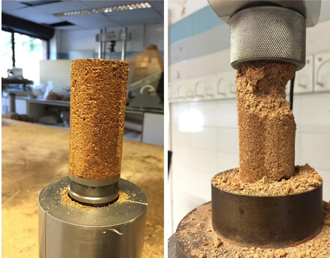
Figura 3.10: Mezcla 60% de arcilla y 50% de arena (60/40).
