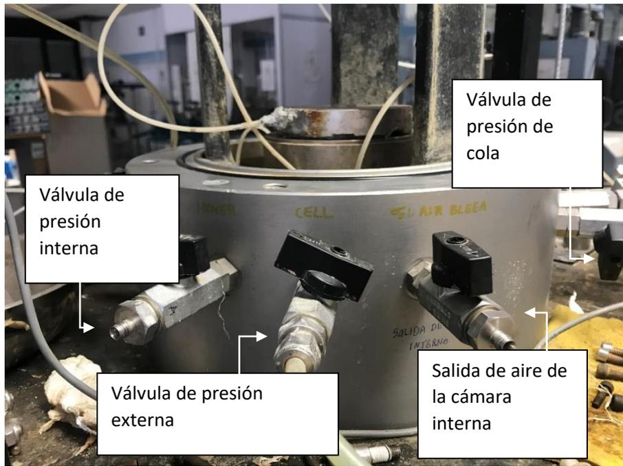
Figura 3.45: Conexiones en la base del cilindro hueco (vista frontal).
