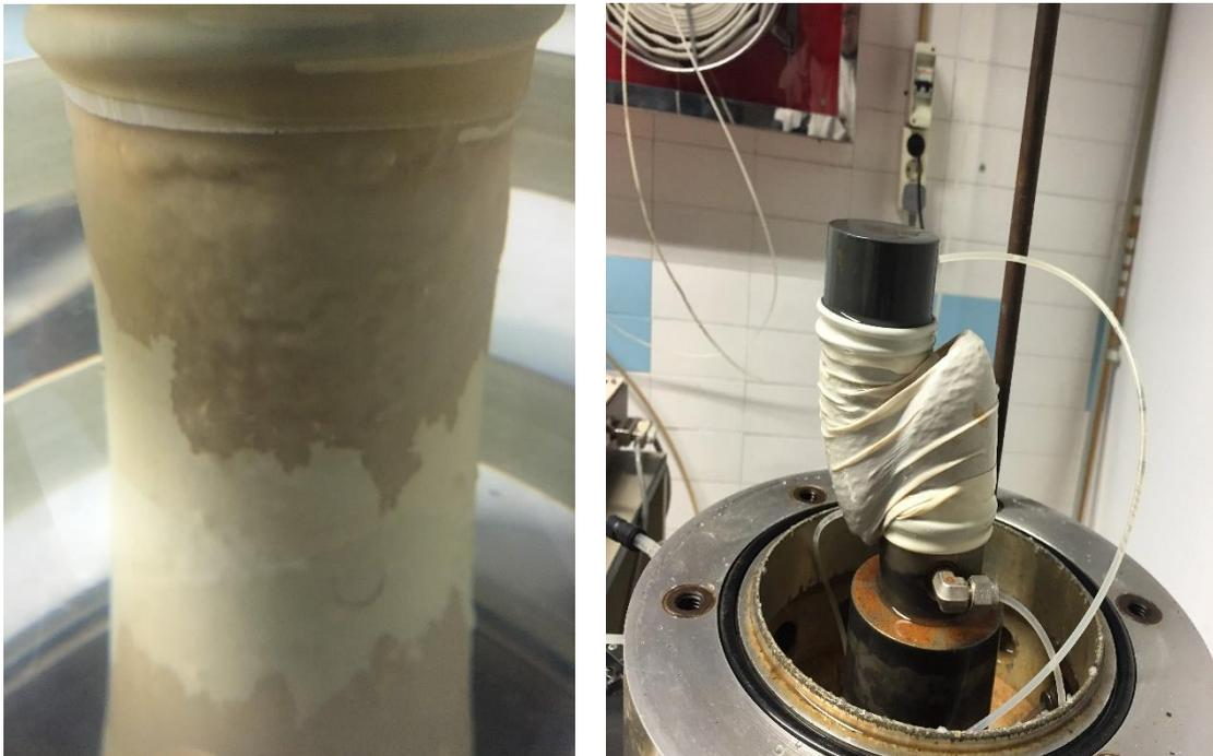
Figura 3.41: Saturación de la muestra (foto izquierda); rotura por corte (foto derecha).
