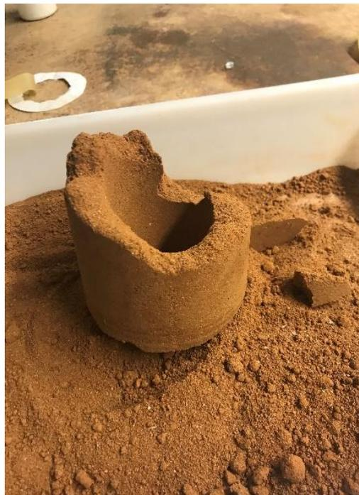
Figura 3.53: Muestra rota por falta de compactación en el extremo opuesto al que se aplica la carga en el molde.
