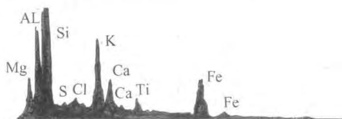
An-8/7.F-2 Escama de pintura pástica silícica
