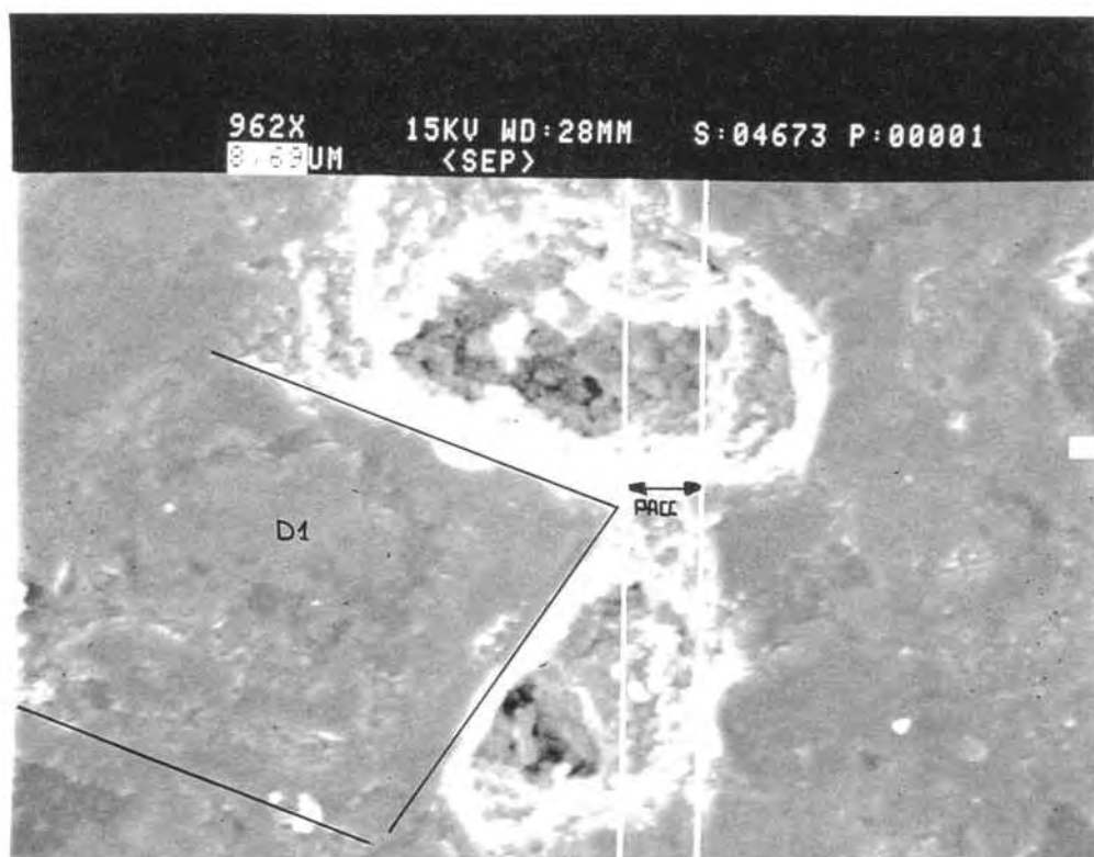
Poros en forma de cuello de botella (PACC) en los espacios intracristalinos de las fábricas Idiográficas (D1) de dolomita
