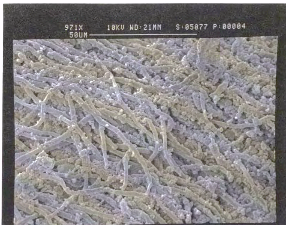
An-8/44.F-1 Hifas de la costra líquénica gris-blanquecina del "Arc de Berà" con microcristales de oxalatos (Weddellita)
