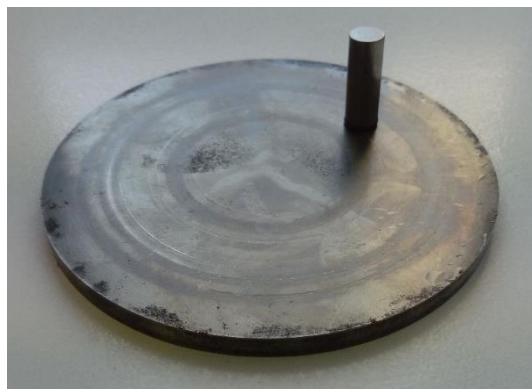
Figura 3.2. Pin de acero inoxidable AISI 304 y disco de acero F.5220 templado en aceite y revenido.
