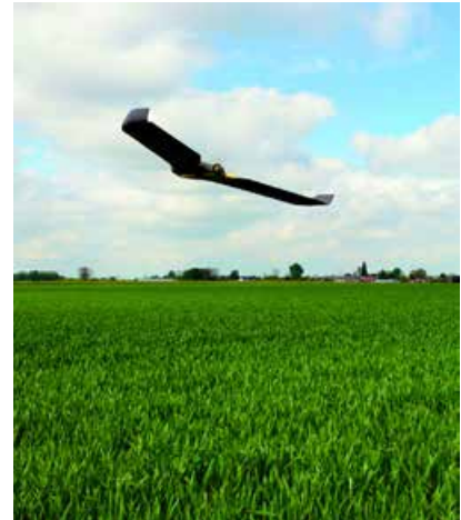
FIG. 45 Drone guiado por GPS que examina los cultivos y mide el suministro de nitrógeno necesario para mejorar la productividad. Caulières, France, May 6, 2014 ©Denis Charlet/AFP/Getty Images.
