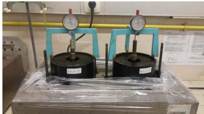
*Figura 4.4: Equipo de expansión para el ensayo de expansión sumergido en agua a 70°, ASTM D4792 [69]*
