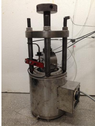
Figura 4.15: Equipo de fuerza de expansión con camisa calefactora metálica, sistema de goteo para la entrada de agua, célula de carga y LVDT sobre el pistón.
