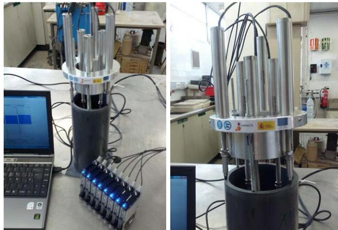
Figura 4.8: Equipo de medición de deformación de probetas.
