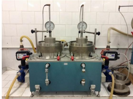
Figura 4.2: Equipo de expansión acelerada mediante vapor
