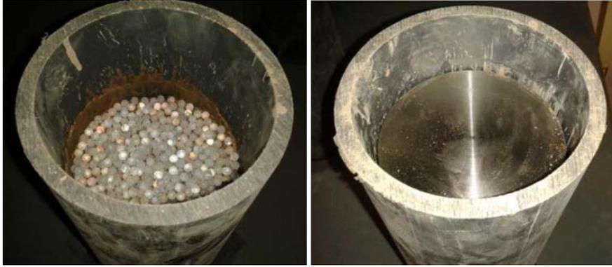
Figura 4.7: Probetas fabricadas en moldes, con esferas de vidrio y superficie plana
