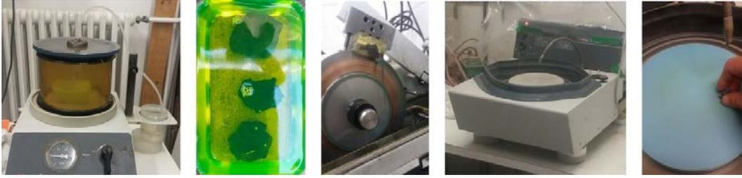
Figura 2.5: Procedimiento de preparación de muestras para microsonda electrónica de barrido (EPMA) y microscopio electrónico de barrido (SEM)
