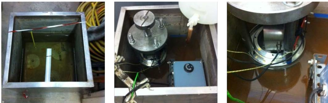
Figura 4.14: Equipo de fuerza de expansión sumergido en agua caliente
