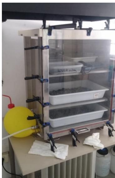
Figura 5.13: Cámara hermética con saturación de  $CO_2$ , temperatura alrededor de  $40^\circ C$ , y humedad relativa HR 75%.
