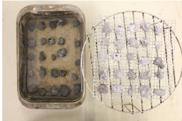
Figura 4.46: Ejemplo de colocación de partículas en autoclave, sumergidas en agua y a vapor.
