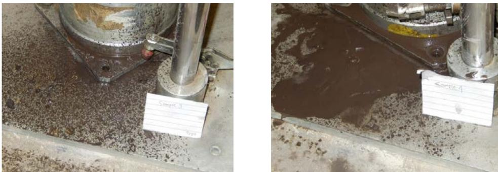
Figura 2.21: Segregación de material en el ensayo de proctor modificado. Cantidad de agua: izquierda: 4,71%; derecha: 5,57%
