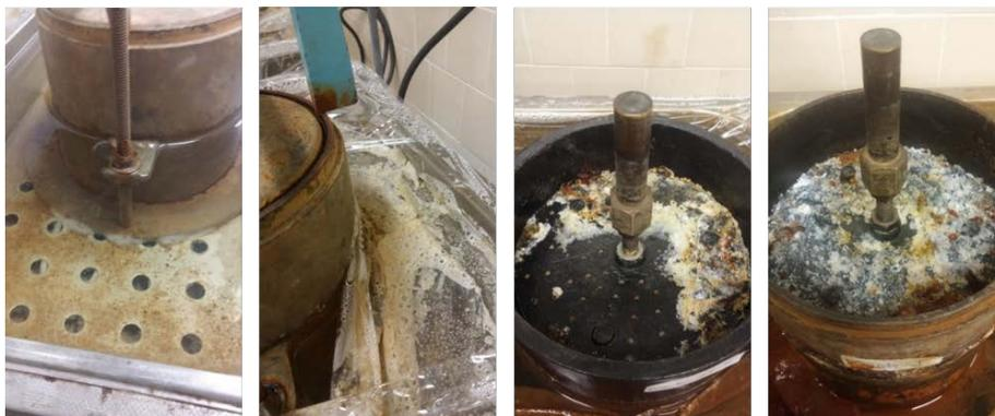
Figura 4.29: Eflorescencias en el ensayo de expansión sumergido en agua a 70°C, ASTM D4792 [69]
