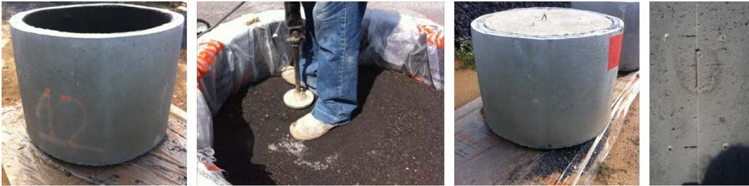
Figura 4.11: Cilindro de hormigón en vacío, compactando material KOS, la tapa (sobrecargar) de hormigón y la muesca con los puntos adyacentes de medición de la deformación.
