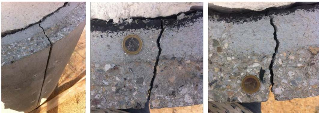
Figura 4.31: Cilindros de hormigón en masa (diámetro 1m), rellenos de KOS Cilindro fracturados a los 419 días desde su implantación
