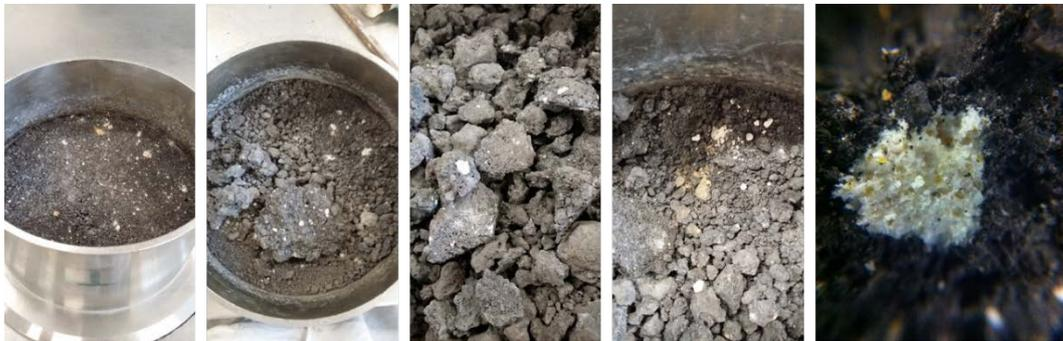
Figura 4.28: Nucleaciones en las probetas ensayadas a expansión a vapor según norma UNE-EN 1744-1:2010+A12013 [17]
