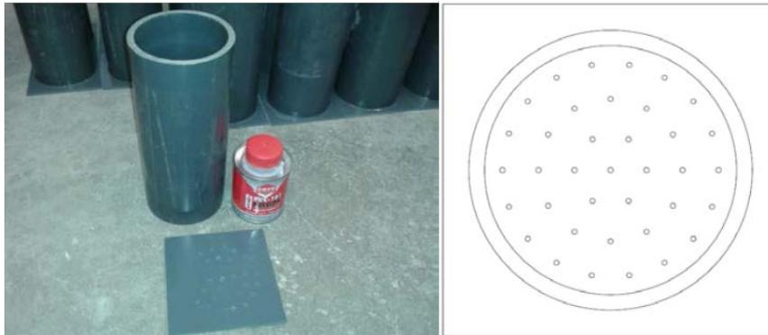
Figura 4.5: Molde de compactación de PVC y tapa inferior con orificios.
