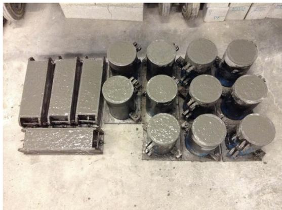
Figura 4.18: Probetas de hormigón con escoria KOS T0.
