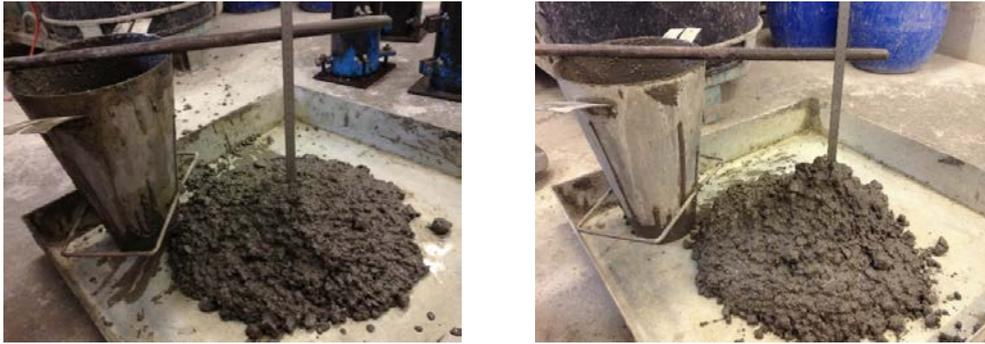
Figura 4.19: Ensayo de cono de Abrahán sobre hormigón HA y HB respectivamente
