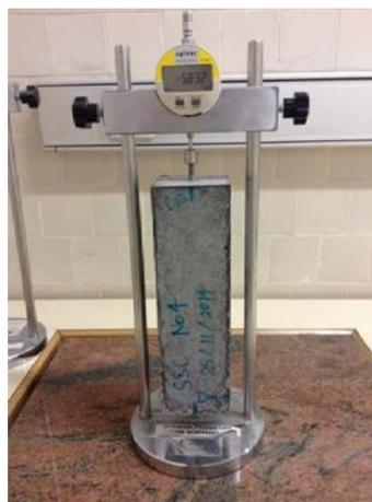
Figura 4.20: Instrumento de medición de la deformación longitudinal de las probetas prismáticas de hormigón
