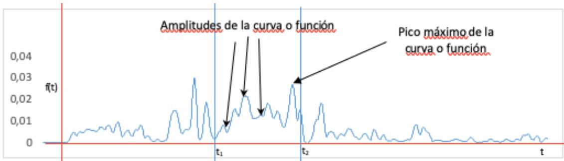
Figura 3: Descripción de amplitud y pico máximo de la curva o función electromiográfica (RMS)
