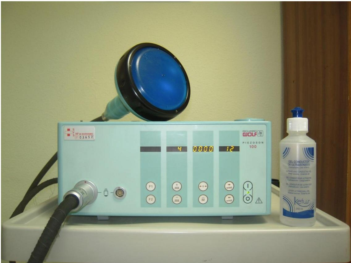
Figura N. Generador de ondas de choque extracorpóreas Piezason 100 ®,
