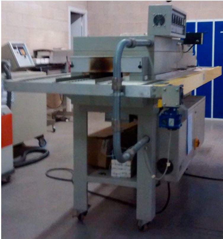
Figura 25 Forn monostrat de proves amb obertura per a làser.
