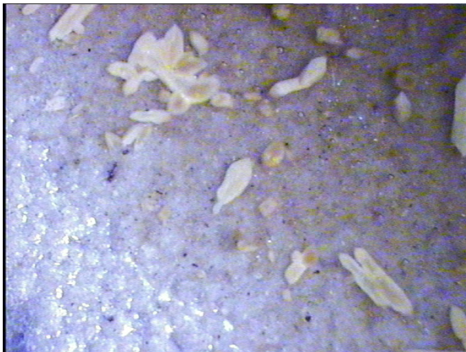
Figura 138 Superfície de la composició I1C serigrafiada i amb el làser aplicat.
