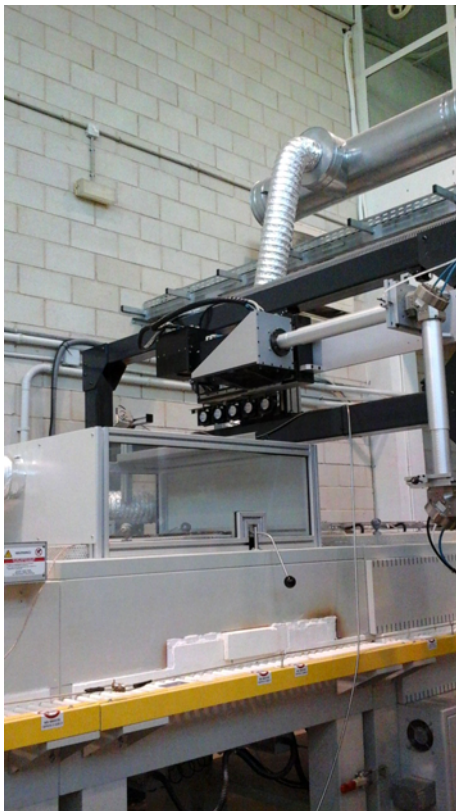
Figura 14 Forns monostrats de dimensions industrials amb làser incorporat a la zona de cocció.
