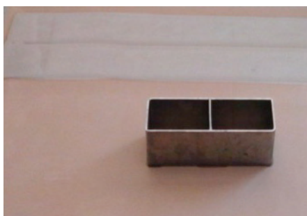
Figura 21 Peça esmaltada amb patí de 0,7mm d'espessor.
