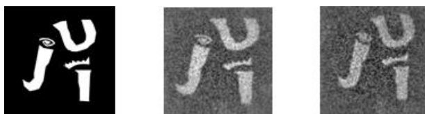
Figura 5.6. Desxifratge quan Bob genera la clau computacionalment. a) Imatge original, b) Reconstrucció simulada amb SNR=6 i MSR=0,14, c) Reconstrucció real amb SNR=4 i MSR=0,14.
