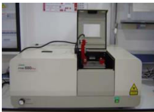
Figura 3.8. Equipo de espectroscopía infrarrojo por transformada de Fourier (FTIR)
