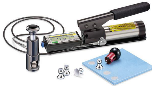
Figura 3.10. Equipo utilizado para el ensayo de adherencia por tracción
