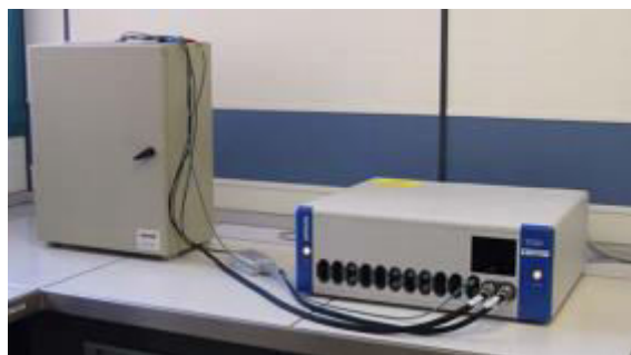
Figura 3.21. Equipo de impedancias y celda de Faraday
