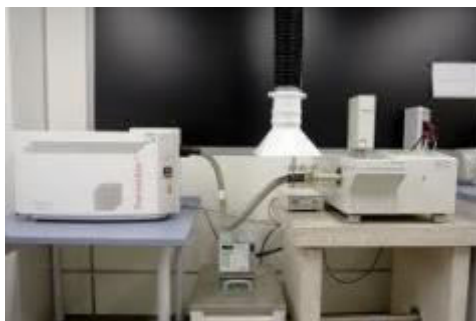
Figura 3.9. Equipo simultáneo TG-STDA Mettler Toledo
