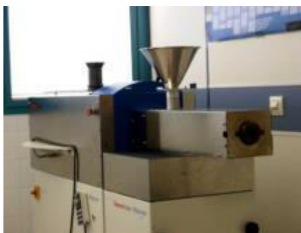
Figura 3.4. Extrusora monohusillo Haake Rheomex 254
