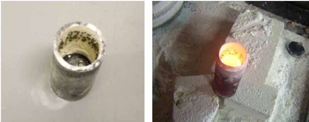
Figura 39. Crisol de grafito con su pared interior recubierta de nitruro de boro (izquierda) y Vidrio recién extraído del horno (derecha).
