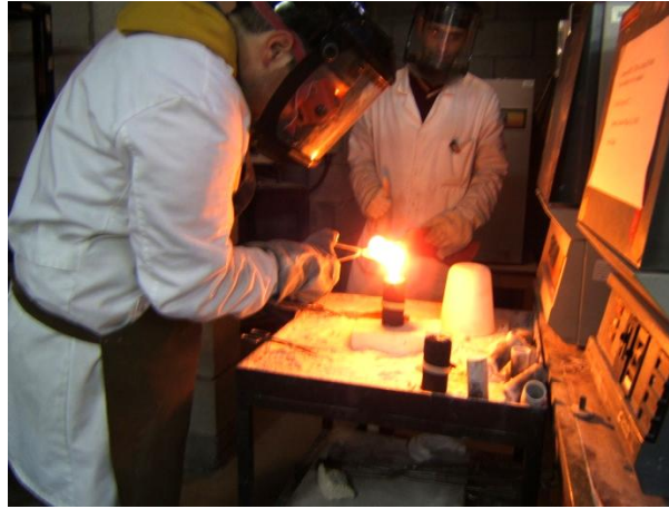
Figura 40. Colado de un vidrio en un molde precalentado a su T_{g,ATD} . Para realizar la operación de manera óptima se requieren dos personas.
