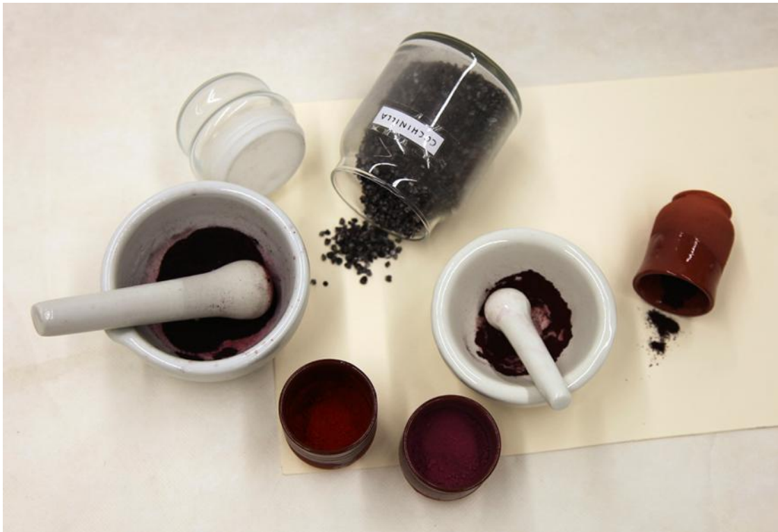
Figura 9: Cochinilla de dos variedades (a: americana b: europea) triturada en dos morteros antes de ser precipitada en alumbre. En los dos pocillos centrales el resultado del pigmento-laca ya precipitado, con una tonalidad rojiza a la izquierda y con una tonalidad púrpura a la derecha.
