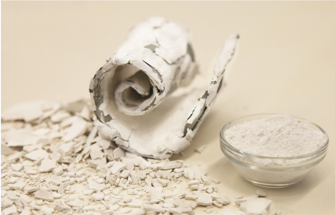
Figura 26: Una lámina de plomo enrollada con el carbonato sobre su superficie listo para su recolección, tras la reconstrucción del método de producción tradicional en el laboratorio del CAEM. Obsérvese la forma de laxitas , (como las llama Pacheco) sobre las que se apoya, desprendidas de otra lámina análoga. A la derecha el pigmento ya lavado, levigado y molido, listo para su utilización. Fotografía: autor.
