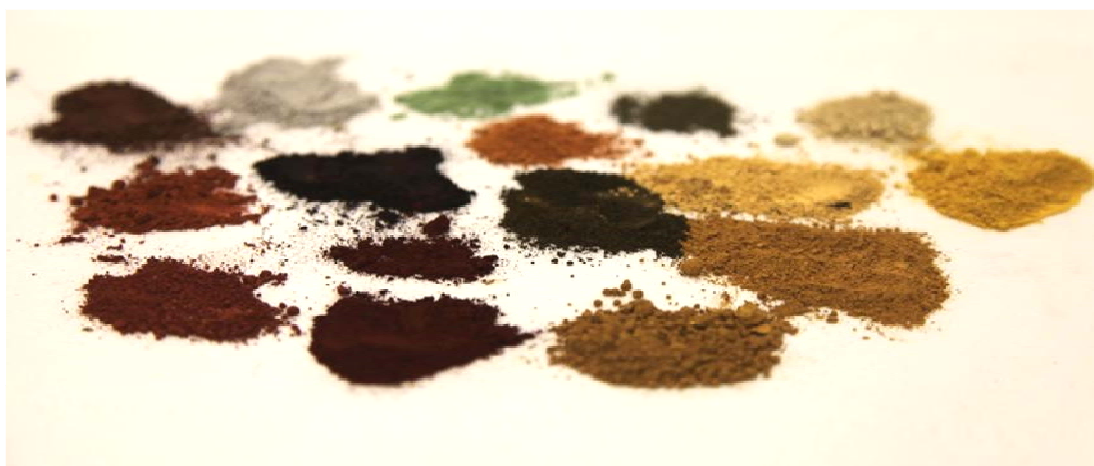
Figura 6: algunos pigmentos tierra triturados y levigados, listos para su moltura final y templado. Fotografía: autor.
