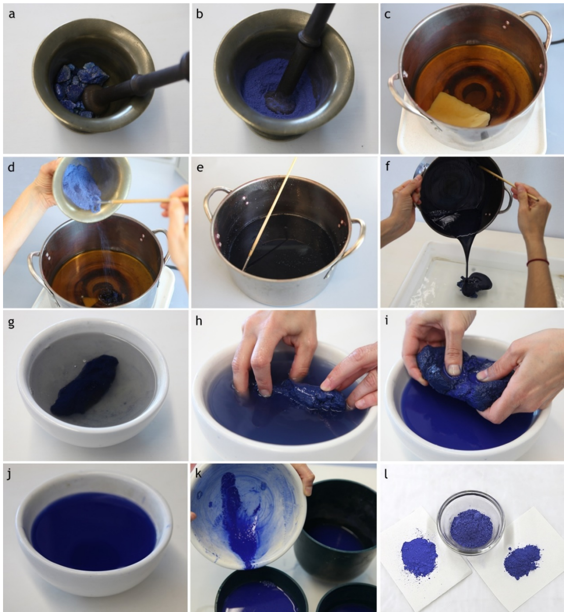
Figura 19: reconstrucción del proceso de obtención del azul ultramarino a partir de lapislázuli, efectuada en el laboratorio del CAEM, a partir del texto de Cennino Cennini. (a) Se toman las piedras de lapislázuli y se disponen en mortero metálico. (b) Se muele el mineral repetidas veces en cantidades pequeñas hasta alcanzar un polvo granulado, como arena (el mortero debe taparse con un trapo durante la moltura, para evitar desperdicios). A continuación puede molerse en la piedra de granito sin agua, hasta obtener un polvo fino de unas 100 \mu\text{m} (debe cribarse varias veces). (c) En una olla a fuego bajo se coloca la colofonia, el mástico y la cera, hasta que todo se funde, y se retira del fuego un tiempo. (d) Se añade el polvo de lapislázuli removiendo adecuadamente. (e) se vierte la masilla resultante en una batea con agua, en la que se enfría rápidamente. Con las manos untadas en aceite vegetal se recoge y se trabaja, formando panes. (g) Los panes se dejan a remojo en agua tibia durante varios días, amasándose varias veces al día. (h, i) Finalmente, para la extracción del color, basta añadir al agua una solución potásica caliente. A continuación, los panes pueden ir trabajándose en el agua, amasándose durante varias horas, para ir sacando el color, hasta que la masilla queda de color pardo azulado y no se extrae más azul. (j) En el fondo del bol se acumula el pigmento más grueso y las impurezas, mientras que el pigmento más fino permanece en suspensión en el agua. (k) Comienza entonces un proceso de levigación que dura días con cada uno de los pocillos o boles que contienen las diversas aguas, separándolas en función de su pureza. (l) Tras la evaporación del agua el residuo resultante de cada pocillo es azul ultramarino puro, que debe molerse de nuevo antes de usarse. Fotografía: autor.
