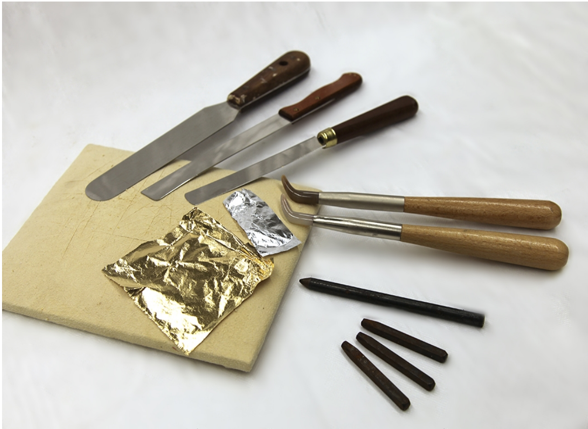
Figura 31: cojinete o pomazón con un pan de oro y un fragmento de pan de plata. Sobre la superficie de gamuza se apoya una espátula, dos cuchillos y dos piedras de ágata, mientras que en la parte inferior pueden observarse diversos punzones y troqueles. Fotografía: autor.
