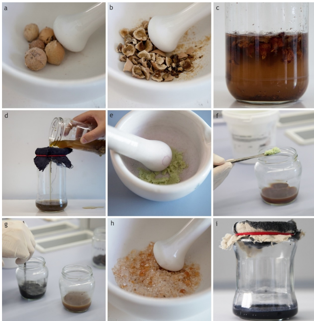
Figura 30: Proceso de reconstrucción de la tinta metalogáfica a partir de fórmulas históricas. (a) Se toman agallas. (b) Se colocan en el mortero y se muelen. (c) Se dejan a remojo durante varios días en agua, vino, o vinagre, según recetas. (d) Pasados unos días se filtran y se recupera el líquido, que se pone a calentar. (e) Se muele vitriolo romano (sulfato férrico). (f) Se añade al lixiviado de las agallas en caliente. (g) Se remueve hasta la disolución total del sulfato; el líquido antes de color marrón y transparente se vuelve opaco y negro. (h) Se muele goma arábica hasta pulverizarla y se añade una pequeña proporción a la mezcla. (i) Finalmente se filtra a través de un paño de lino y ya puede usarse. Fotografías: autor.
