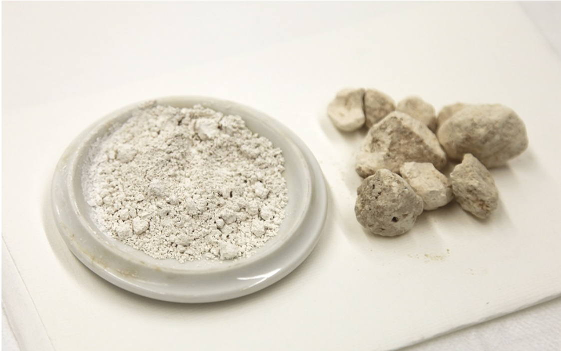
Figura 27: Carbonato de cal en polvo, purificado por levigación en el laboratorio del CAEM, y carbonato de cal en concreciones naturales. Fotografía: autor.
