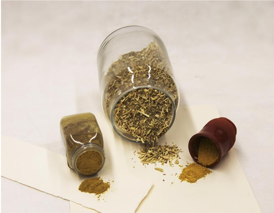
Figura 16: (a) Reseda Luteola seca y triturada, lista para la decocción. (b) Pigmento-laca de reseda precipitado con alumbre. (c) Pigmento-laca de reseda precipitado con carbonato de cal. Fotografía: autor.
