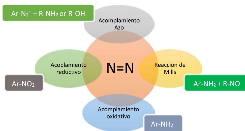
Figura 17: Las cuatro rutas sintéticas más utilizadas en la obtención de azobencenos
