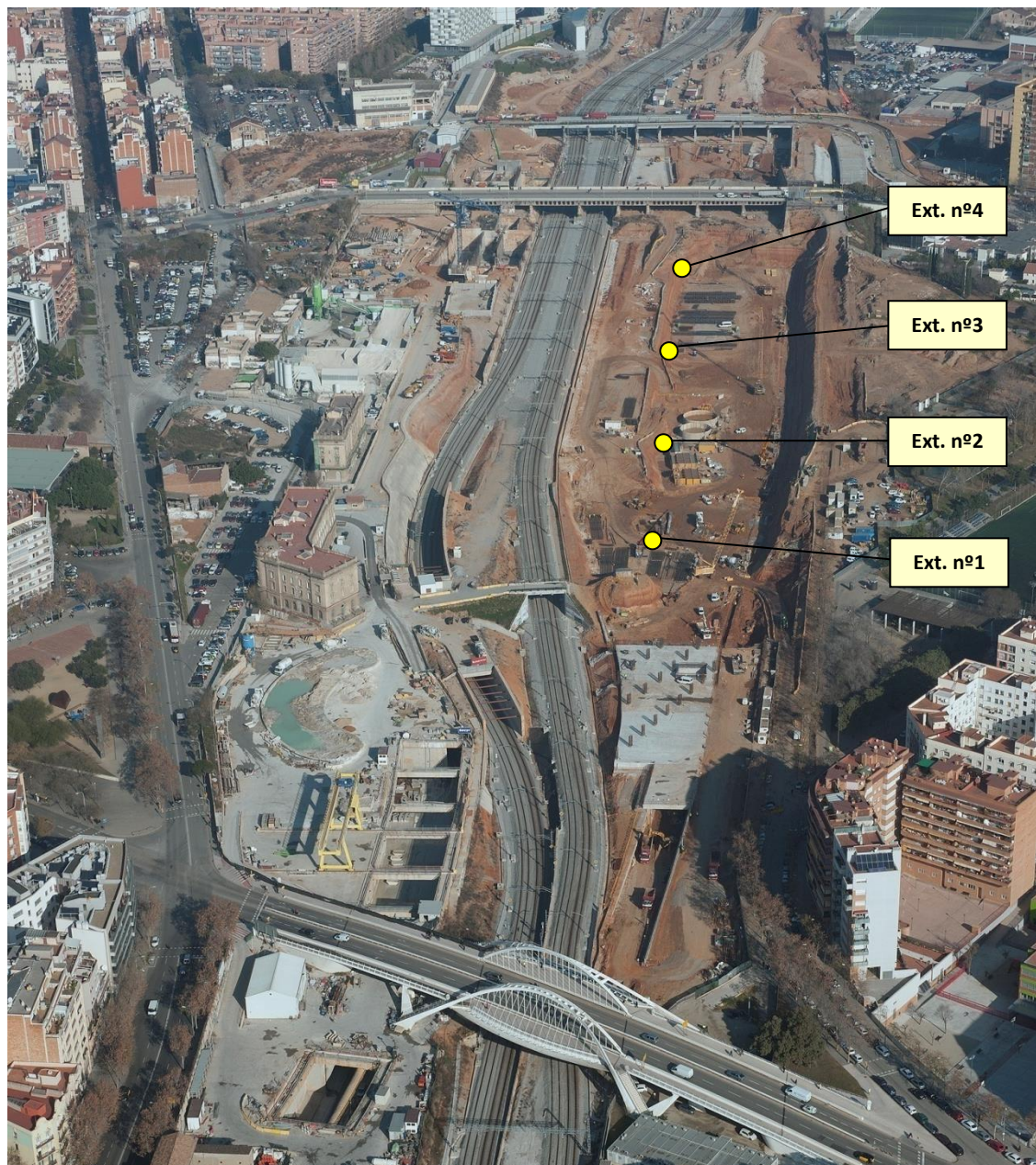
Figura 8.12. Fotografía aérea (Apunto Lapospo, 2011) con la situación de los extensómetros.
