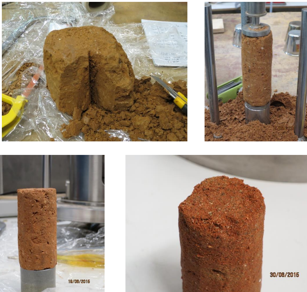
Figura 8.07. Arriba: Tallado de muestras cilíndricas. Abajo a la izquierda: muestra cilíndrica tallada de la muestra bloque extraída del estrato Pliocuatnario arcillosos-limoso.
