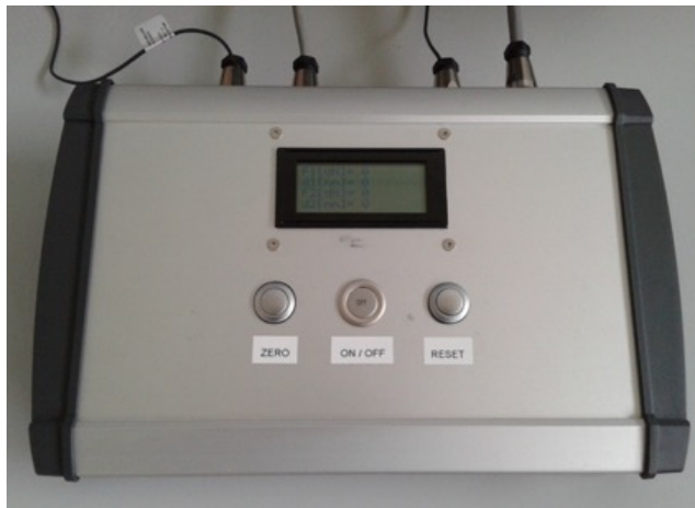
Fig. 31: Aparato electrónico para condicionamiento de la señales y procesamiento de datos
