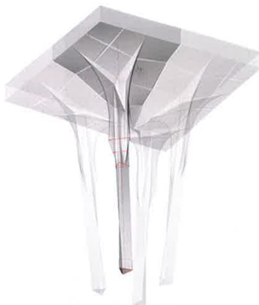
Imatge 7.78.- Tram central de les voltes de 30m. Variant a reconstruir R-081.
