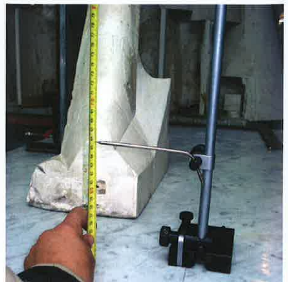
Imatge 6.9.- Exemple de presa d'una alçada amb rosset, allà on no és possible prendre-la directament a plom. Rosset fixat en el punt a mesurar (esquerra) i trasllat del punt fora de la peça per prendre la cota (dreta).
