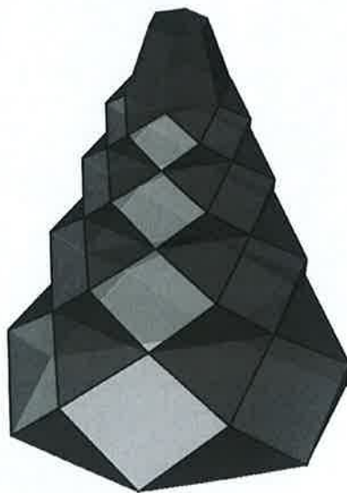
IX.- Construcció de paraboloides (en gris clar) i plans triangulars (gris fosc) Resultat final.
