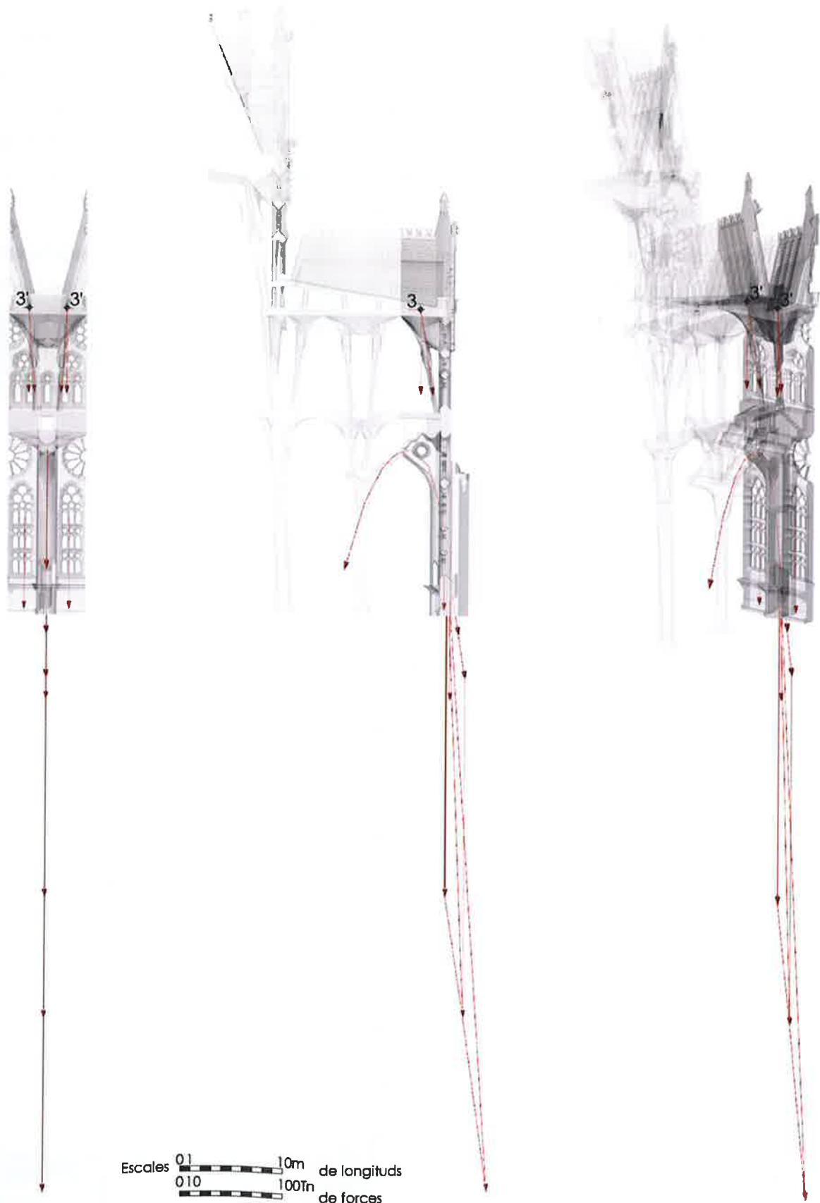
Imatge 11.24.- Càlcul del mòdul lateral exterior (façana).
