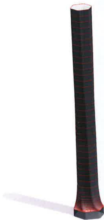
Imatge 7.4.- Columna construïda pel gir i escalat d'un polígon al llarg d'un eix.
