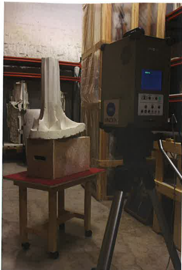
Imatge 6.24.- Procés d'escanejat del capitell de la nau central a cota +20m (R-018).
