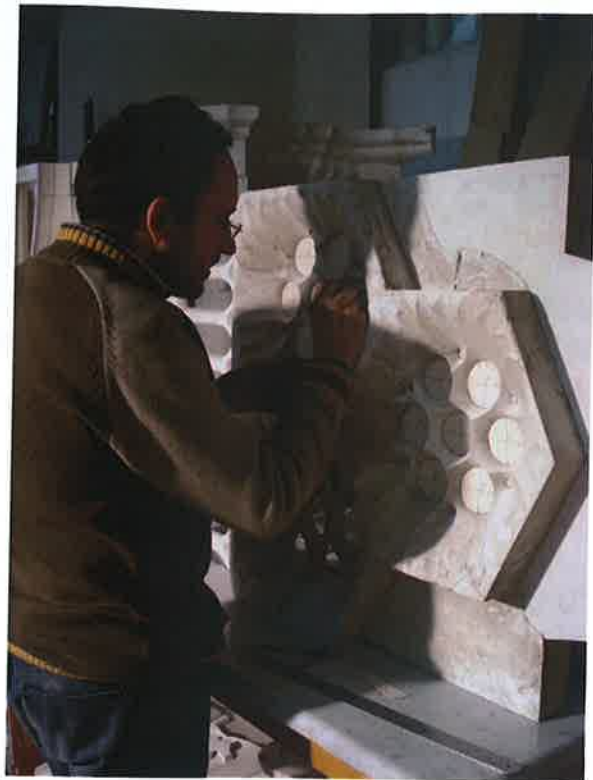
I + II.- Col·locació de cartolines dins dels òculs i anotació dels punts de pas de les generatrius dels hiperbolides que formen el dibuix estrellat.
