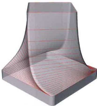
Imatge 7.16.- Base formada pel gir i escalat d'un polígon al llarg d'un eix.
