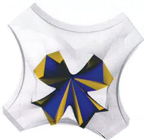
Imatge 7.59.- Capitell R-002. Superfícies de la cavitat central, que comparteixen un vèrtex comú situat en el centre de l'element.
