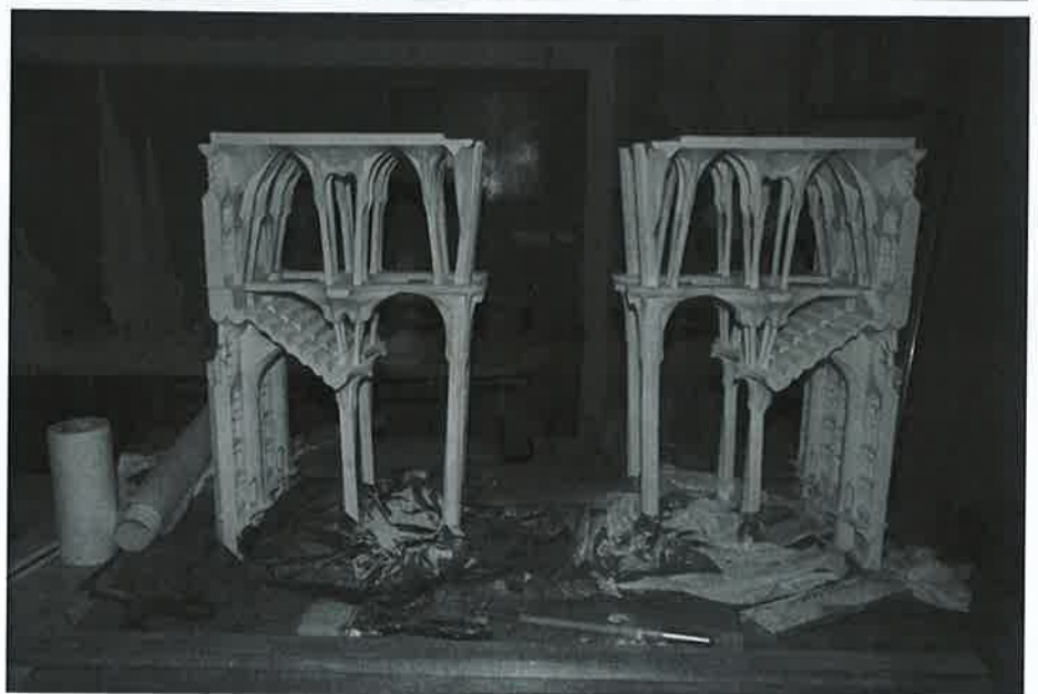
Imatge 6.46.- Maqueta en la fase de muntatge. Ajust i rejuntat de la meitat inferior.
