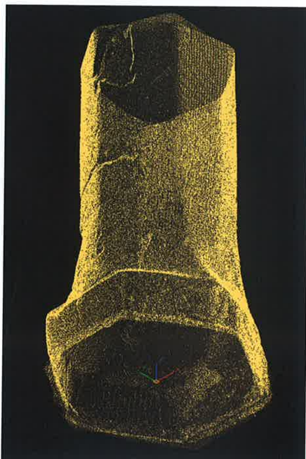
Imatge 6.26.- Núvol de punts de la columna de la nau central (R-012).
