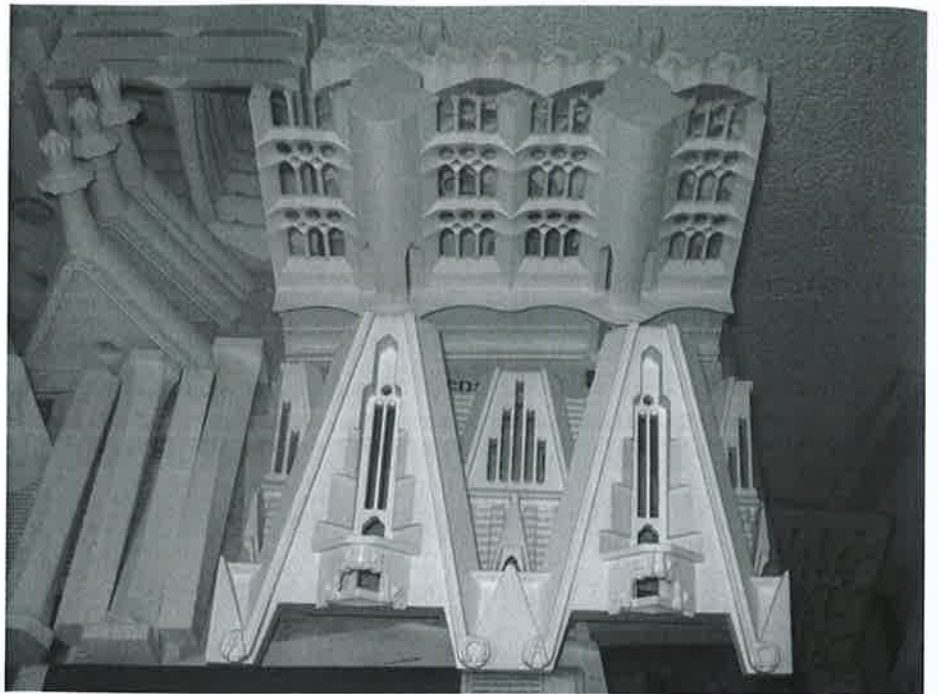
Imatge 6.44.- Peces assecant-se després del procés de consolidació.
