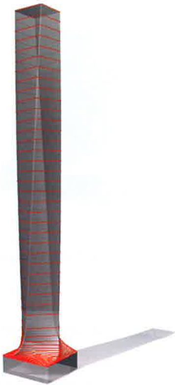
Imatge 7.10.- Columna construïda pel gir i escalat d'un polígon al llarg d'un eix.
