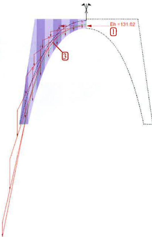
Imatge 10.14.- Cas anterior amb el mètode de Gaudí, que superposa la composició de vectors sobre l'arc.
