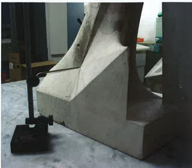
Imatge 6.9.- Exemple de presa d'una alçada amb rosset, allà on no és possible prendre-la directament a plom. Rosset fixat en el punt a mesurar (esquerra) i trasllat del punt fora de la peça per prendre la cota (dreta).
