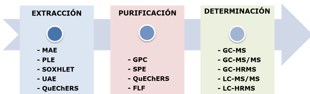
Figura 8. Etapas del proceso analítico y listado de técnicas analíticas más representativas de cada una de ellas.
