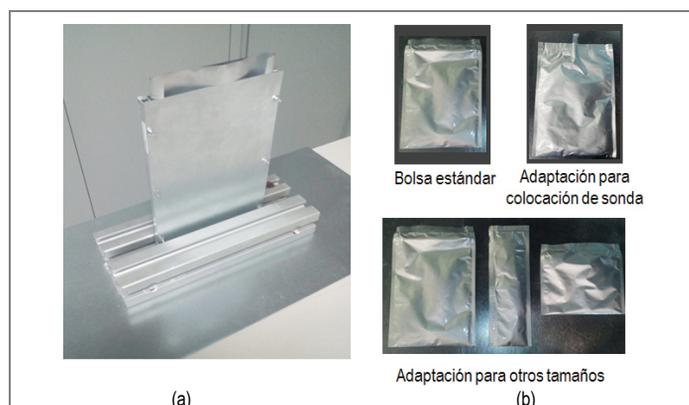
Fig. 4-6. Detalle bolsas de polietileno para o encapsulamiento PCM RT5HC (a) Molde para sistema de llenado manual. (b) Bolsa estándar de 160 x 260 mm y adaptaciones puntuales realizadas.
