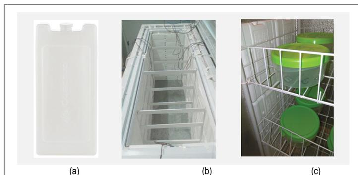
Fig. 4-7. Integración de PCM encapsulado marca blanca, en contacto con el evaporador de pared. (a) Detalle de PCM de bajo coste, encapsulado en envase PE-LD, (b) Integración de PCMs encapsulados dispuestos en las paredes interiores. (c) Detalle de producto almacenado en el refrigerador, junto al PCM integrado
