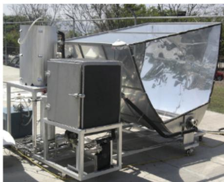
Fig. 1-12. Refrigerador intermitente basado en el ciclo de absorción
