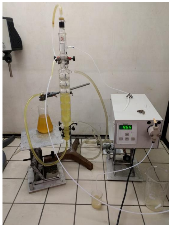
Esquema 33 Fotografía del montaje: Sistema de mezcla inicial en continuo (Izquierda); Columna de absorción de HCl en continuo (derecha).
