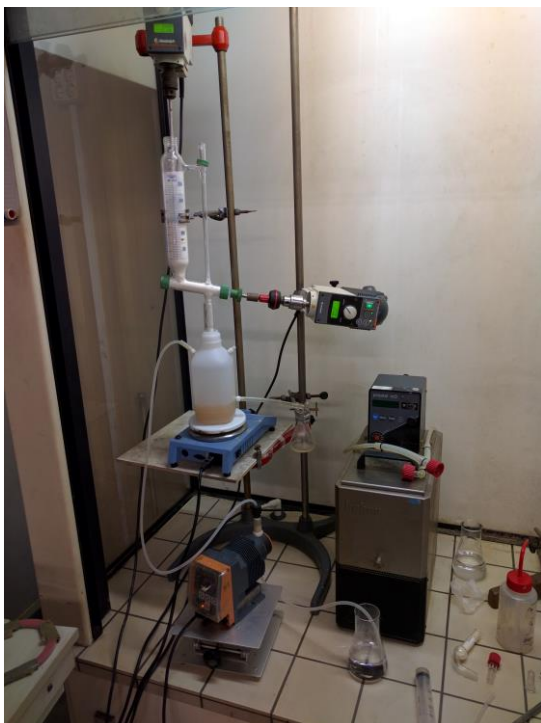
Esquema 33 Fotografía del montaje: Sistema de mezcla inicial en continuo (Izquierda); Columna de absorción de HCl en continuo (derecha).
