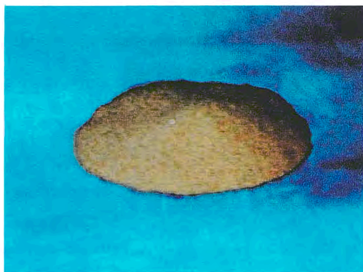
Figura 3.3.2. Fracción de tamaño 200-150 \mu\text{m} de magnesita calcinada a 650°C durante 10 horas.
