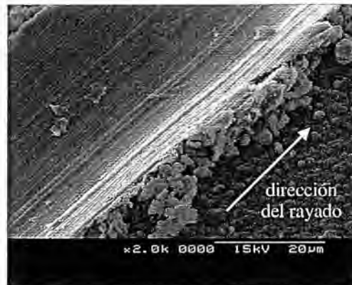
Figura 7.9: Morfología de la traza tras el paso de la punta de diamante, dejando una superficie lisa en el centro y apartando el material poco cohesionado hacia los lados.
