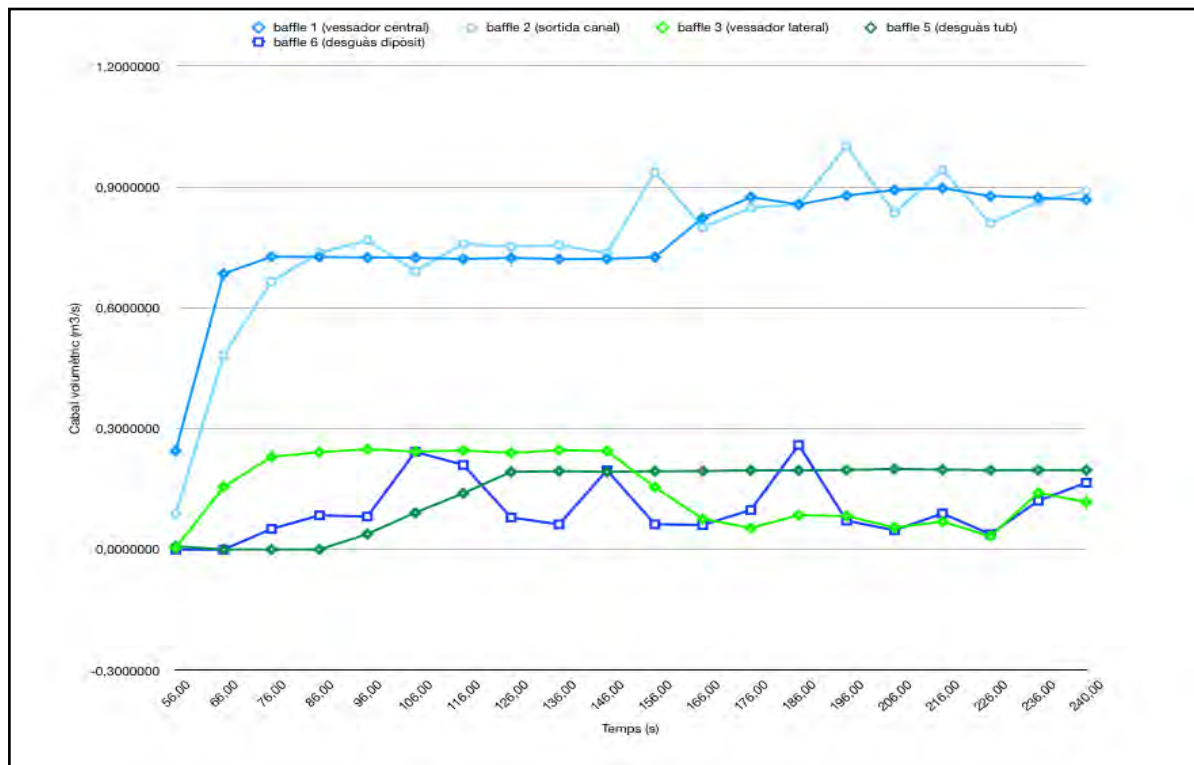
Figura 5.47. Comparació dels cabals volumètrics mesurats en els 5 baffles per un cabal d'entrada de 1000 litres/segon.
