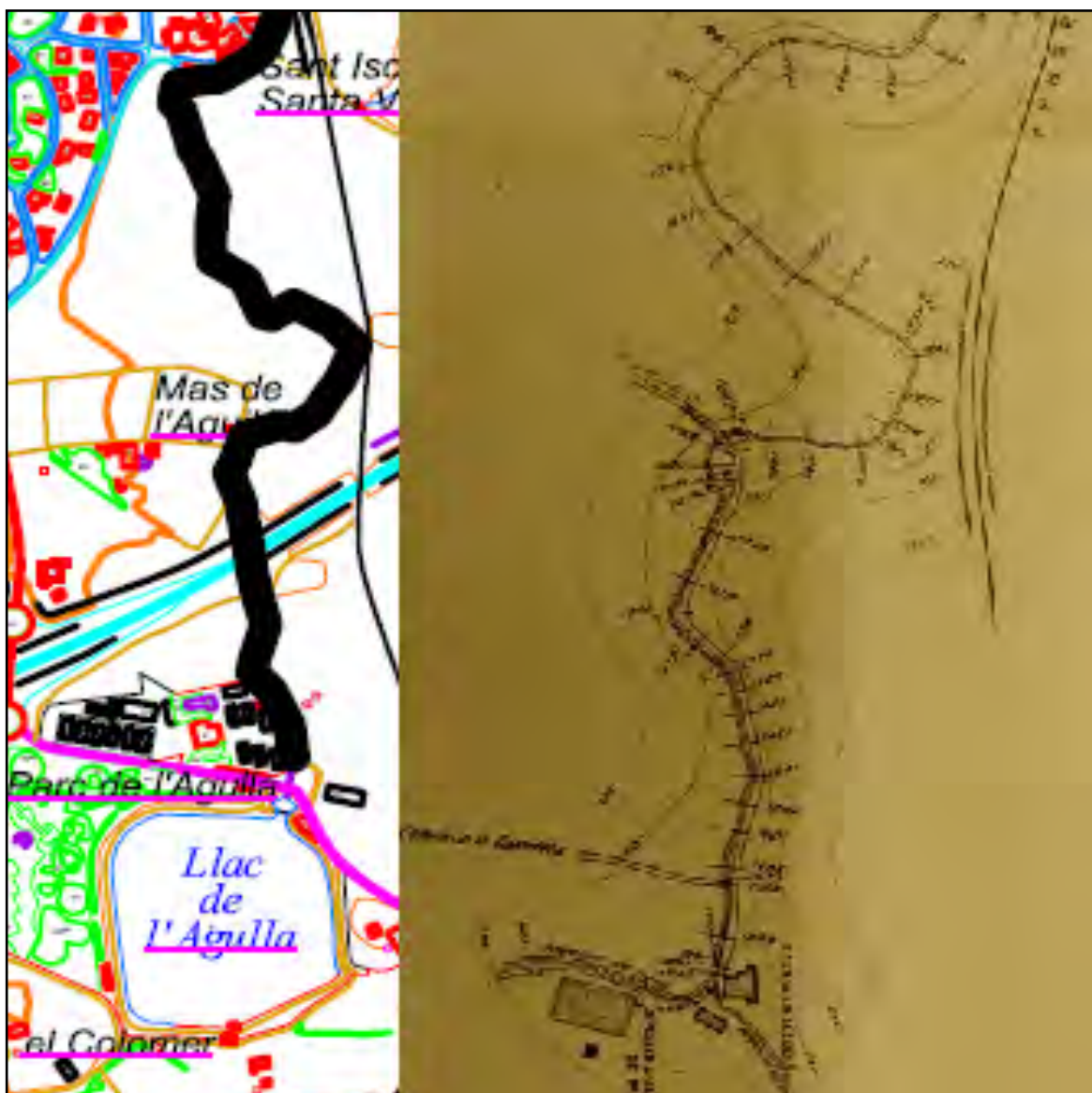
Figura 1.55. Comparació dels aixecaments topogràfics en l'entorn de l'Agulla fets els anys 2016 (esquerra) i 1956 (dreta). Es pot observar com a l'any 1956 encara no s'havia construït el llac artificial. Font: Per la imatge de l'esquerra (Casafont Trench & Fitó Pintado, 2016), per la imatge de la dreta, CDAHCF.
