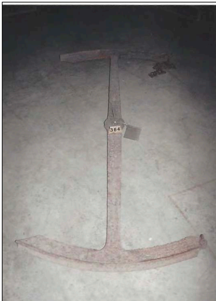
Figura 4.4. Balancí del mecanisme original de regulació del Mòdul Hidromètric a l'arribada al Museu de la Tècnica de Manresa. Font: Museu de la Tècnica de Manresa.
