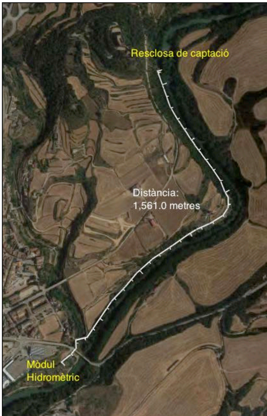
Figura 4.3. Imatge satèl·lit de l'emplaçament del Mòdul Hidromètric respecte la resclosa de captació, sota el Castell de Balsareny.
