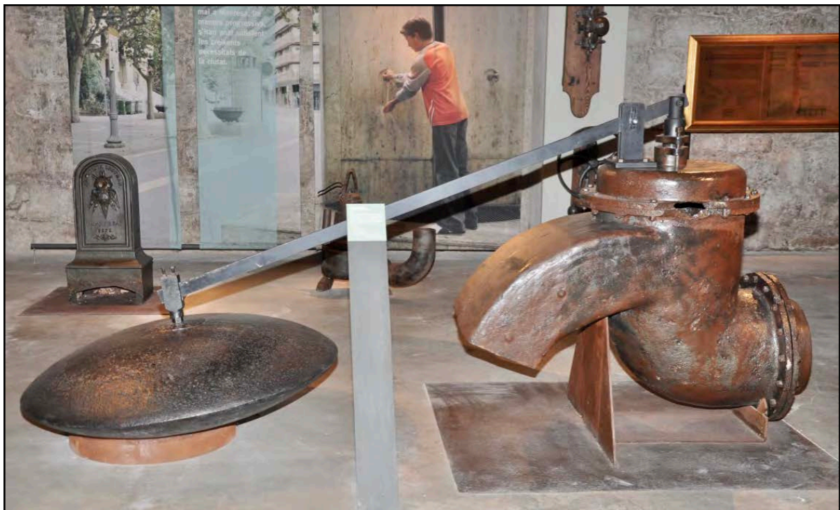
Figura 1.65. Vàlvula i boia reguladora procedent dels dipòsits vells. Forma part de l'exposició perma-
