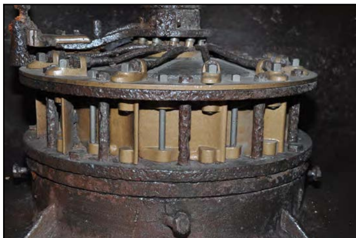
Figura 1.70. Detall de l'interior de la turbina Francis de la fàbrica Sanmartí. Es pot apreciar el mecanisme que acciona els àleps orientables del distribuïdor. Font: MTM.
