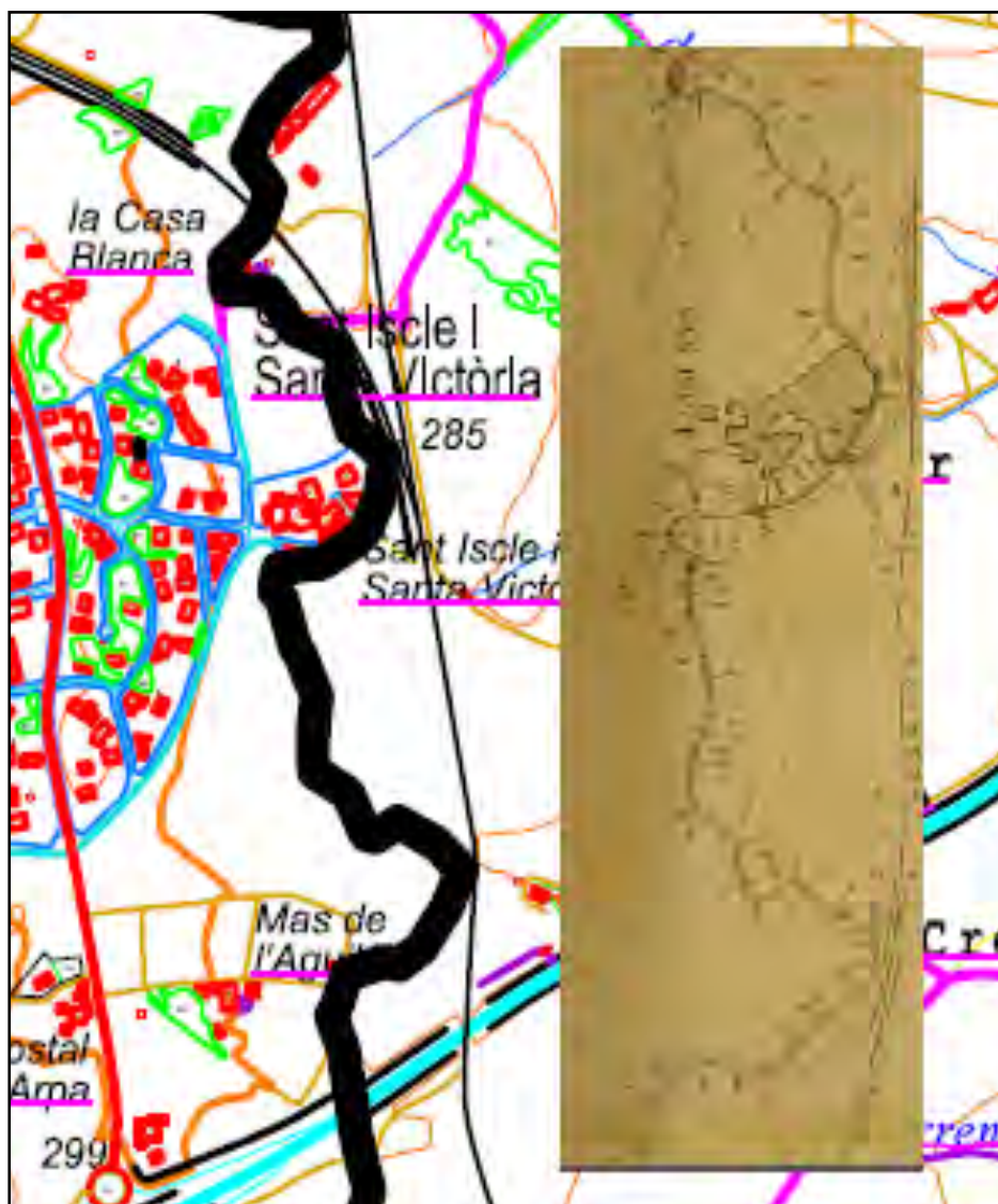
Figura 1.56. Comparació dels l'aixecaments topogràfics en l'entorn del Mas de Sant Iscle fets els anys 2016 (esquerra) i 1956 (dreta). Es pot observar identificar la invariabilitat de la traça. Font: Per la imatge de l'esquerra (Casafont Trench & Fitó Pintado, 2016), per la imatge de la dreta CDAHCF.
