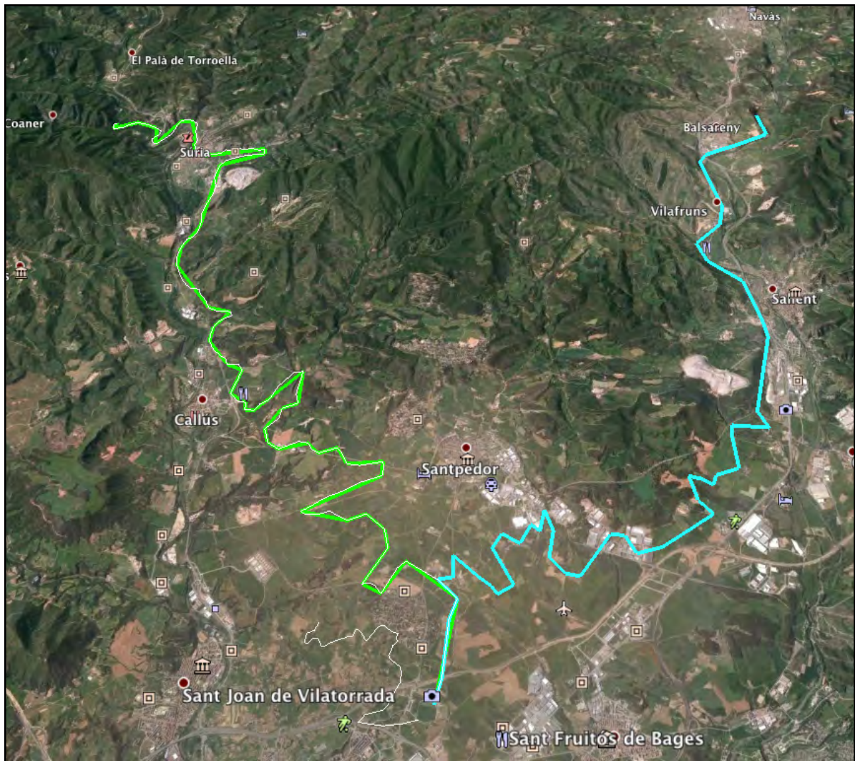
Figura 2.5. Vista comparativa del traçat alternatiu prenent l'aigua del riu Cardener (en color verd) respecte el traçat de la Sèquia de Manresa (en color blau) que la pren del Llobregat. Elaboració pròpia mitjançant Garmin Basecamp 4.6.2. i visualització en Google Earth 7.1.5.1557.
