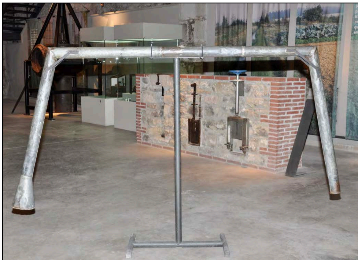
Figura 1.75. Trompa d'aigua de mostra permanent sobre la Sèquia del Museu de la Tècnica de Manresa. Aquest sifó, un cop encebada, servia per extreure aigua del canal sense haver de perpetrar cap intervenció sobre les seves parets o fons. Font: MTM.
