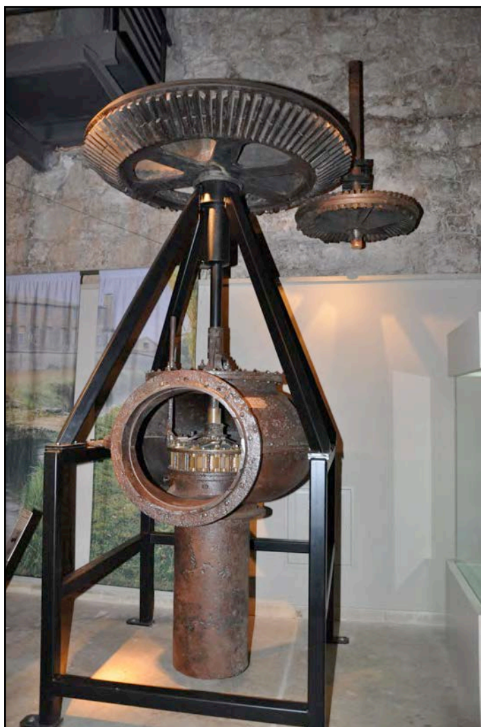
Figura 1.71. Turbina Francis procedent de la fàbrica Sanmartí, construïda a Ohlo (EUA) l'any 1875. Font: MTM.
