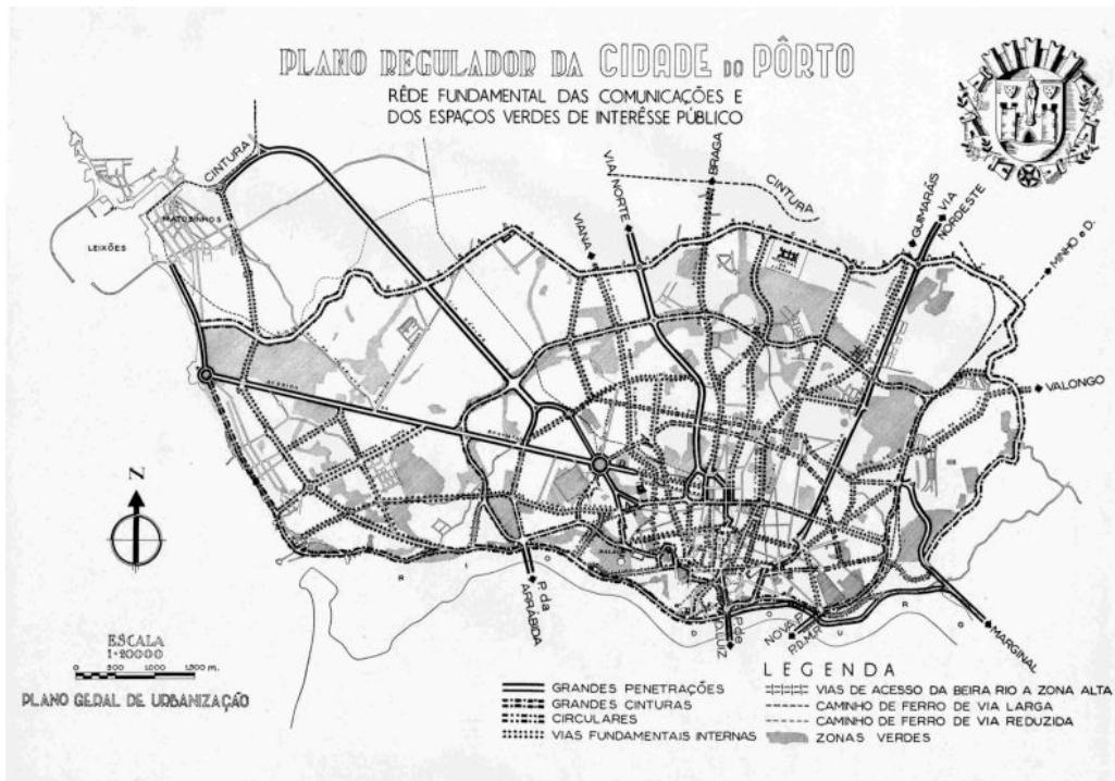
FIG. 4.22: Propuesta de vías en la ciudad de Oporto: “Plano geral de urbanização” (1947-1952) que revela la importancia de las puentes que conectan las dos ciudades, Oporto y Gaia, para la estructura de la red viaria fundamental. Realizado por el ingeniero Antão de Almeida Garrett. [Fuente: http://www.cm-porto.pt/os_planos_do_porto/plano-regulador-da-cidade-do-porto-1947-1952 , visitado el 3 de mayo de 2018]
