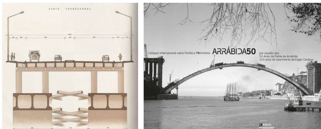
FIG. 4.21: Ponte de Arrábida, corte del proyecto original (izquierda) y en proceso de construcción (derecha).
