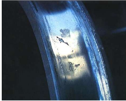
Figura 2.3: Roda amb fissures a la seva banda de rodolament. [80]
