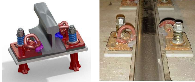
Figura 4.7: Detall sistema de fixació tipus DFF (esquerra) i muntat en via (dreta). [83]
