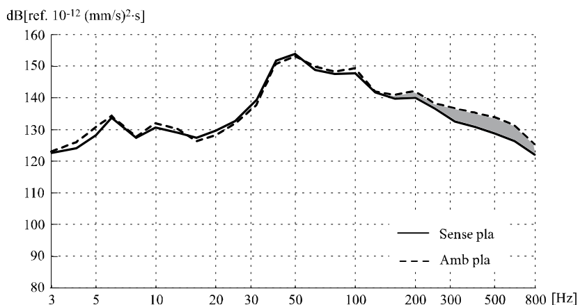
Figura 2.11: Espectre freqüencial del senyal de vibració vertical del carril al pas d'un tren que no té cap pla en les seves rodes i el d'un tren que té algun pla en alguna de les seves rodes. [6]
