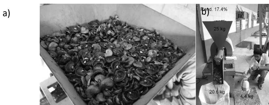
Figura 8. Proceso de prensado para la obtención de CNSL: a) Cáscara de la semilla de marañón en la tolva del molino y b) molino de extracción de CNSL ubicado en las instalaciones de APRAINORES.
