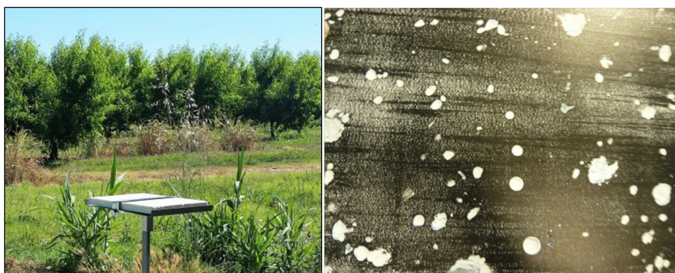
Figura 2.4: Imatge esquerra) Granímetre que forma part de la xarxa controlada per l'Associació de Defensa Vegetal Terres de Ponent. Imatge dreta) Preparació d'una placa per analitzar-la. Font: ADV Terres de Ponent.
