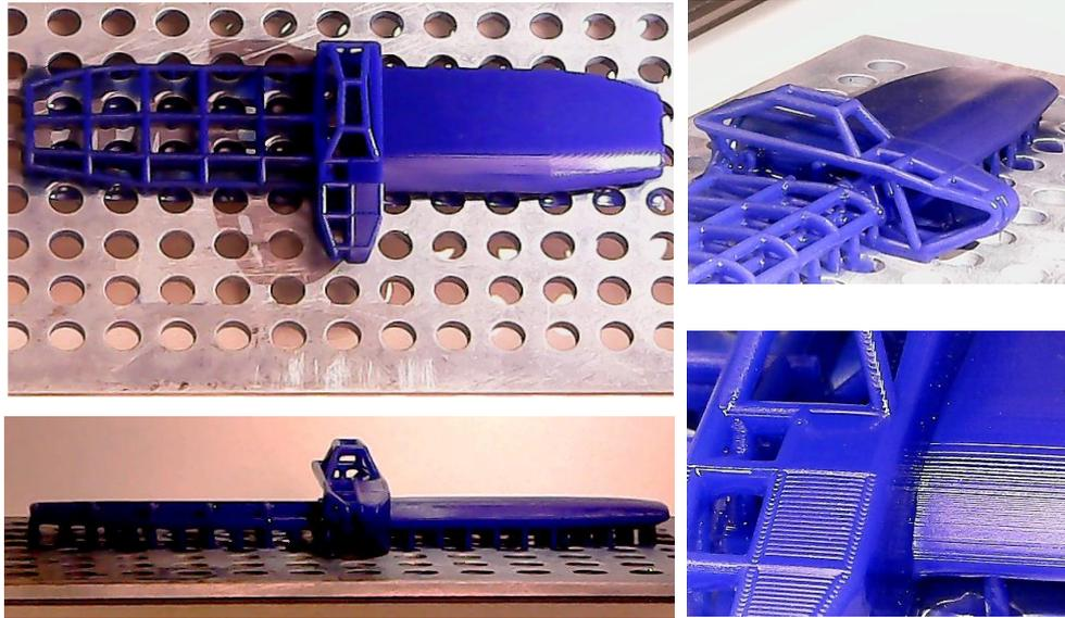
**Figura 413:** Imágenes de parte del avión de juguete impreso con resina sin carga aun sobre la plataforma de construcción y sin aporte de material por el sistema Inkjet (prueba inicial) [Fuente: elaboración propia].
