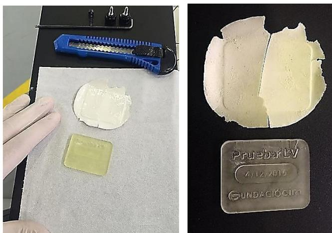
**Figura 376:** Primeras pruebas llevadas a cabo con el sistema de impresión DLP haciendo uso de formulaciones basadas en alúmina (Presentación de scattering)
