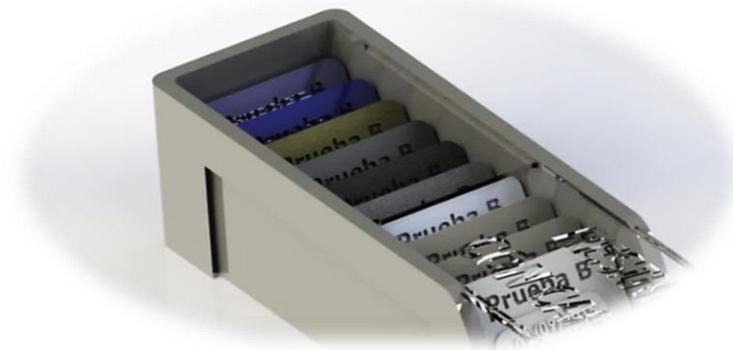
**Figura 326:** Representación renderizada de probetas impresas con distintas barbotinas cargadas tanto de partículas cerámicas como metálicas pudiendo también ser fibras
