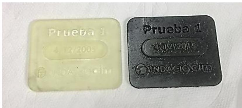
**Figura 327:** Piezas de prueba impresas con resina Spot-LV, sin partículas ferromagnéticas y dotada de partículas ferromagnéticas respectivamente [Fuente: Elaboración propia].
