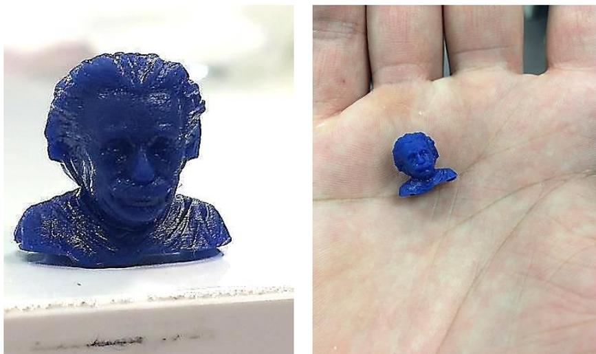
**Figura 390:** Pieza de Impresa a través del sistema DLP del equipo Nhibrid32D haciendo uso de la resina Spot-HT [Fuente: elaboración propia].
