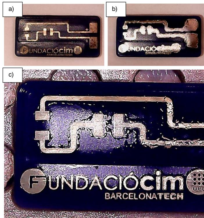
**Figura 407:** Impresión del demostrador anterior en el equipo Nhibrid32D mediante el uso de tinta de plata ANP silverjet DGP HRA y resina Spot-HT. a) Reproducción monocapa del circuito. b) Reproducción bicapa sobre el sustrato de resina sin secar con bordes ligeramente curvados. c) Reproducción monocapa sobre el sustrato de resina previamente secado y expuesto a luz ultravioleta [Fuente: elaboración propia].
