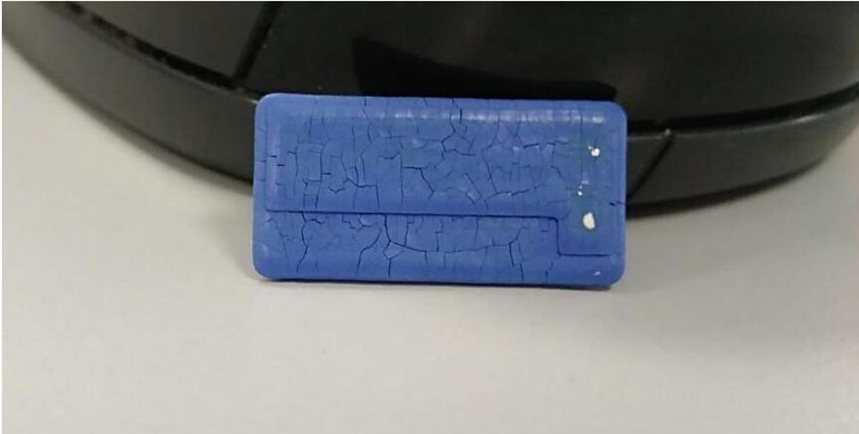
**Figura 411:** Demostrador impreso tras el proceso de sinterización (aparición de fisuras y absorción del circuito mono-capa de plata) [Fuente: elaboración propia].
