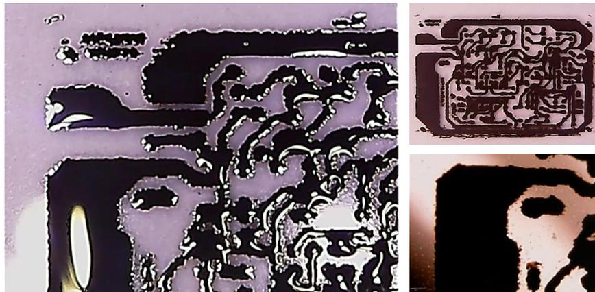
**Figura 364:** Reproducción bicapa sin curado intermedio del circuito de prueba con drop spacing en X,Y de 40 y 25  $\mu\text{m}$  respectivamente, imágenes de los depósitos húmedos [Fuente: elaboración propia].
