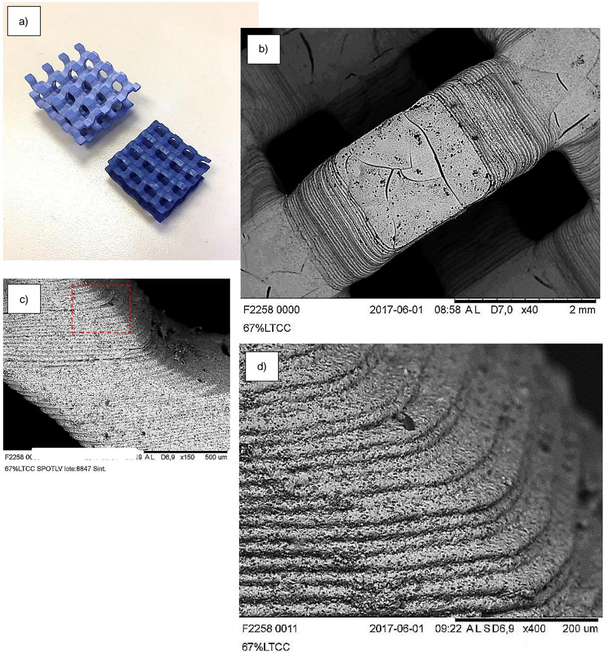
**Figura 398:** Estructura Lattice impresa antes y después del ciclo térmico de sinterización (a). Vista en planta al SEM de la pieza tras la sinterización reproducido en condiciones de  $25/4 \mu\text{m/s}$  (b). Vista lateral en detalle de la superposición de las capas en las columnas de la estructura tras la sinterización (c, d) [Fuente: elaboración propia].
