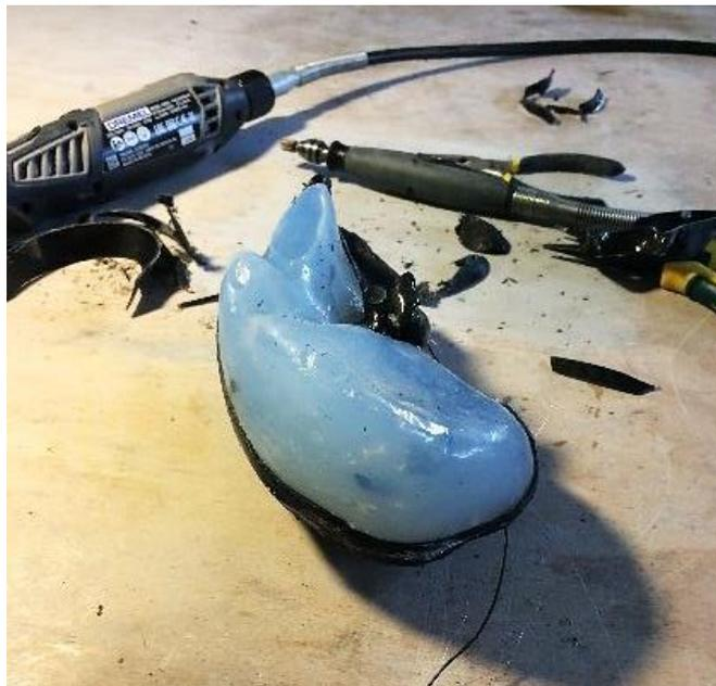
**Figura 436:** Imagen de la extracción del modelo hepático tras la destrucción del molde que lo contiene [Fuente: elaboración propia].
