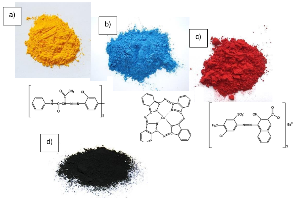
Figura 97: Imagen de los pigmentos empolvo empleados en la fabricación de tintas CMYK y de su estructura química. Pigmento Amarillo PY12 (a), pigmento cian PB15 (b), pigmento PR48:1 empleado en el color magenta (c) y finalmente negro de carbón en polvo (d) [166].
