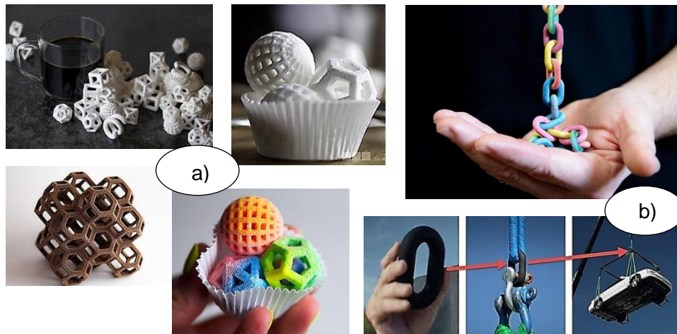
Figura 81: Piezas impresas comestibles usando chocolate o azúcar en polvo como material base (a) [132]. Cadena multicolor impresa mediante la tecnología MFJ utilizando polvo de poliamida como material base y bajo la adición de un aglutinante de mayor poder de unión y en una concentración mayor, imagen de un eslabón similar monocromático impreso capaz soportar el peso de un automóvil (b) [133].
