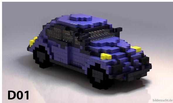
Figura 78: Reproducción digital de baja resolución del automóvil anterior mediante distintos vóxeles monomateriales dispuestos convenientemente, en los que se resalta las propiedades ópticas de éstos (opacidad, coloración y traslucidez) [124].
