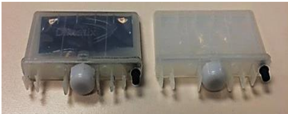
Figura 155: Módulos de almacenamiento del cartucho Dimatix DMC-11610 cargado de tinta de plata ANP y sin tinta, en vacío [Fuente: Elaboración propia].
