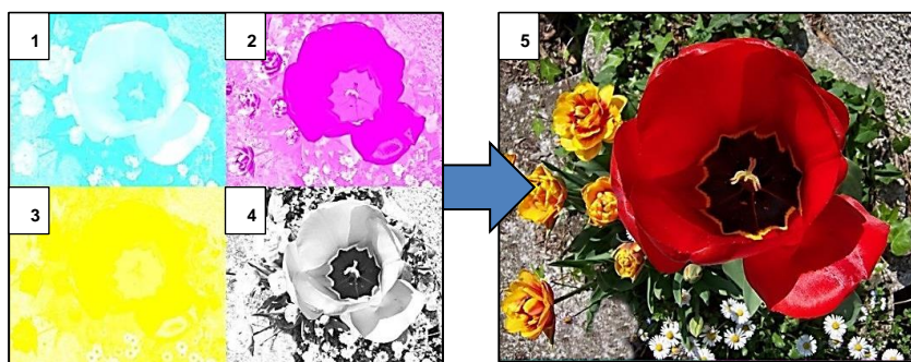
Figura 62: Representación de una imagen a color mediante la superposición de 4 capas de color; Cian, Magenta, Amarillo, Negro (CMYK) [Fuente: elaboración propia].
