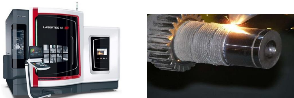
Figura 16: Centro de mecanizado capaz de combinar la fabricación aditiva por láser cladding con la fabricación sustractiva de la casa DMG-MORI (a). Imagen de la reparación de un eje mediante la adición de material por Laser cladding (a) [31].
