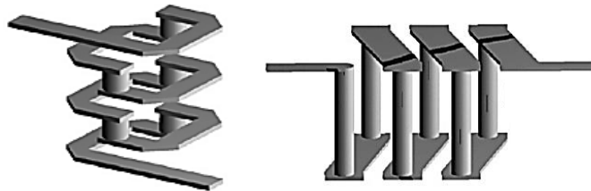
Figura 82: Representación de una bobina vertical y horizontal reproducida mediante la tecnología thick film multicapa en donde el elemento conductor ha sido reproducido bidimensionalmente por un sistema Inkjet sobre un sustrato plano
