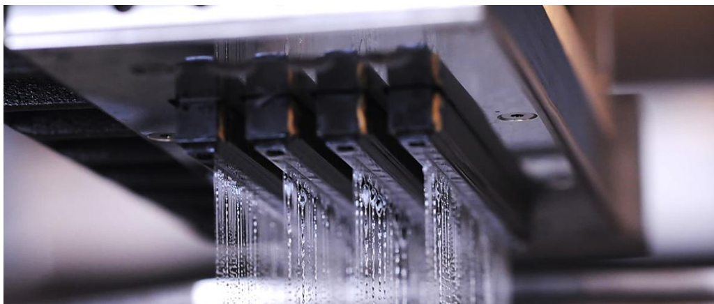
Figura 111: Vista real de cuatro cabezales Inkjet CIJ dispuestos en paralelo con nozzles dispuestos en línea eyectando aglutinante para un sistema de impresión tridimensional por tecnología 3DP o de Binder Jetting (BJ) de la compañía ExOne [213].
