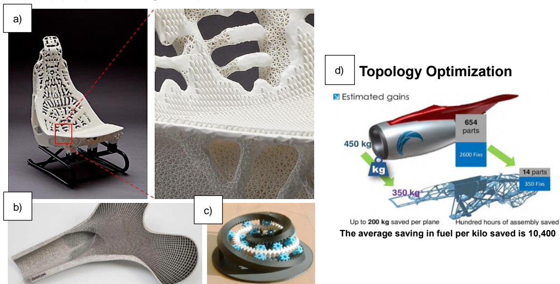
Figura 33: a) Asiento de un coche fabricado aditivamente por la empresa Toyota [64], b) prototipo de un estructura lattice diseñada por Betatype y fabricada aditivamente por el Imperial College de Londres en un equipo Renishaw [65], c) Engranajes impresos con una geometría inusual [66] y d) Ejemplo de cómo, la optimización topológica en combinación
