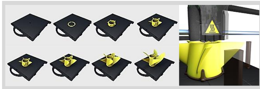
Figura 15: Evolución del proceso de fabricación de la hélice de la Figura 11 mediante la tecnología de FDM [26], [29].
