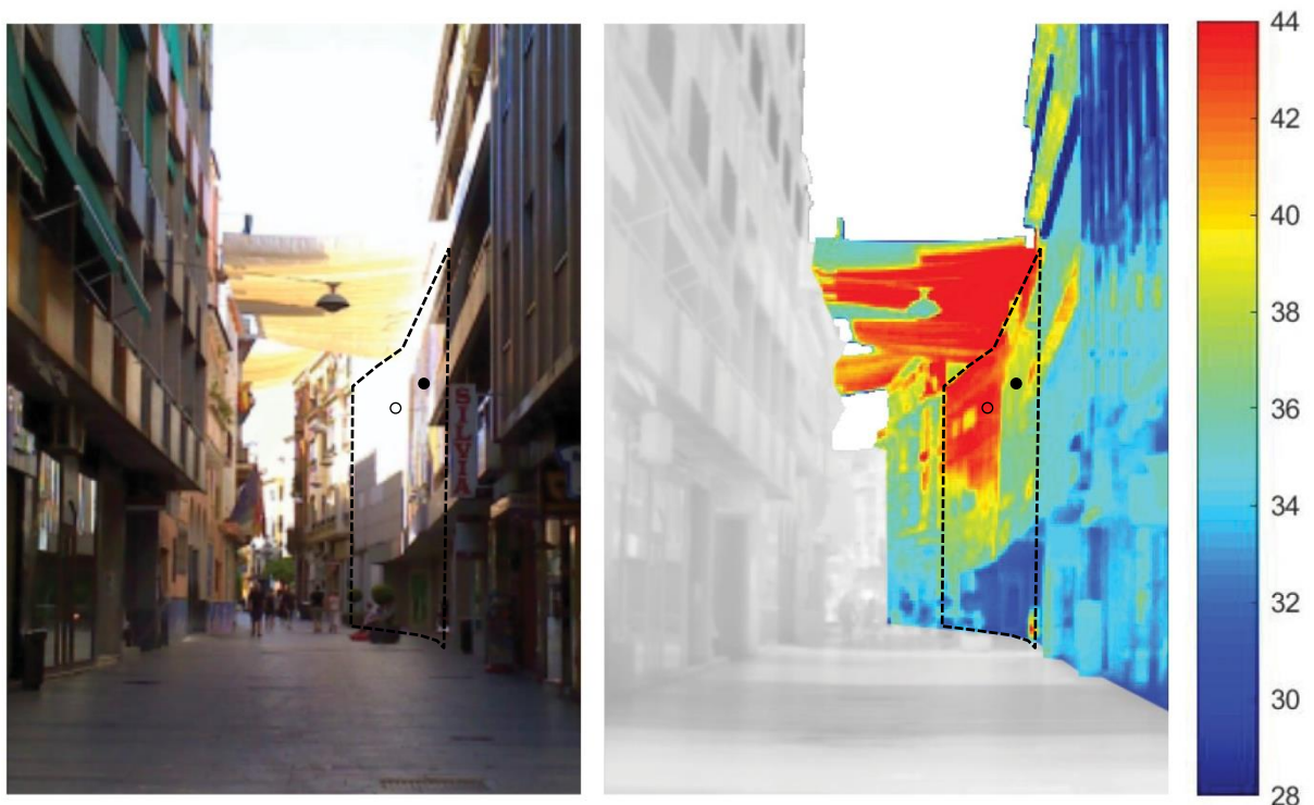
Figura 5. 34. Fotografía y termografía de la fachada Oeste y del toldo de la escena urbana EO2 a las 15:00h, indicando el edificio y los puntos de análisis.
