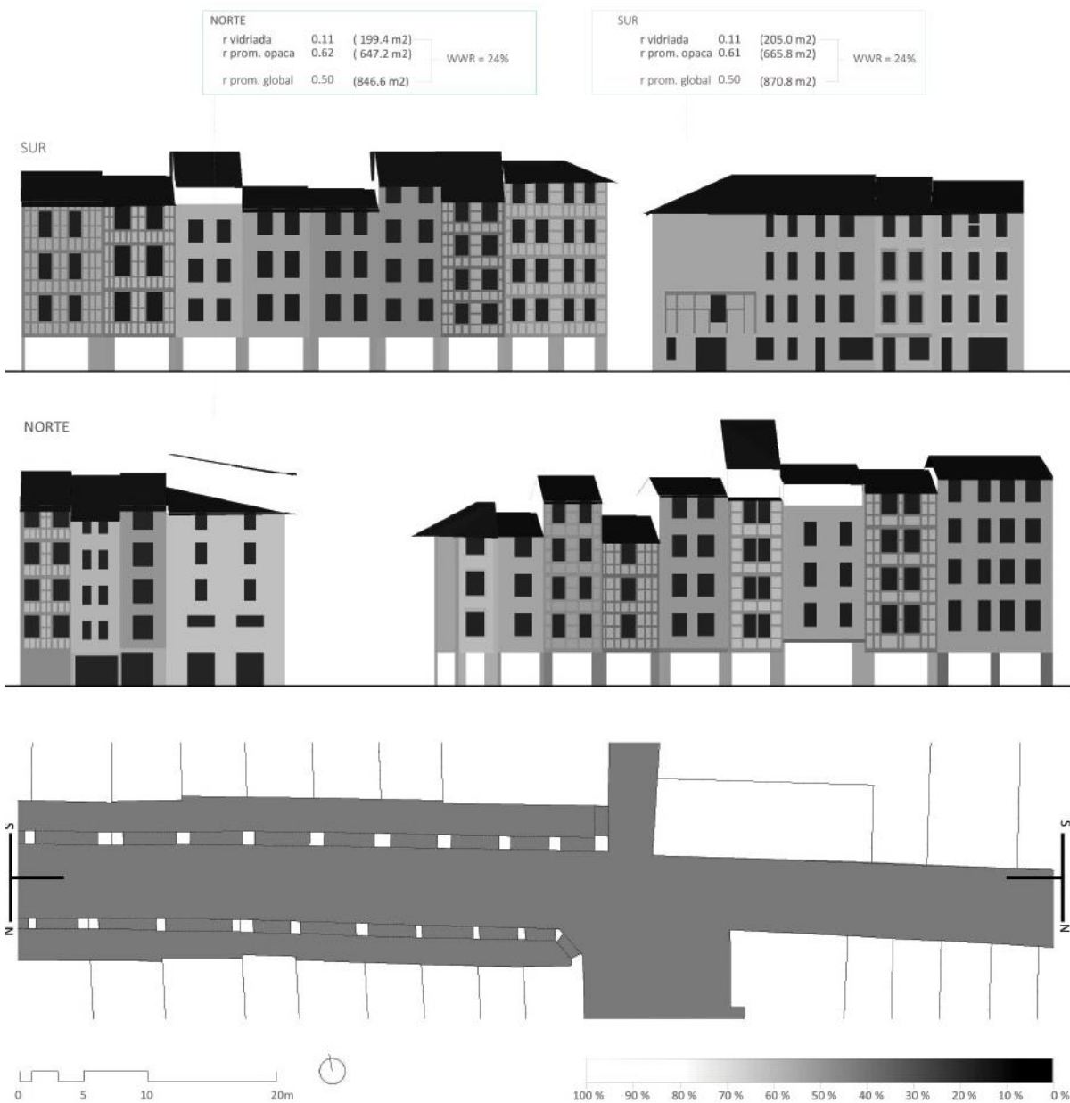
Figura 4. 11. Alzados y planta con los coeficientes de reflexión asignados al modelo 3D de la Rue des Tonneliers.
