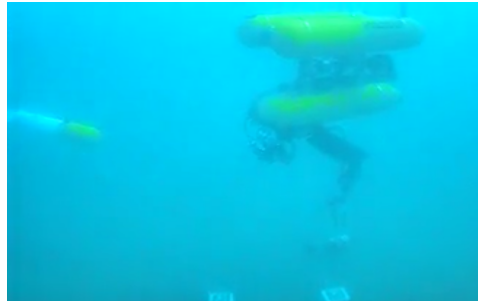
Figura 6.14: Experimentos en el mar. El AUV GIRONA500 dispone del ARM5E acoplado y cámara estéreo. El AUV SPARUSII se utiliza como apoyo.
