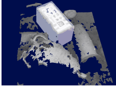
Figura 4.8: Visualización con UWSim de la estimación de la geometría de una maqueta de caja negra. Modelo (blanco) sobre la nube de puntos.
