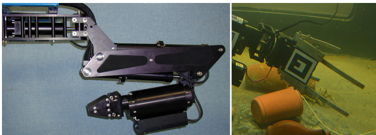
Figura 2.7: Brazo robótico eléctrico ARM5E con 4 GDL (izquierda). Efector final (derecha).
