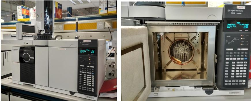
**Figura 4** Izquierda: Cromatógrafo de gases y espectrómetro de masas utilizados en los análisis de las muestras de nicotina (Laboratorio ASPB). Derecha: detalle del espectrómetro de masas (Laboratorio ASPB).
