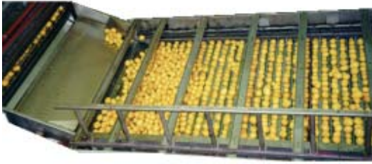
Imágenes 1.12 y 1.13. Sistema de raspado de la piel del Limón en cama de agua. JBT
