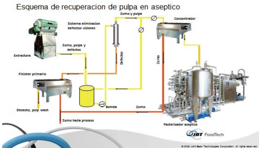
Figura 1.21. Esquema de Recuperación de Pulpa Cítrica. Cortesía de JBT Corporation
