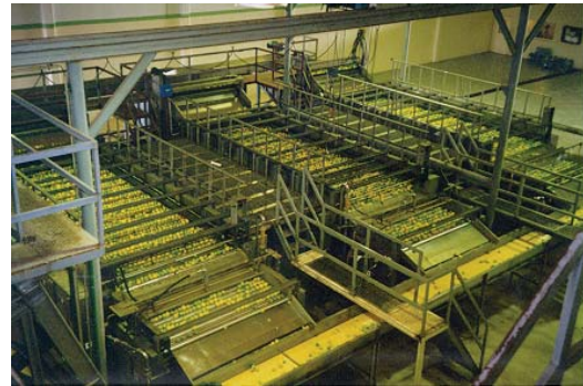
Imágenes 1.12 y 1.13. Sistema de raspado de la piel del Limón en cama de agua. JBT
