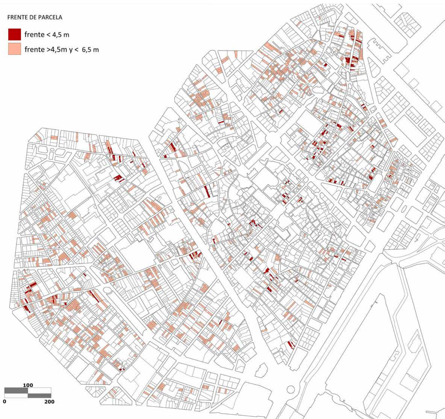
5.78. Parcelas con frentes inferiores a 6,5 m. La normativa general determina como 6,50 el frente mínimo para edificación unifamiliar y de 4,50 m como mínimo para edificaciones de dos plantas (PB + 1). La puesta en conformidad según esta normativa es difícil de cumplir, sin embargo ponerla de relieve demuestra que es representativa y que persiste en las zonas de alta tensión urbanística. Fuente: elaboración propia.
