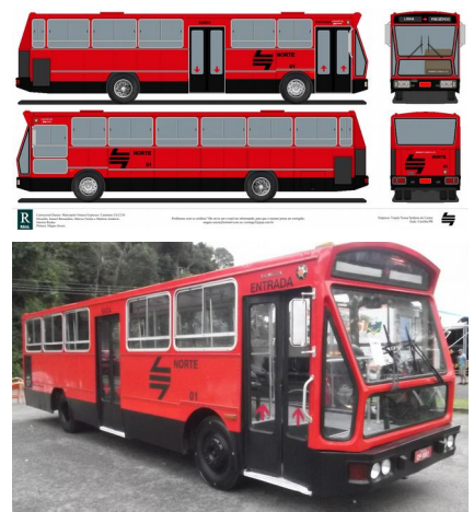
Figuras A5.44 y A5.45 - El primer autobús expés de Curitiba de los años setenta (Marcopolo Veneza Expresso – Cummins UCE 210).
