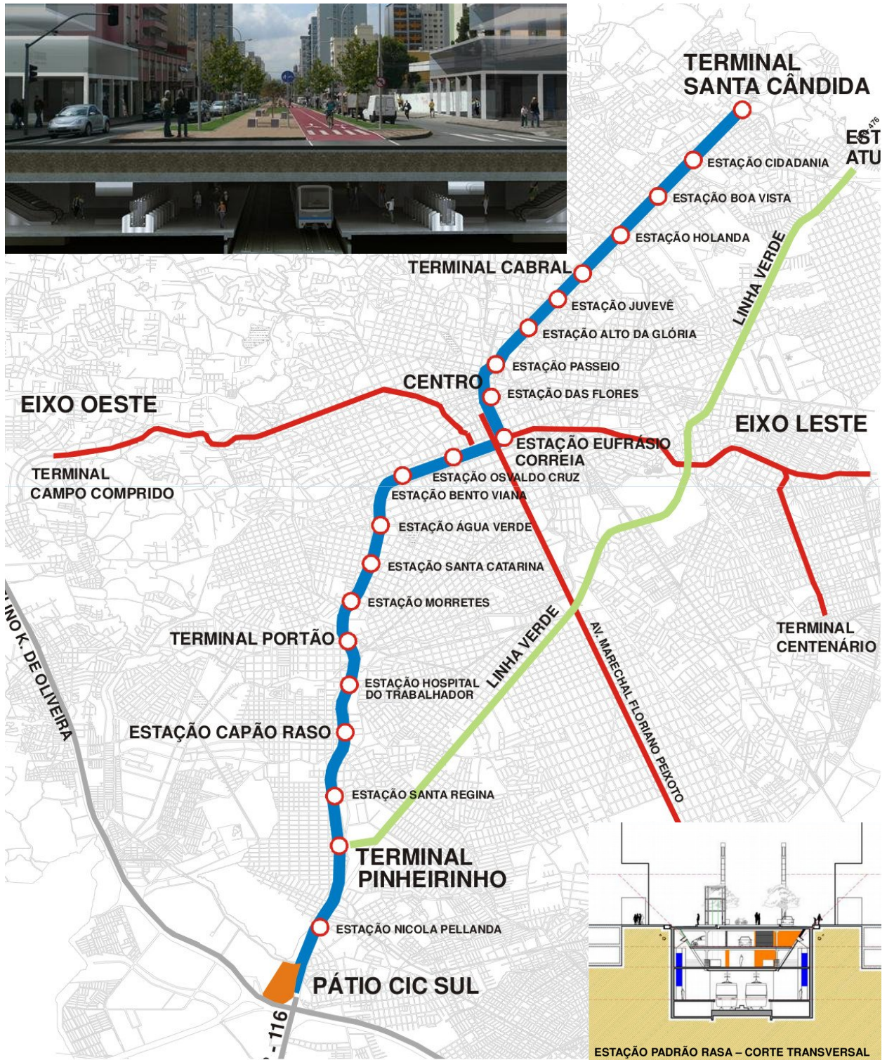
Figuras 1.37, 1.38 y 1.39 - Plano del metro de Curitiba y de la línea verde, perspectiva que refleja la integración con el paseo peatonal y el carril bici (arriba) y sección transversal (abajo). Fuente: PMC, 2012.
