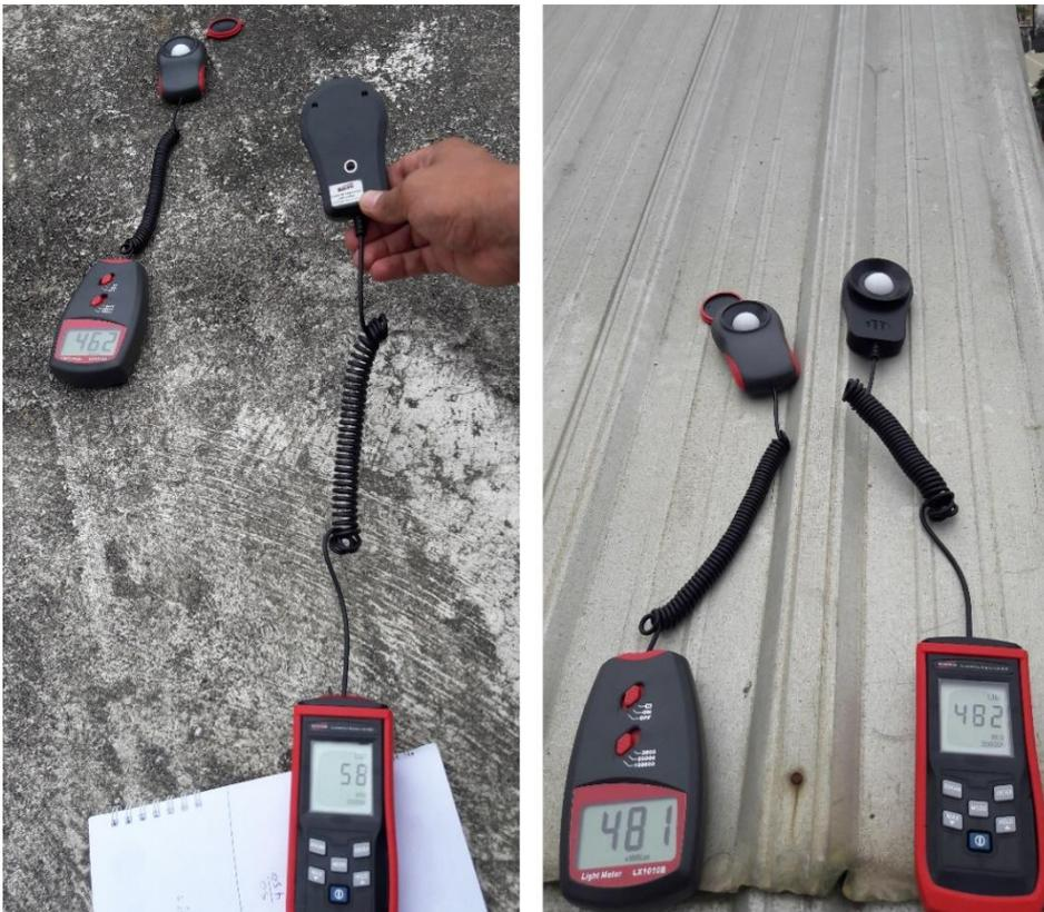
**Figura 123** Proceso de medición del factor de reflectividad a través de la medición de iluminancias. CP: superficie de hormigón (izquierda), y CL: superficie lámina de acero (derecha)
