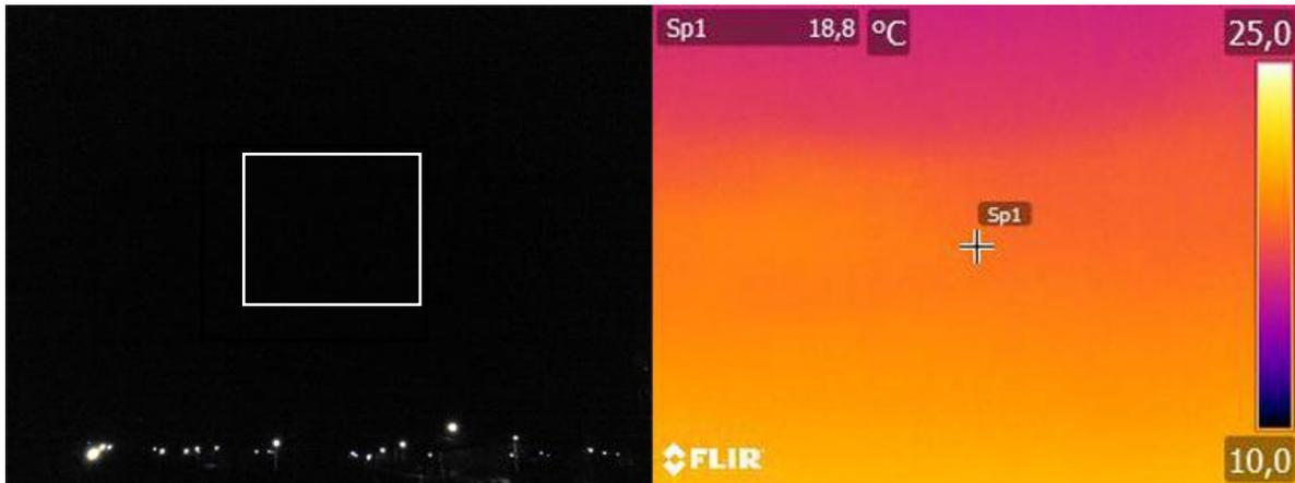
Figura 105 Medición temperatura radiante del cielo a través de la cámara térmica, en el periodo nocturno.
