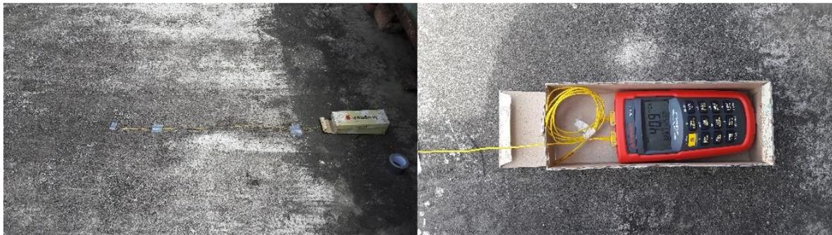
**Figura 129** Medición de la temperatura superficial exterior ( $T_s$ ) e interior ( $T_{si}$ ) de la CP.
