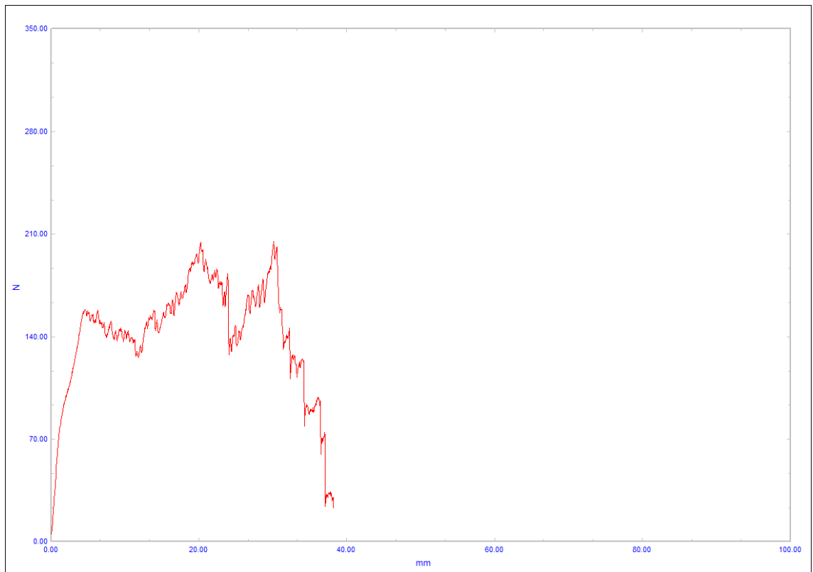
_____ radi 16 prova de càrrega fins la fallada (“load to failure”) bicortical
