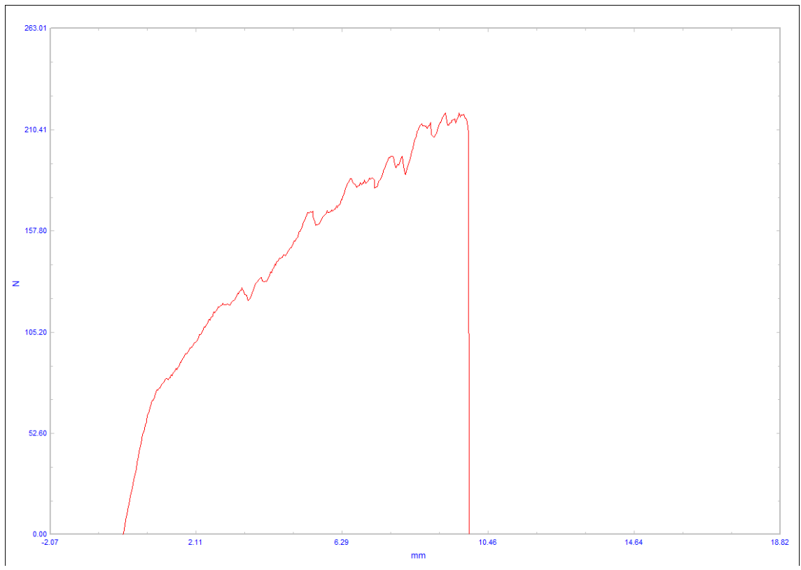
radi 11 prova de càrrega fins la fallada ("load to failure") bicortical
