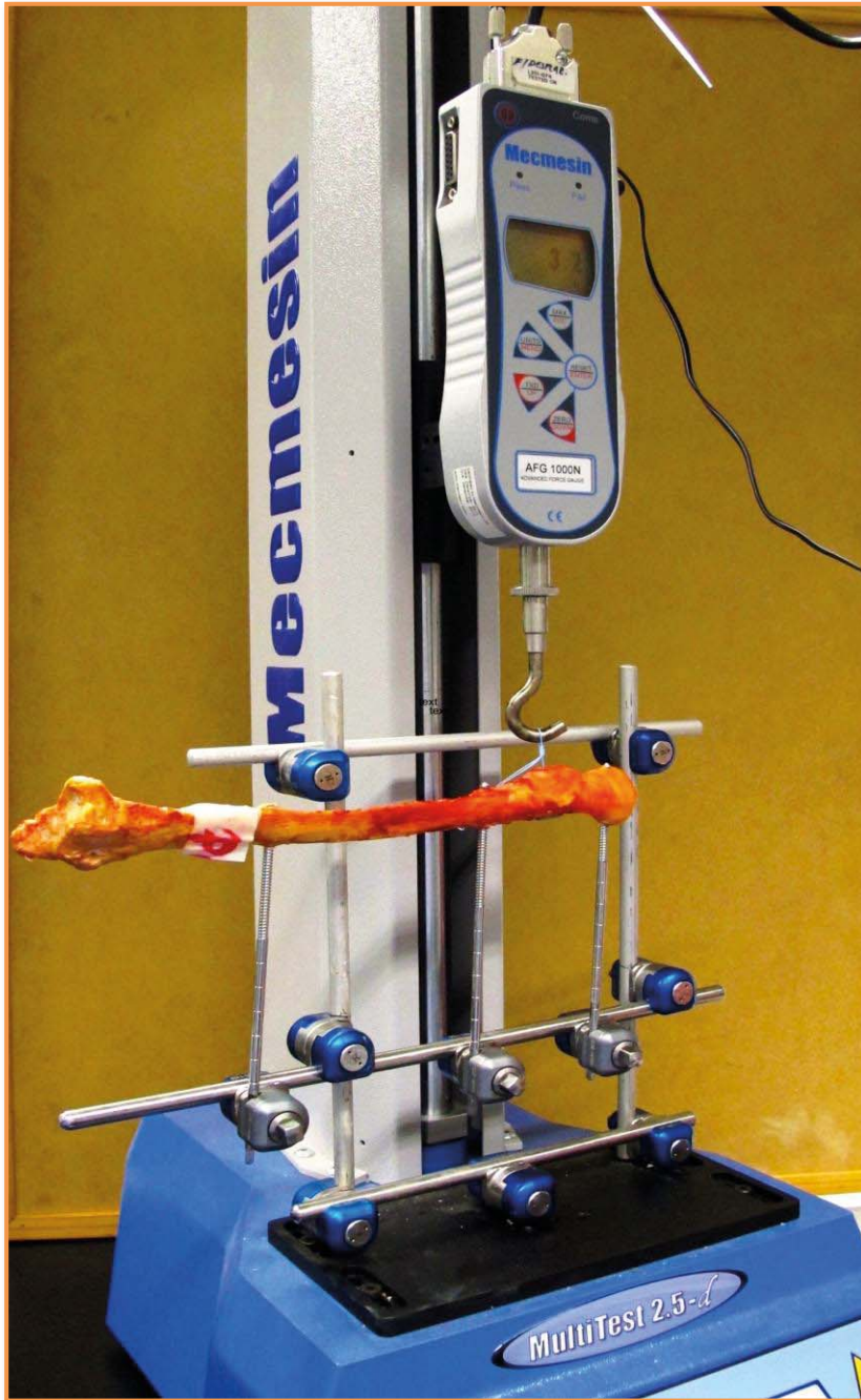
Figura 21. Dinamòmetre electrònic amb el suport Multitest 2.5-d (Mecmesin Corp, Slinfold, West Sussex, Gran Bretanya) i la peça anatòmica preparada per el test.
