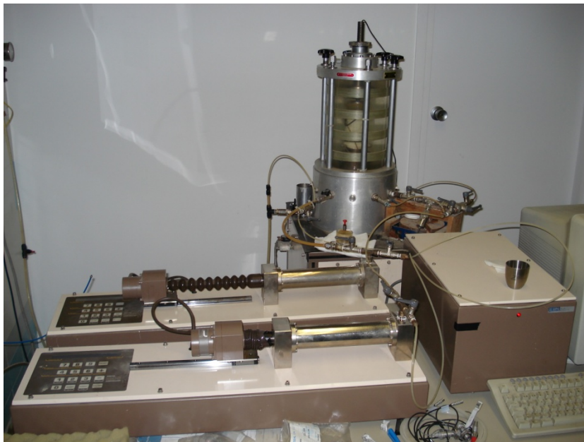
Figura 4.6 Equipo triaxial convencional GDS. Laboratorio de Ingeniería del Terreno, UPC
