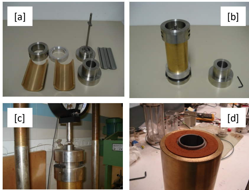
Figura 3.33 Elaboración de la muestra cilíndrica. [a] Elementos del molde de compactación; [b] Molde de compactación; [c] Compactación de la muestra; [d] Extracción de la muestra compactada.
