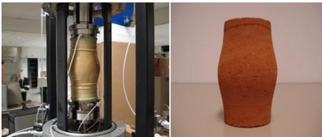
Figura 5.46 Muestra de ensayo no saturado para b = 0.5 .
