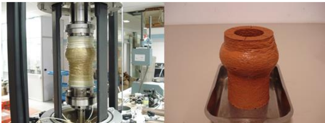
Figura 5.24 Muestra del ensayo saturado para b = 0.0 Compresión triaxial (TC)
