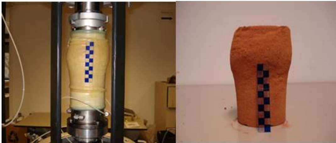
Figura 5.45 Muestra de ensayo no saturado para b=0.0 compresión triaxial (TC).
