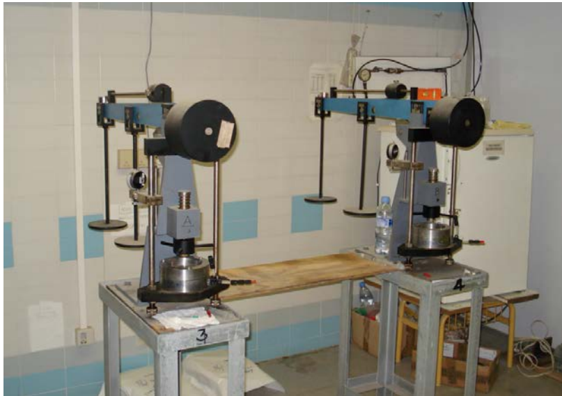
Figura 4.13 Edómetro tipo Bishop para ensayos edométricos.
