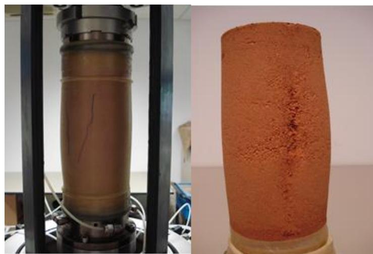
Figura 5.27 Muestra del ensayo saturado para b=1.0 Extensión (TE)
