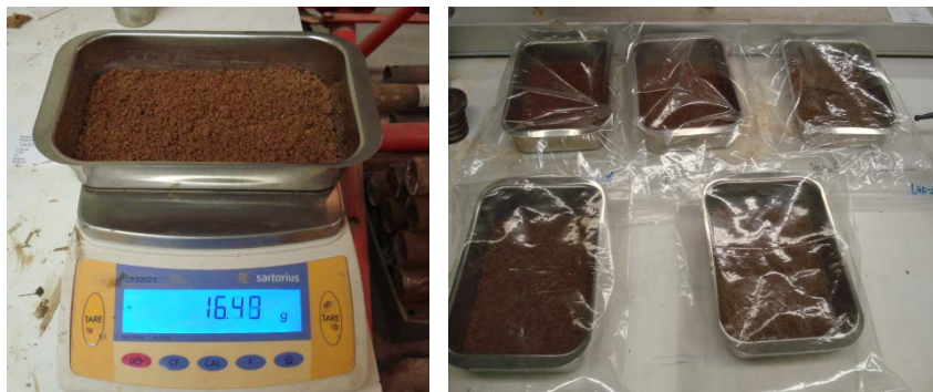
Figura 4.7 Elaboración de la muestras para ensayos de permeabilidad.
