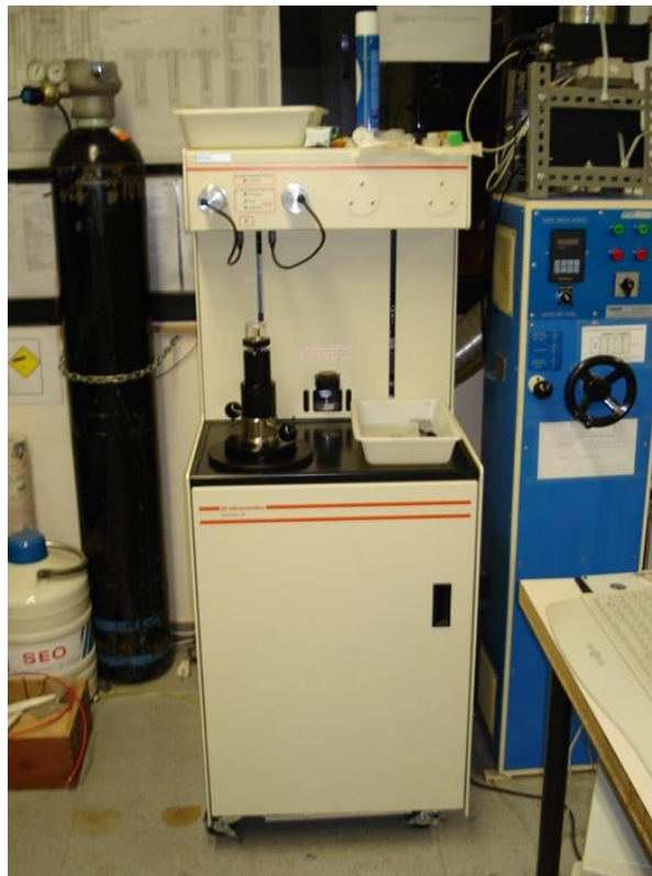
Figura 4.26 Porosímetro de intrusión de mercurio (MIP). Departamento de Ingeniería del Terreno, UPC
