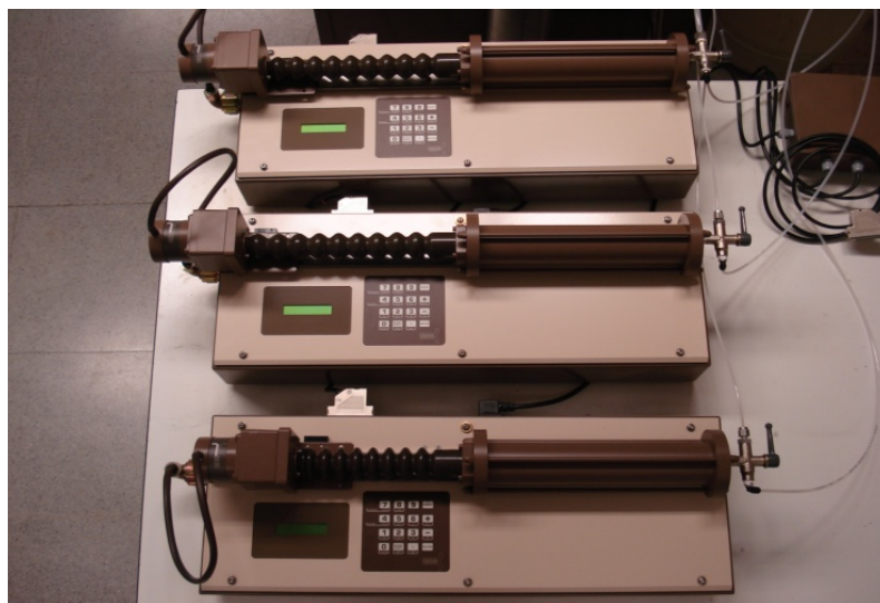
Figura 3.10 Equipos de control digital presión-volumen GDS.
