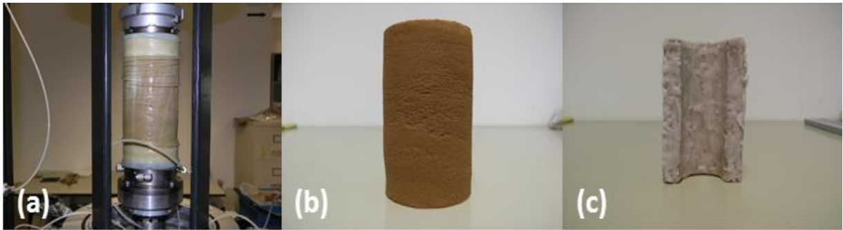
Figura 5.85 Muestras en el ensayo de colapso para b = 0.0 . (a) muestra montada en el cilindro hueco. (b) muestra desmontada del cilindro y retiradas las membranas de látex. (c) muestra cubierta con cera para la obtención de la deformación volumétrica.
